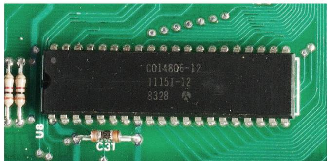
**Fig. 5 - Atary SALLY, una CPU derivata dal MOS 6502B** (foto di Multicherry/ Wikimedia Commons/ CC-SA-BY 4.0)
