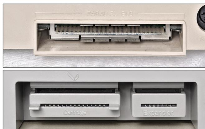
**Fig. 9 - la porta PBI (in alto) di un computer XL ed il vano che contiene le porte per le cartucce ed il connettore ECI (sotto) su un computer XE (foto di Multicherry/ Wikimedia Commons/ PD)**
