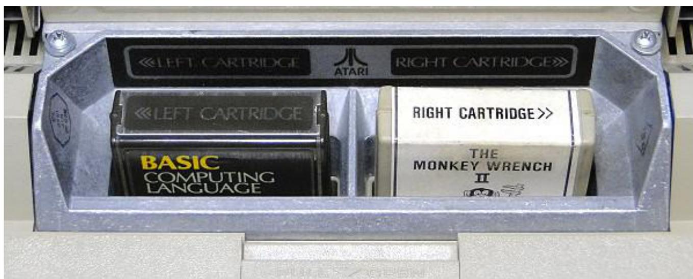
**Fig. 13 - La cartuccia dell'Atari BASIC inserita in un 800 con, nello slot destro, la cartuccia del "The Monkey Wrench II", un software che introduce nuovi comandi in aggiunta a quelli del BASIC standard (foto di Knurrikowski/ Wikimedia Commons / CC-SA-BY-4.0)**
