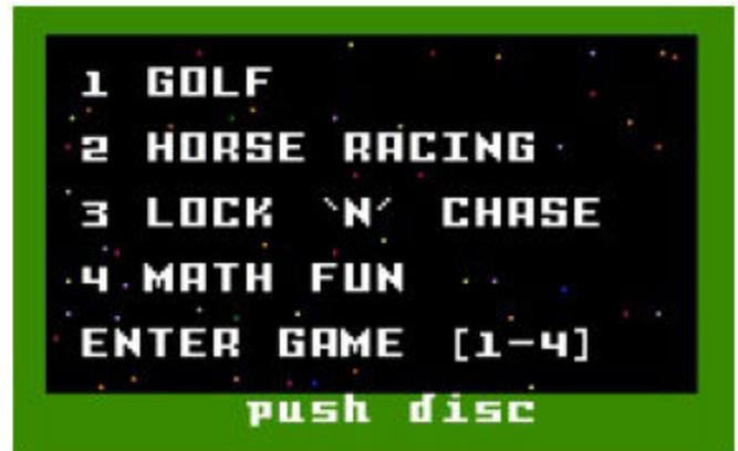
Una volta selezionato il gioco da scaricare, l'adattatore sintonizzava il ricevitore sul canale che trasmetteva il titolo scelto e attendeva l'inizio del flusso di dati del gioco. I dati ricevuti venivano trasferiti nella RAM ed alla fine del trasferimento il gioco veniva eseguito automaticamente.
