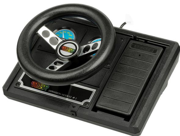
**Fig. 5 - L'Expansion Module #2**
