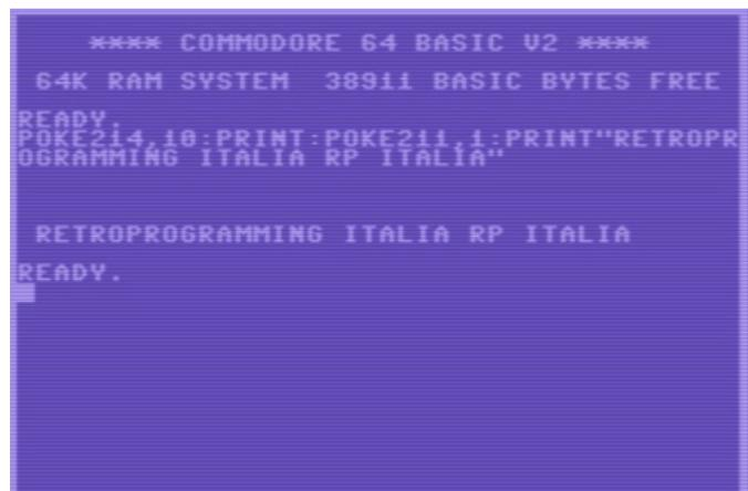
Fig. 1 - Esempio di PRINT AT simulato con PLOT
