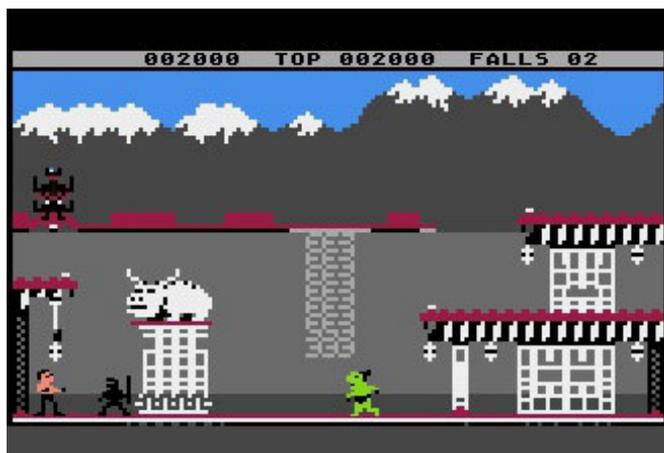
Ma l'aspetto che più fa capire quanto il gioco sia stato confezionato "su misura" sono gli sprite. Gli Atari dispongono di 4 sprite (denominati "players") monocolori da 8 pixel orizzontali per 256 pixel verticali e di 4 sprite (denominati "missiles") monocolori da 2 pixel orizzontali per 256 pixel verticali; questi ultimi possono essere automaticamente raggruppati andando a formare un quinto sprite monocolori da 8 pixel orizzontali per 256 pixel verticali.
