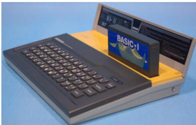
Entrambi i computer furono progettati usando la stessa componentistica di base, infatti hanno come cuore una CPU Z80A a 3.58 MHz, un chip video della Texas Instruments il TMS9929 (Pal) e come chip sonoro il SN76489AN. In pratica sono i discendenti del TI99/4A in quanto differiscono solo della cpu, uno Z80 (8bit) al posto di un TMS9900 (16bit) e sono gli zii del futuro sistema MSX in quanto tra i due sistemi cambia solo il chip audio; l'MSX monta infatti un General Instrument AY-3-8910.
