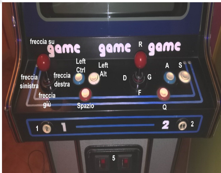
Fig.8 – Esempio di configurazione dei pulsanti dei cabinato tramite software della JammASD.
