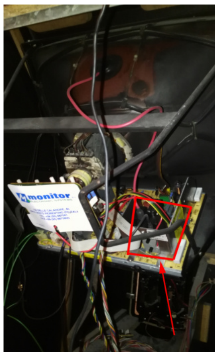
Fig.3 - Trasformatore di riga.
