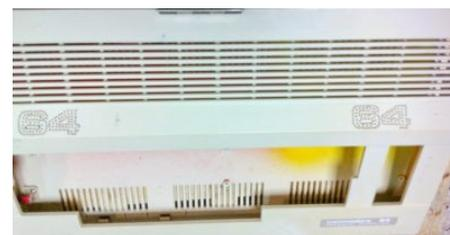
Fatto ciò (con il trapanino e tanta pazienza) si passa ai fori per i Led e la fessura della SD2iec, il controllo volume, il selettore a 4 posizioni per le Rom e i relativi Led, i jack audio IN/OUT, il connettore RCA, nonché il sistema di fissaggio del monitor mediante cerniera.
