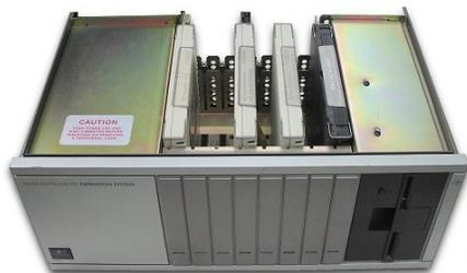
Le caratteristiche della macchina annunciata erano, 64 KB di RAM espandibili ad 1MB, Interfaccia RS232 e disk controller di serie, una versione migliorata del BASIC esteso e fino a 132 colonne di visualizzazione. Al confronto delle attuali espansione massima di memoria da 32K RAM, periferiche costose come interfaccia RS232, unità dischi, un potente ma talvolta macchinoso Extended BASIC e un display a 32/40-colonne, questa macchina fu chiamata nell'articolo "Dream Machine".
