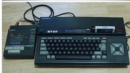
Vi erano ovviamente vari tipi di registratori a cassette, sia commerciali che altri creati specificamente per il computer ad esempio abbiamo il modello commerciale Philips D6260 che quello dedicato al modello MSX1 VG8020, oppure il Sony che manteneva una cassetta standard usando le uscite Ear(cuffie), Mic(microfono), ed Rem(controllo remoto). Altri avevano invece soluzioni custom dove il registratore a cassette aveva
