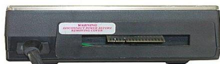
L'immagine sopra mostra la vista frontale e laterale del disk controller che può gestire fino a 3 floppy disk drives, equivalente a quello inserito come scheda nel Peripheral Box.
