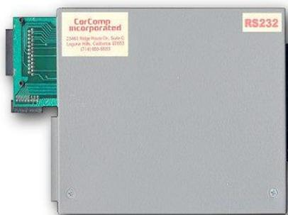
Il sistema di espansione micro 9900 ha un controller del disco DSDD (360k), un'interfaccia RS232 e PIO e 32K di RAM in una forma molto compatta. Questo sistema è collegato al lato della console ed è molto silenzioso (a differenza del PEBOX che è molto rumoroso) ed ha le dimensioni di due sintetizzatori vocali. Quindi è l'ideale per avere una configurazione Tl99 compatta e completa.
