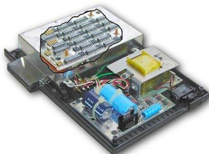
Nella figura che mostra l'esploso della espansione di memoria si nota il circuito di alimentazione che è presente in ogni modulo sidecar.
