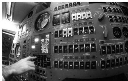
Figura 5: il DSKY a bordo del modulo di comando ripreso durante un test a terra prima del lancio.
