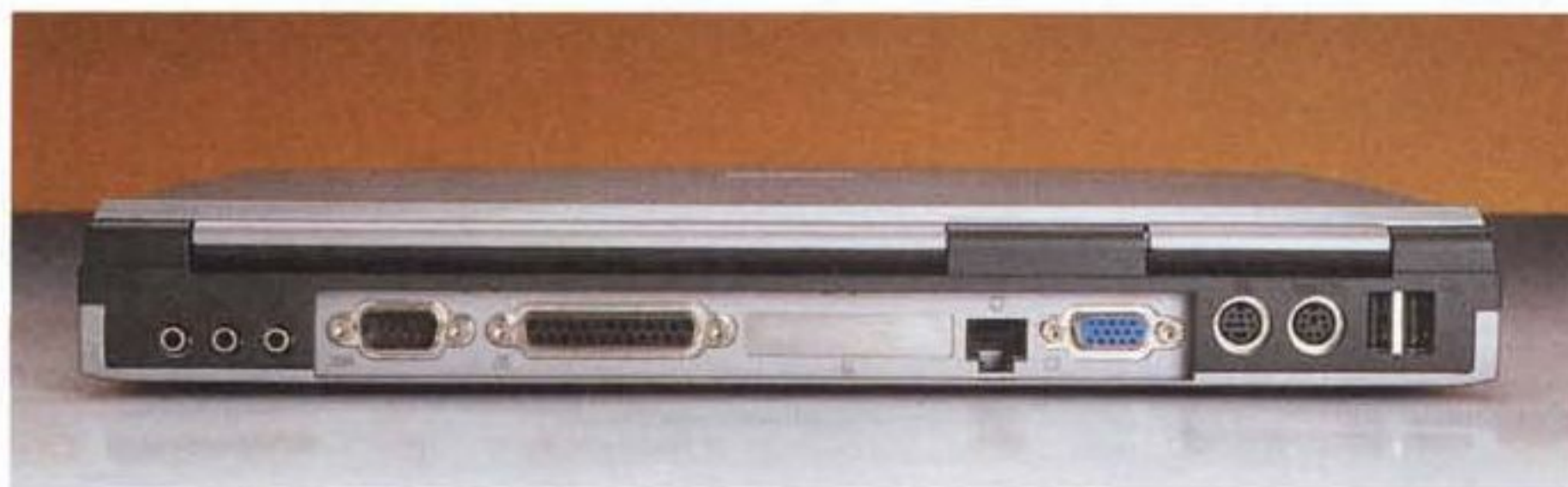
Il retro del notebook: da sinistra, i connettori per l'I/O audio, la porta seriale e la parallela, il connettore RJ 11/45 per il modem V90 e l'interfaccia LAN 10/100 Ethernet integrata, l'uscita VGA esterna, l'uscita TV/Svideo, la porta PS/2 e le due porte seriali USB.
