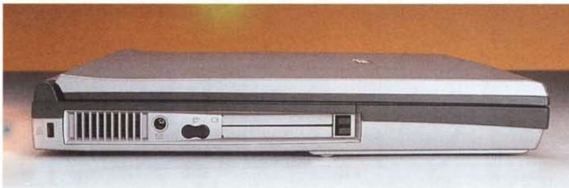
Lato sinistro. Da sinistra, la fessura per il lucchetto di sicurezza a standard Kensington, la griglia di aerazione per il processore, il connettore di alimentazione, la porta IR e gli slot PC-Card, entrambi compatibili ZV.
