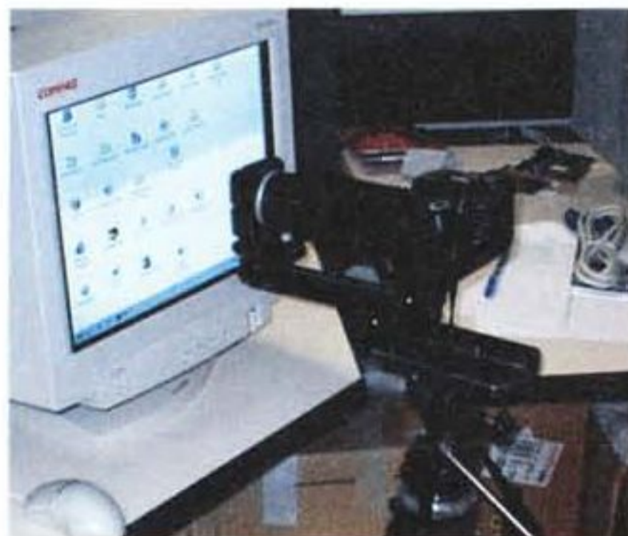
Per riprendere i singoli fosfori dei monitor, abbiamo utilizzato un soffietto alla massima estensione e un obiettivo 24 mm in configurazione invertita. Esposizione da 15 a 30 secondi a diaframma f/8.
