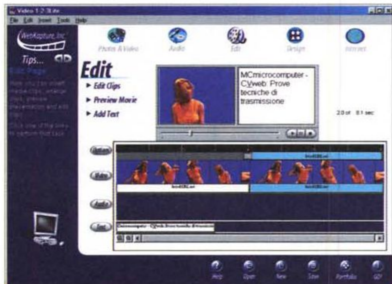
Figura 4 - WebKapture. Il modulo di editing: inserimento delle tracce audio e video, loro sincronizzazione e sovrapposizione di titoli. In alto la finestra di preview.
