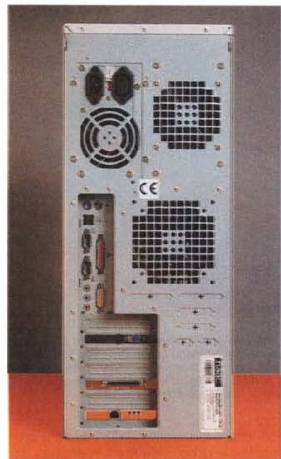
Retro dell'Image 3D: la posizione e la quantità di connettori è quella solita di tutti i pc costruiti seguendo le specifiche ATX. Si noti la dimensione delle griglie di aerazione; quella superiore serve a raffreddare i dischi rigidi, mentre quella inferiore (sprovvista di ventola di raffreddamento), servirebbe per il raffreddamento dei processori Xeon qualora fossero utilizzati.
