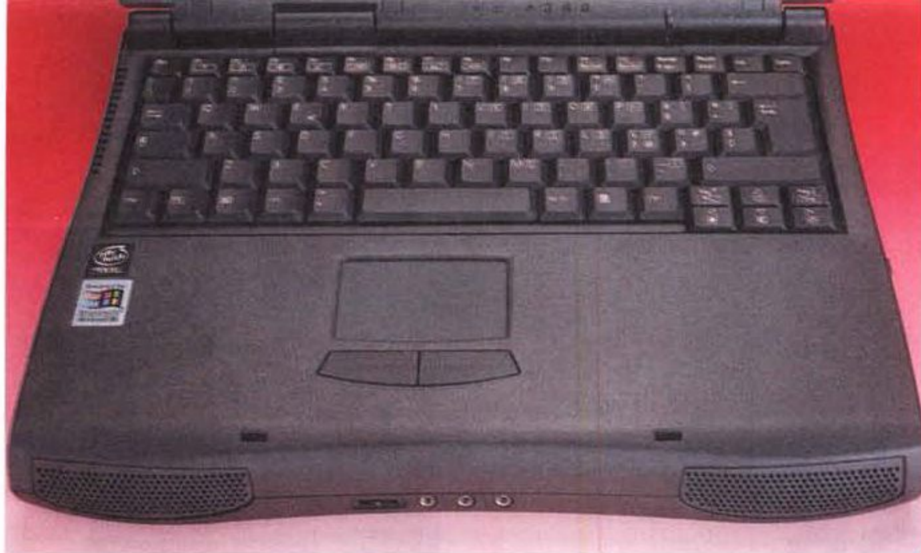
Nella parte frontale, sotto il touch pad, troviamo gli altoparlanti stereo ed al centro, nella parte inferiore, il regolatore del volume e tre ingressi: microfono, line-in, per collegare un dispositivo esterno di input (lettore CD), e line-out, per collegare una coppia di casse esterne.
