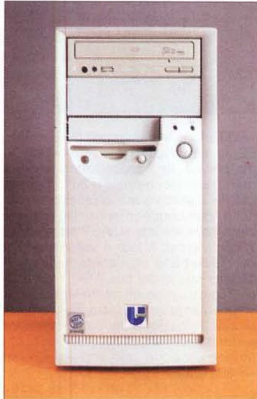
Il case si rivela piuttosto robusto, ma lamenta qualche difetto nell'ergonomia del lettore di floppy e nella qualità degli stampaggi delle parti in plastica.
