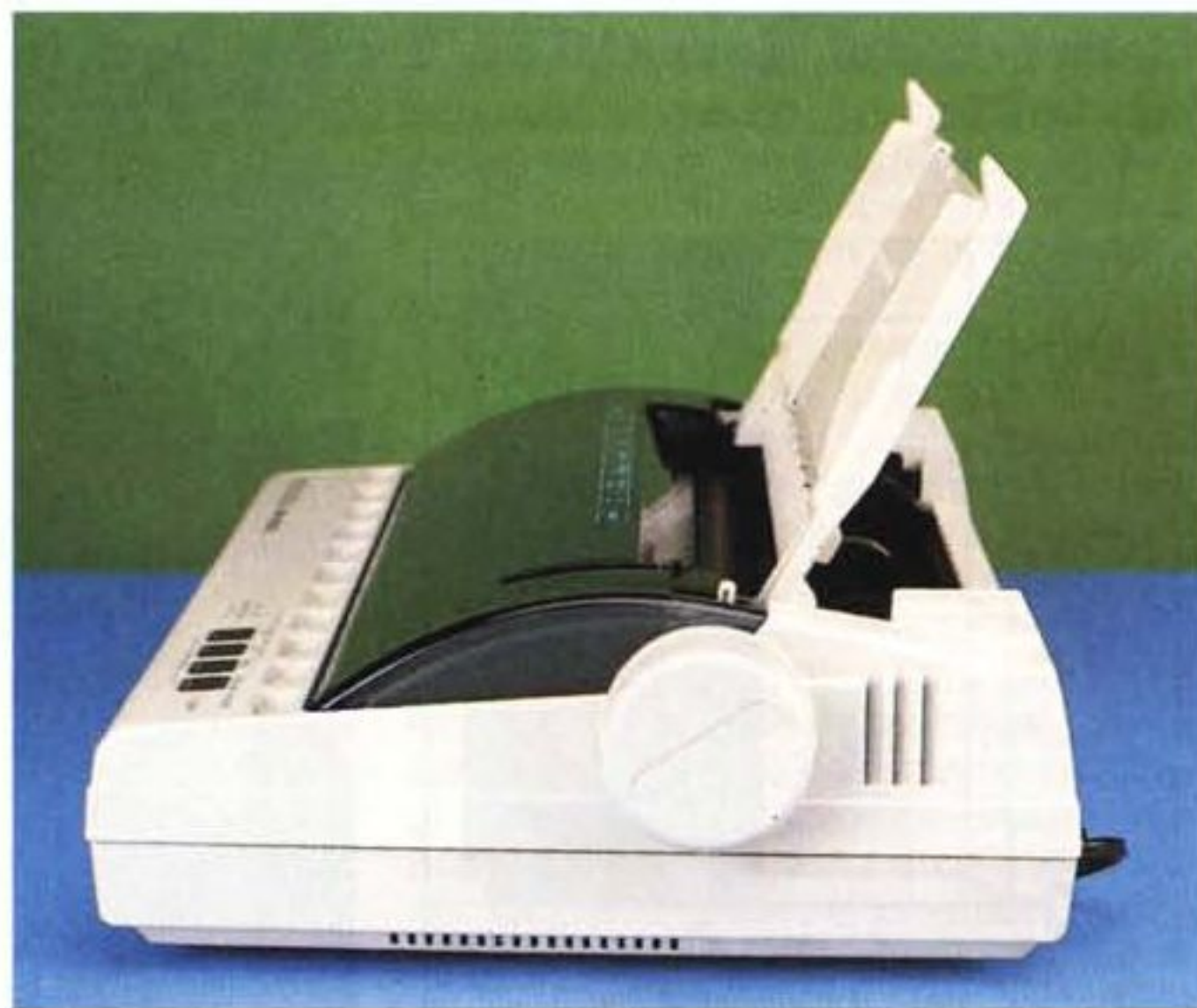
Il coperchio guida carta nelle due posizioni operative possibili: una per il modulo continuo, l'altra per i fogli singoli.
