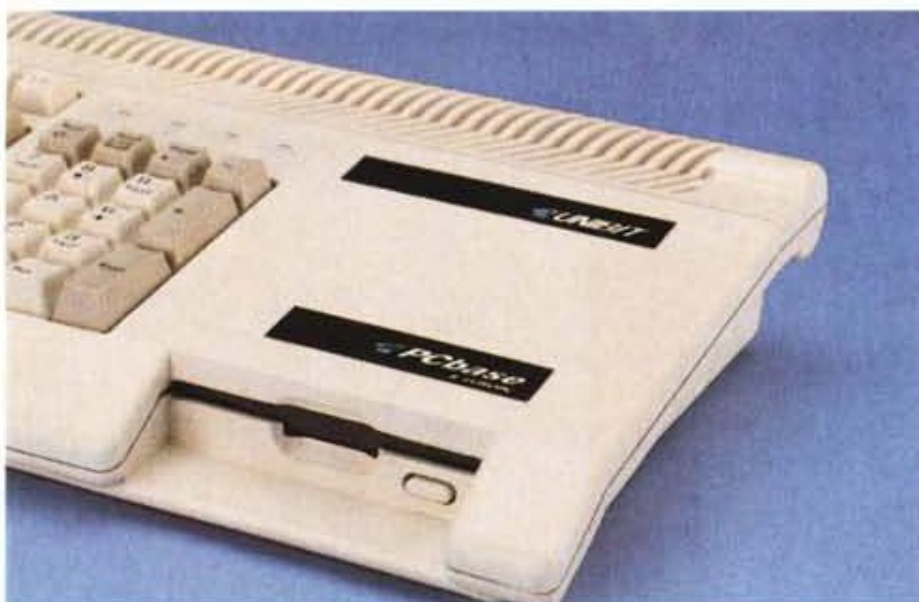
Il retro, il drive da 720K e lo slot di espansione del PCbase.
