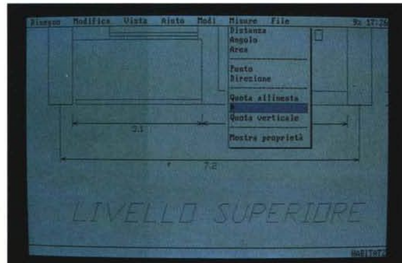
Figura 3 - Autosketch Strumento Zoom. Per quanto di alte prestazioni, un monitor non ha mai la stessa definizione del foglio di carta nel quale l'occhio umano riesce a passare dall'analisi del minimo particolare alla vista d'insieme. Il prodotto CAD dispone quindi dello strumento Zoom che permette di evidenziare al meglio la porzione su cui si lavora.
