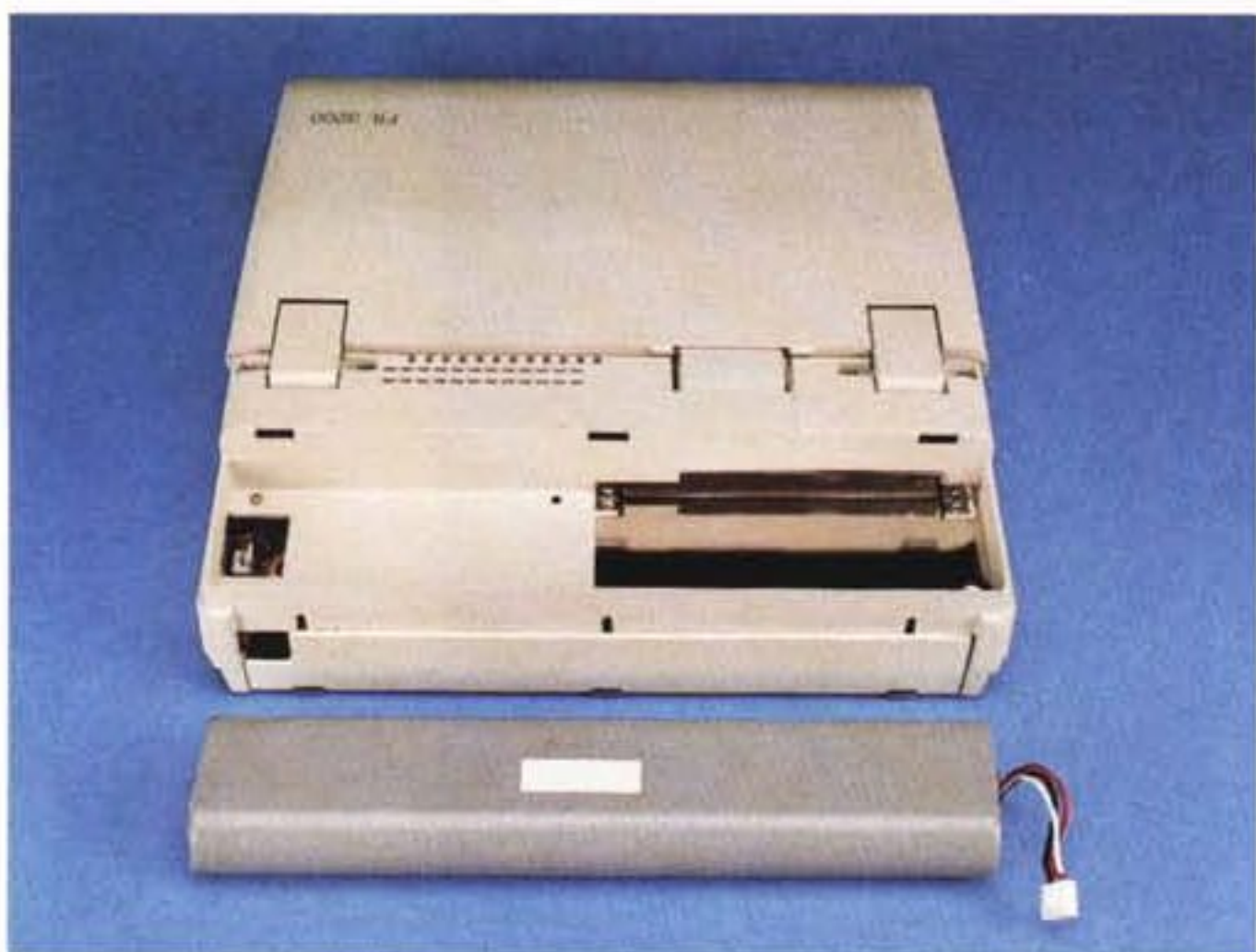
La potente batteria interna del portatile è facilmente sostituibile svitando tre sole viti anche con una moneta.
