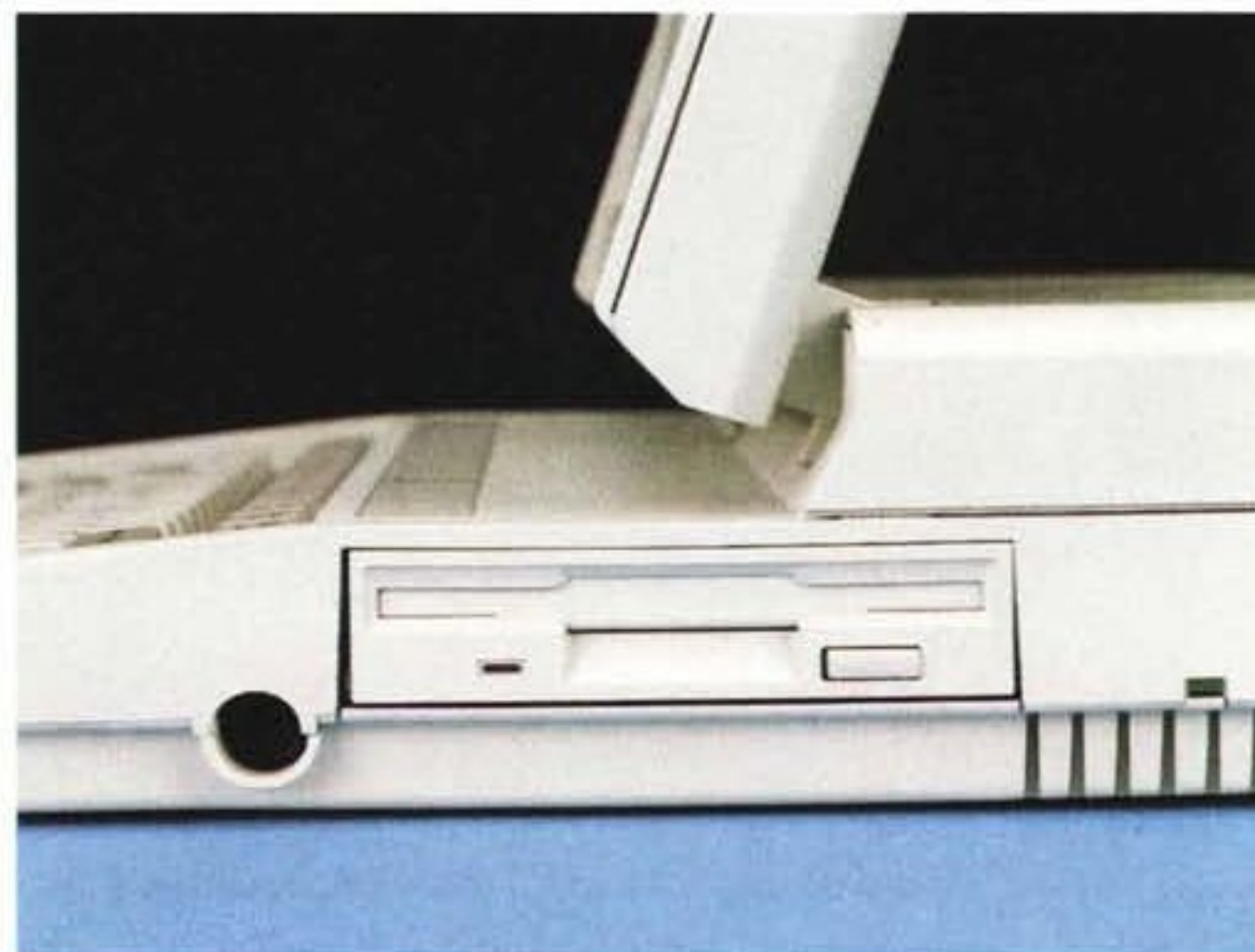
Sul retro della macchina sono presenti tutte le connessioni standard (più un connettore per il bus). A fianco la meccanica FD e la presa per tastiera esterna.
