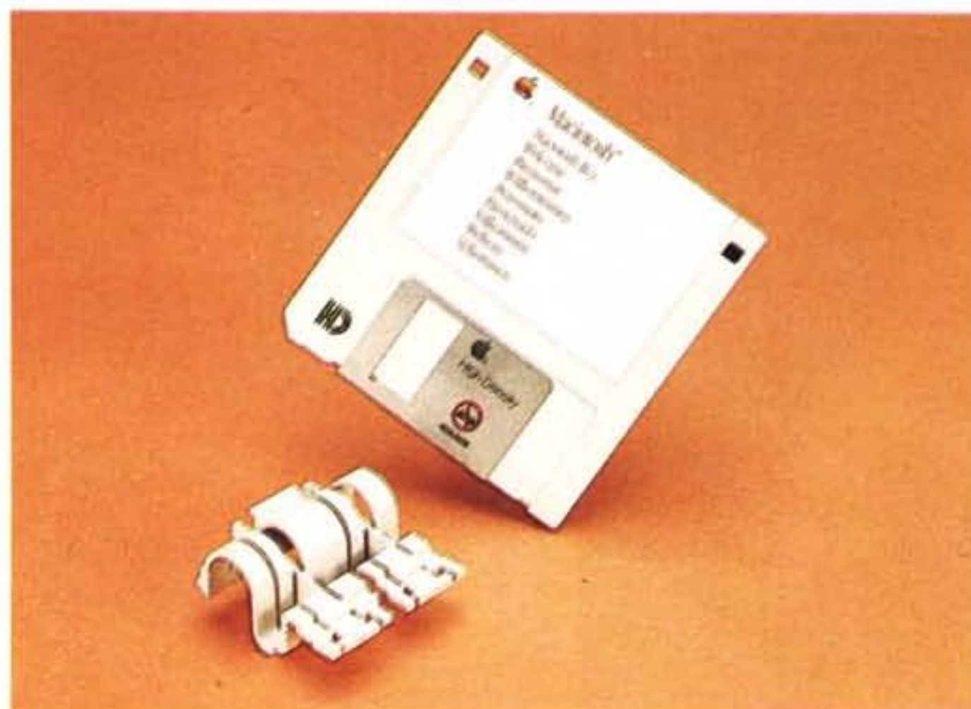
I pulsanti-programmatore, forniti con la macchina ma da montare solo alla bisogna, e, a lato, il dischetto di presentazione del tipo ad alta densità (si notino i due fori di scansione delle sonde del drive).
