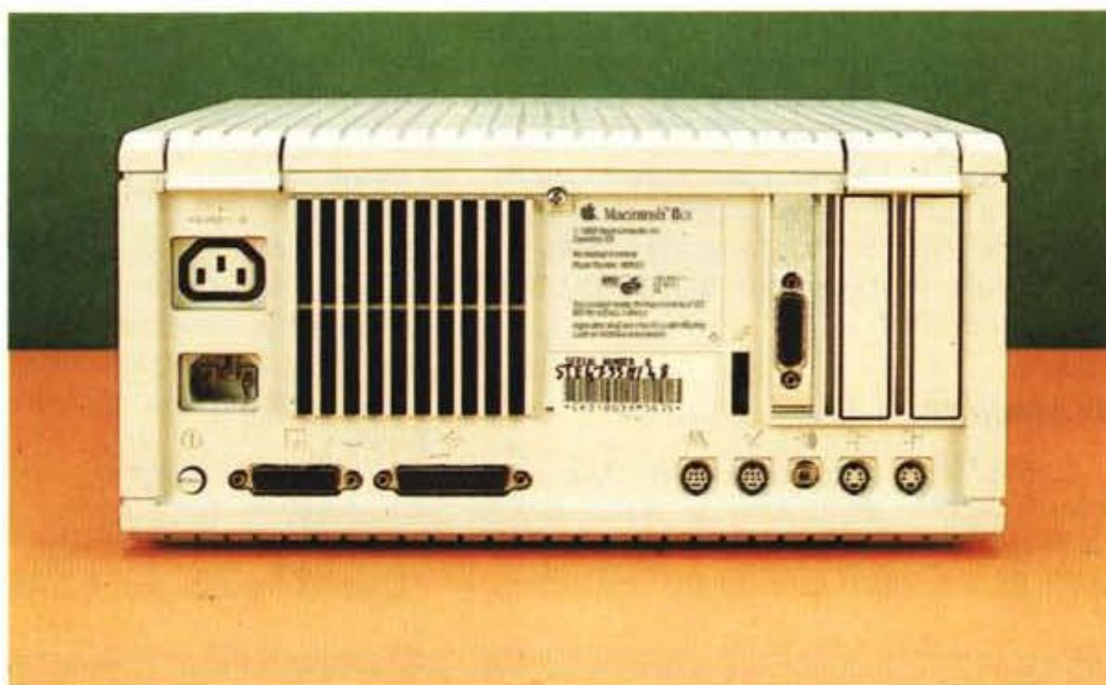
Il retro della macchina, con le porte descritte nel testo; si noti la finestrina dello slot a destra, senza coperchio per alloggiare le uscite della scheda video.
