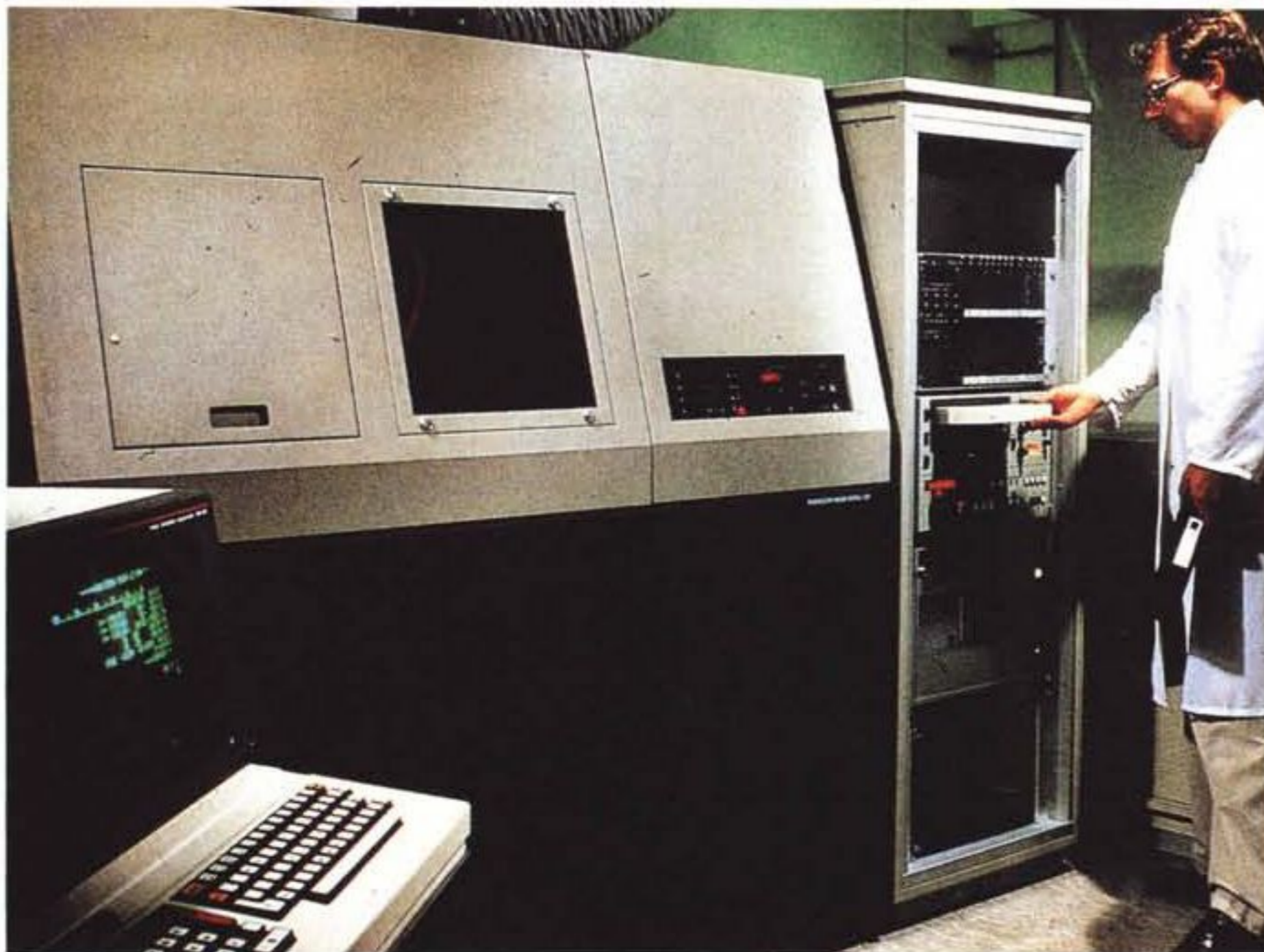
Registratore a raggio laser per la produzione delle matrici dei CD-ROM.
