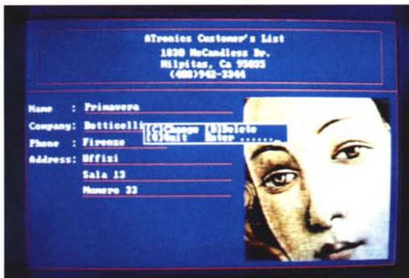
Figura 6 Software dBase. In questa schermata si comprende la finalità dell'utilizzo combinato tra dBase III, che gestisce archivi, e il software PIB, che gestisce immagini. Il risultato consiste nel memorizzare, nel classico archivio DBF, non la figura ma il nome del file con la figura, che come si vede chiaramente dall'esempio, può occupare parte di una maschera di un archivio.
