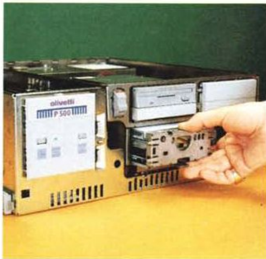
Particolare delle modalità di estrazione del winchester.
