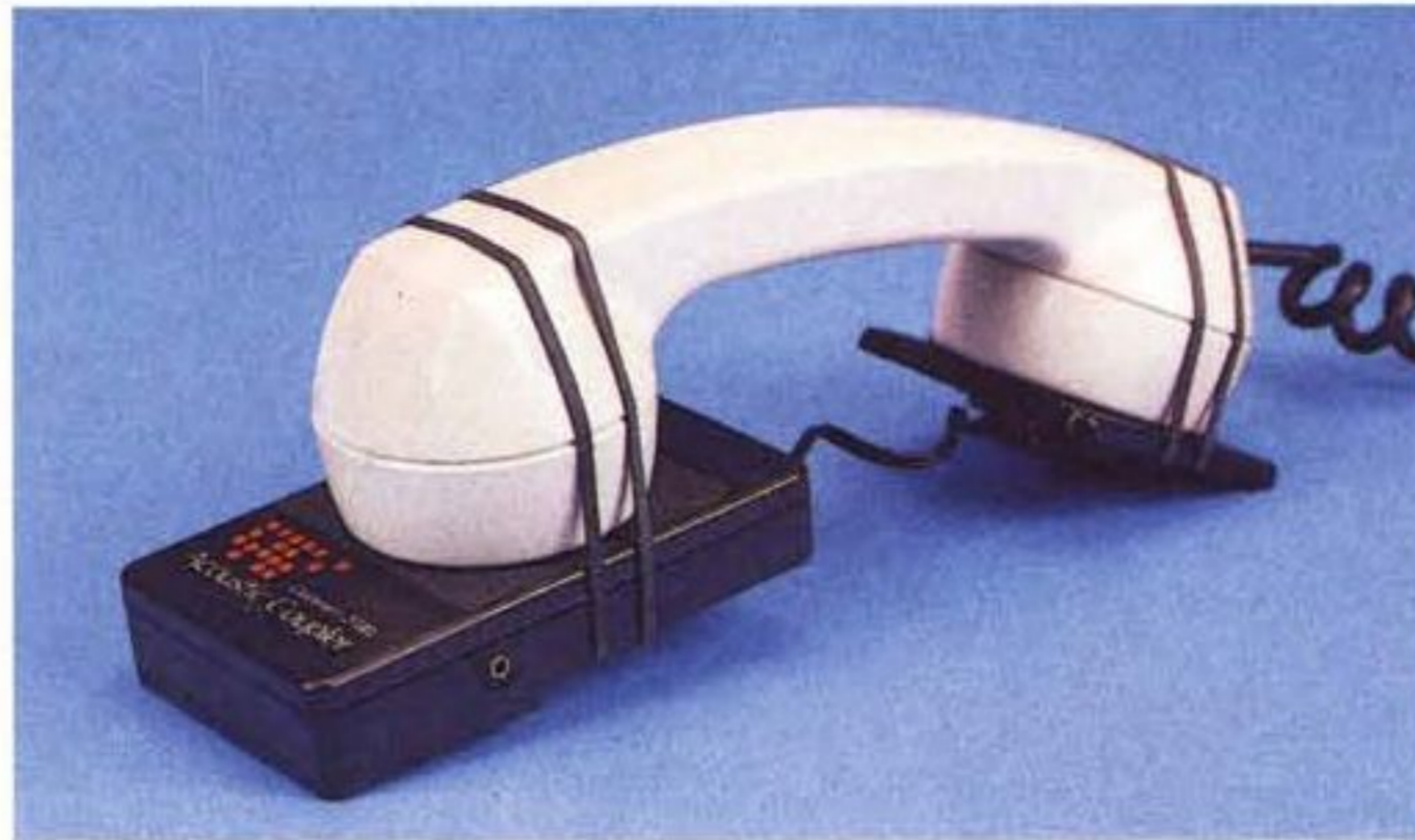
L'accoppiatore acustico Discovery 2100U in condizioni operative: la cornetta telefonica è ancorata piuttosto saldamente mediante dei semplici elastici.
