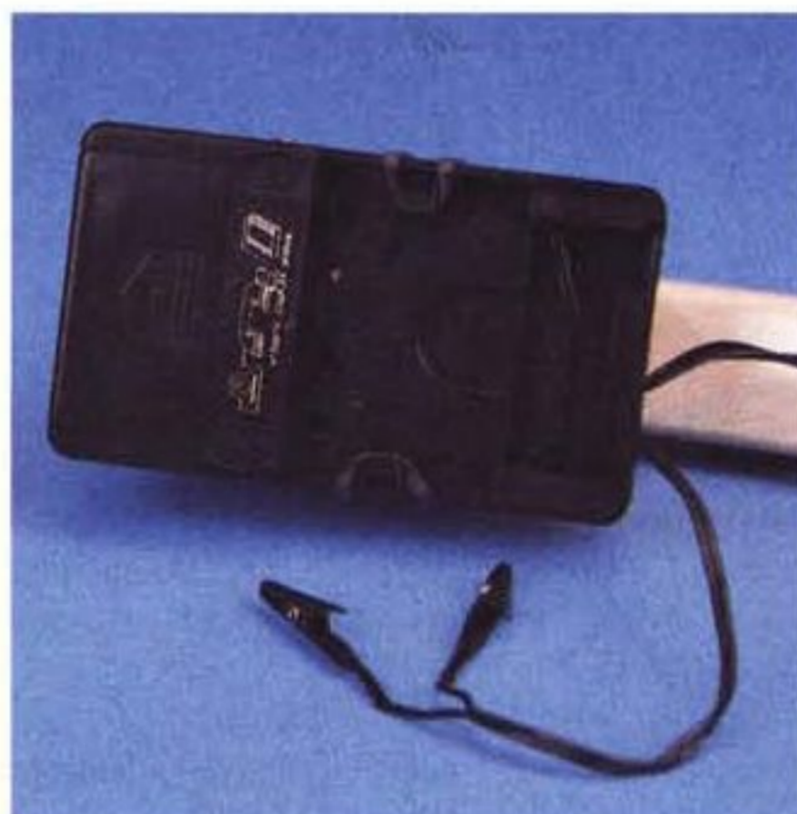
Un particolare del modem 1200P e le pinzette dell'accoppiatore che permettono il collegamento diretto alla linea.
