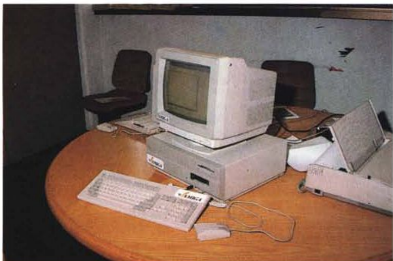
L'Amiga 2500 UX: notare lo streamer al posto del drive da 5.25.
