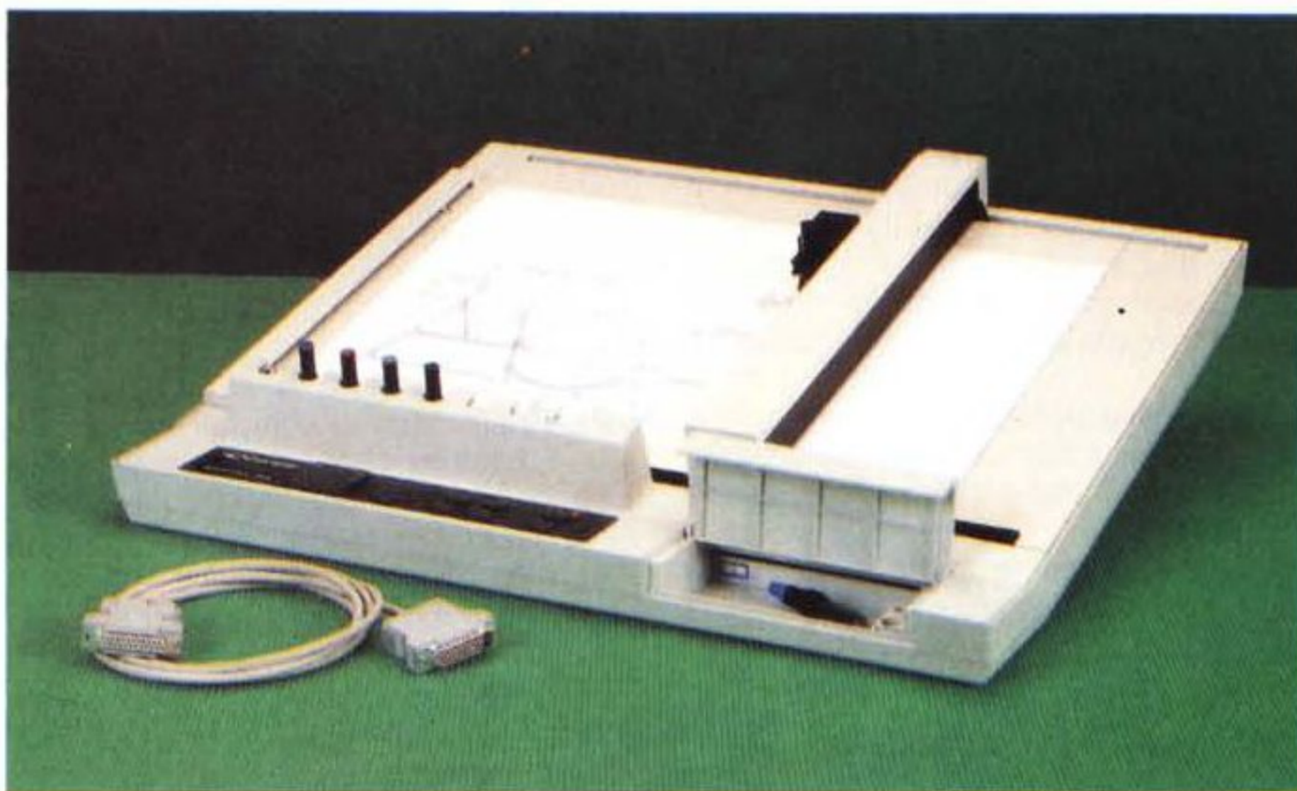
Il plotter in condizioni operative per il supporto del formato A3: è ben visibile il vano per riporre i pennini ed il cavo seriale in dotazione.
