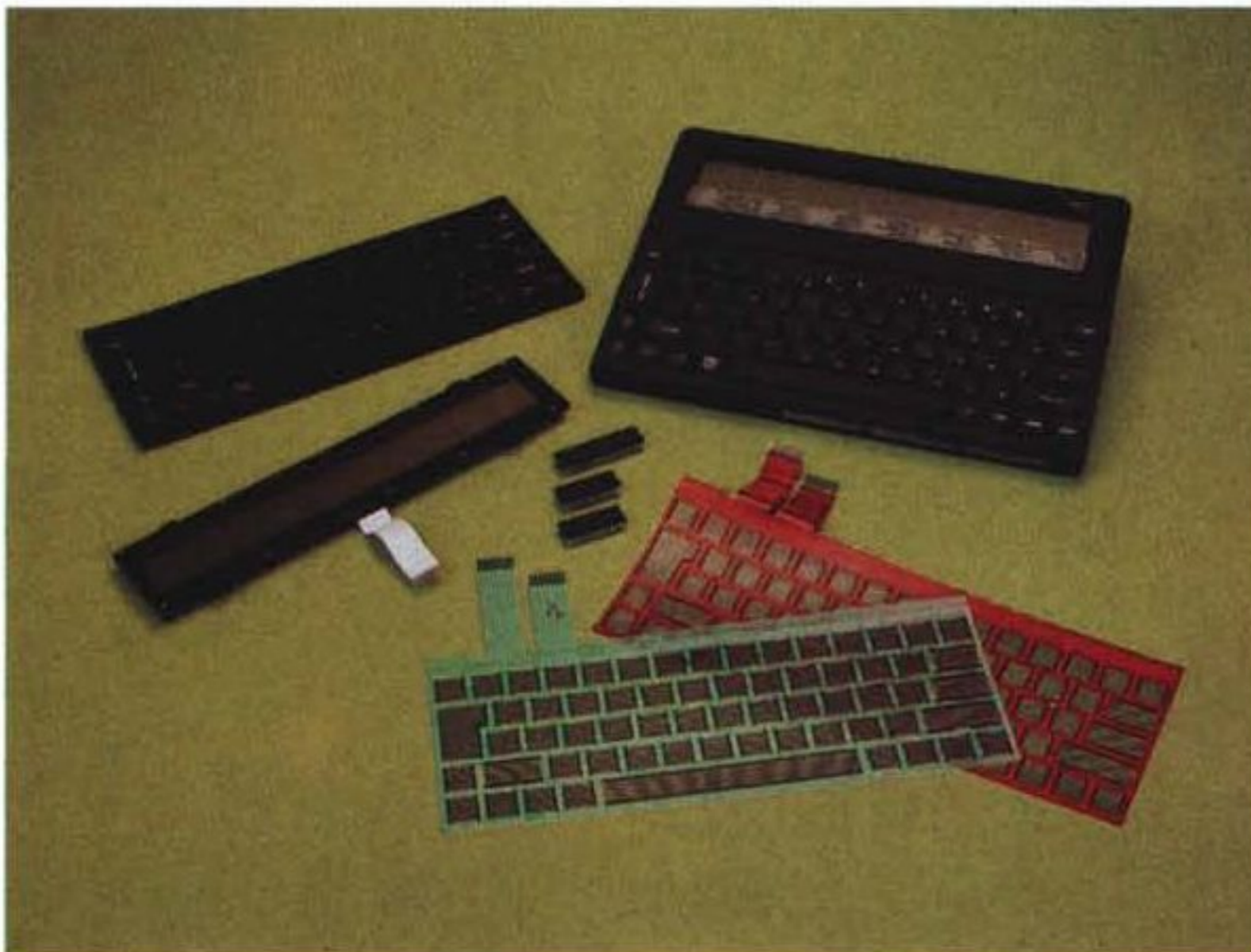
Una veduta d'insieme di alcuni dei ricambi disponibili per lo Z88; sono ben visibili le membrane sensibili (nei due tipi) che costituiscono la tastiera.
