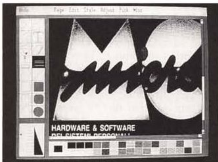
Figura 9 - Immagine digitalizzata via scanner a toni di grigio. Se l'immagine da catturare deve essere riprodotta in bianco-nero, si può utilizzare, invece della telecamera, uno scanner. Esistono gli scanner piani, la cui dimensione massima di lettura è il formato A4, e gli scanner a mano, molto più economici, che leggono strisciate larghe 10 cm. Esistono due modalità di lettura, quella che interpreta i colori in toni di grigio (Dither) e quella che traduce tutto in bianco-nero (Line Art). In questo caso vediamo uno stralcio della copertina di MC n. 80 letta in modalità Dither.
