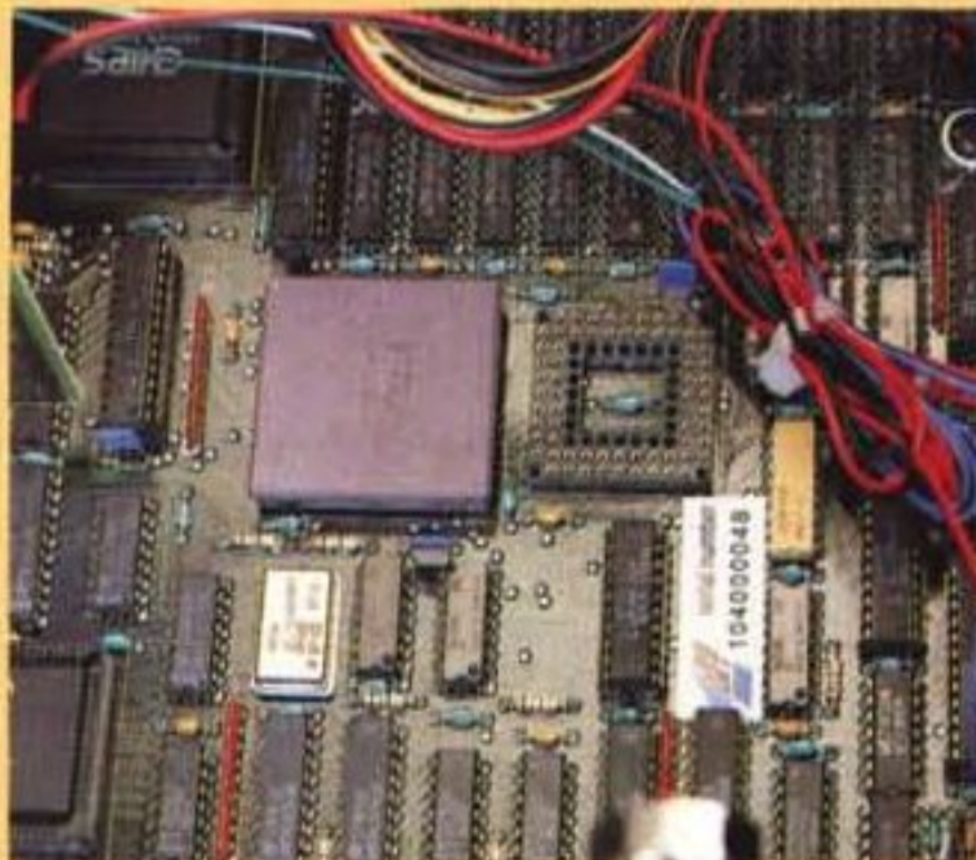
Una veduta dell'interno ed il particolare del processore 386.
