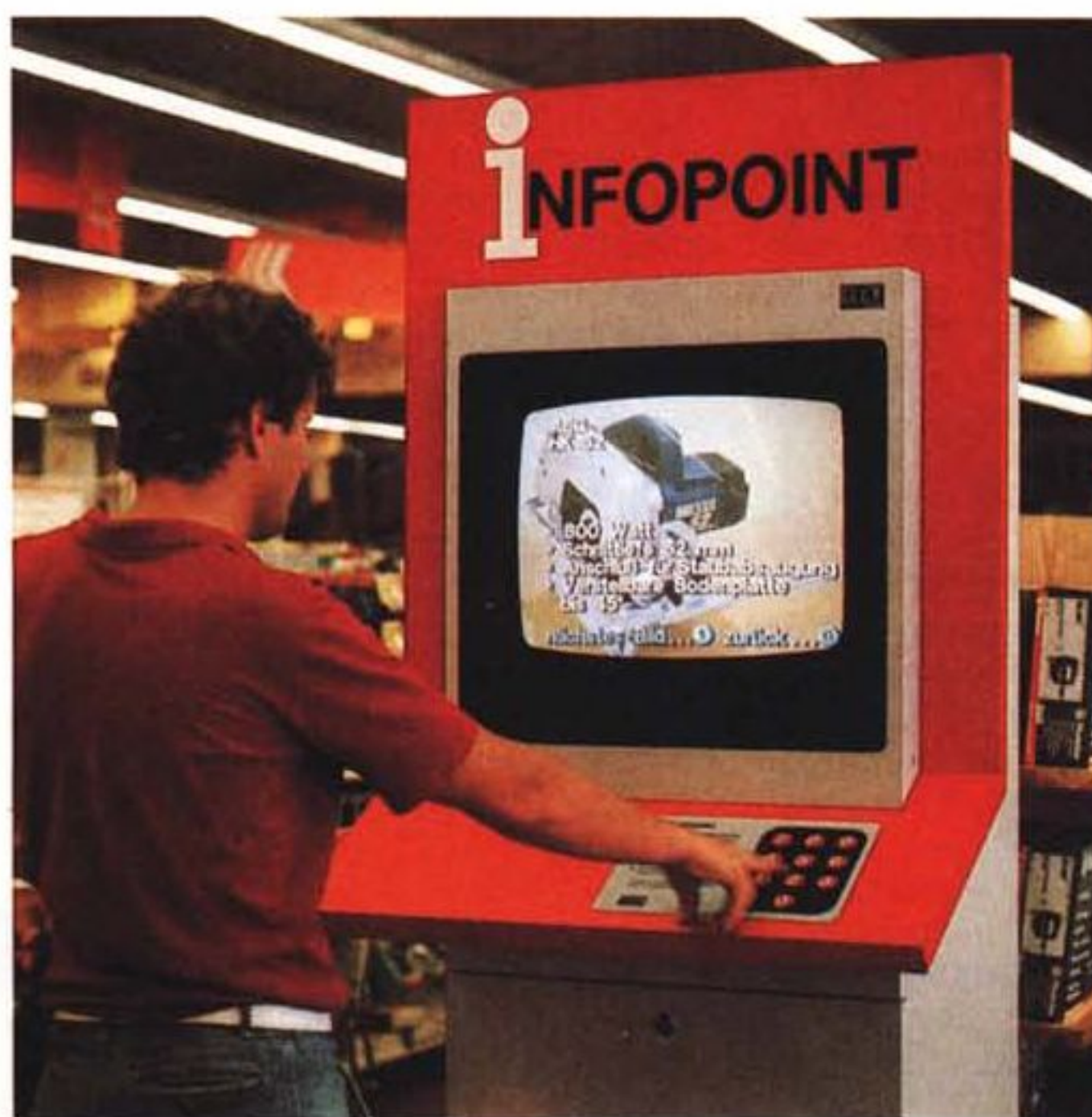
Questo è un "Point of Information" interattivo, basato su un sistema Laser Vision + Computer. Molto comuni nei «Mall» statunitensi, questo nella foto è installato in Germania.
