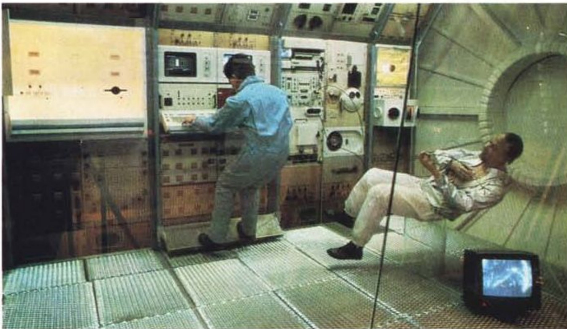
Centro iperbarico dove sono riprodotte le condizioni «estreme» di pressione atmosferica delle profondità marine.
