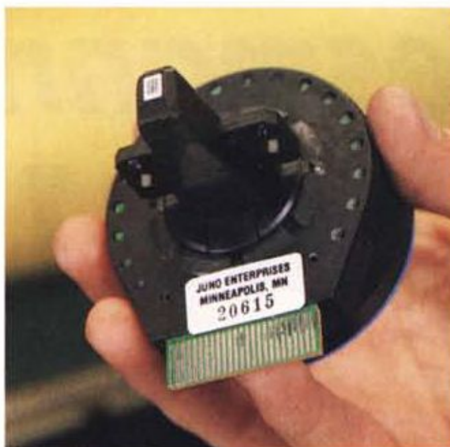
La testa di stampa ed un particolare che mostra il motorino che trasla verticalmente il nastro a colori.
