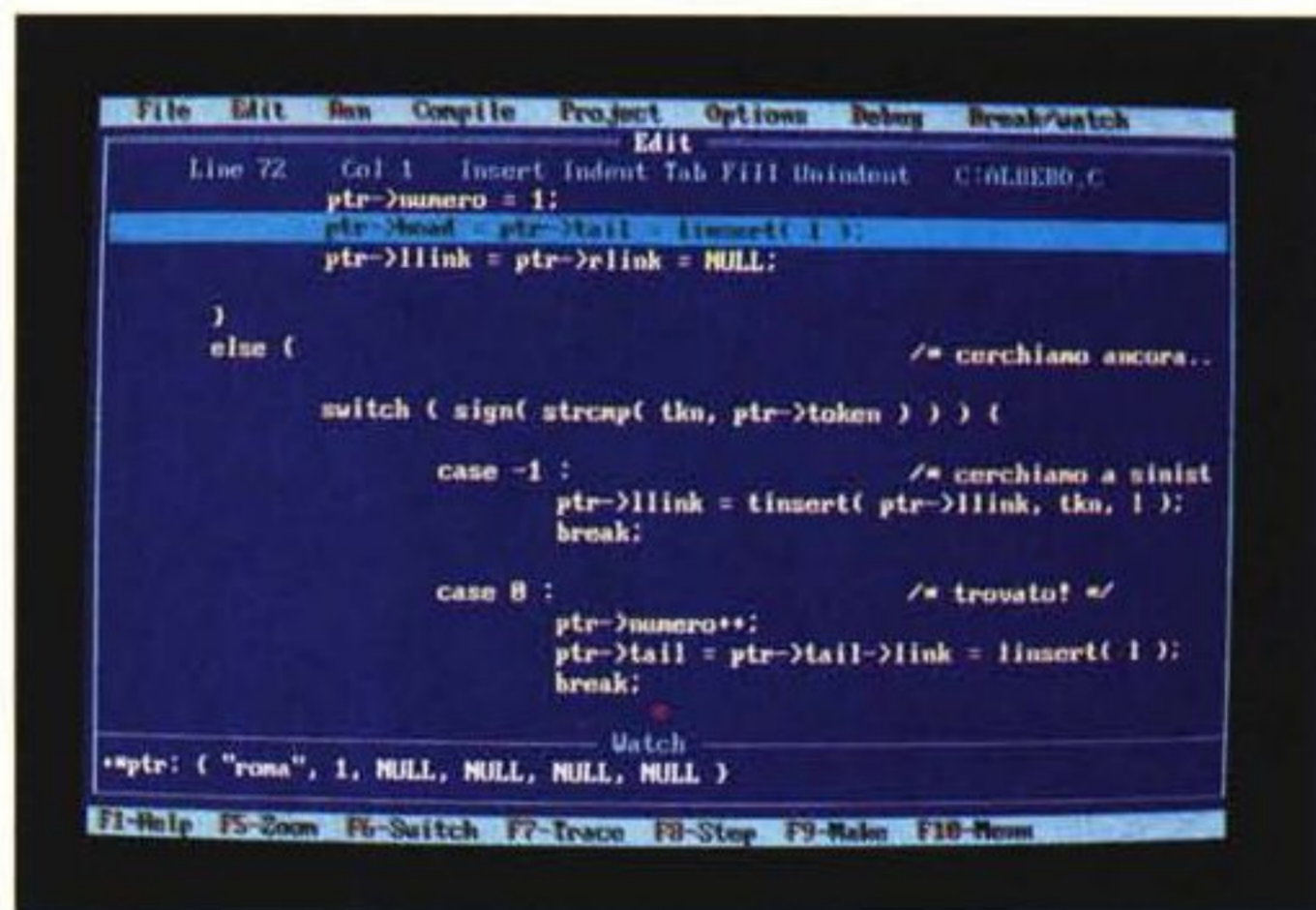
Due istanti di una sessione di debug. Qui sopra, stiamo inserendo un «watch» su un puntatore. A destra si vede chiaramente mostrata la struttura da esso puntata.
