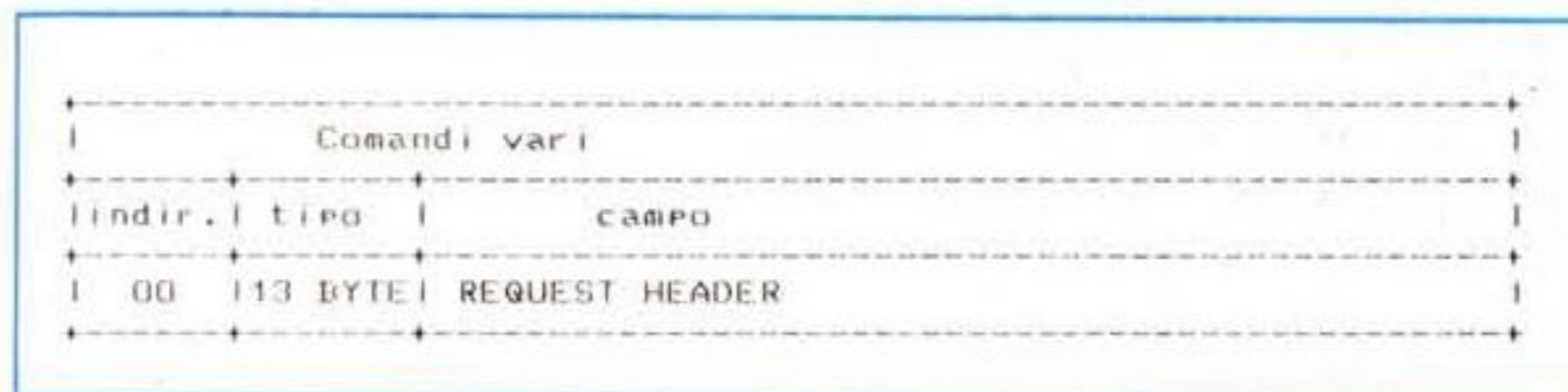
Figura 3 - Struttura del Request Header nel caso di chiamata alle routine INPUT STATUS, OUTPUT STATUS, INPUT FLUSH, OUTPUT FLUSH, OPEN, CLOSE e REMOVABLE MEDIA: in tutti questi casi, infatti, la funzione non ha bisogno di campi aggiuntivi, ma deve solo settare alcuni campi all'interno del Request Header stesso, come è spiegato in dettaglio nell'articolo.
