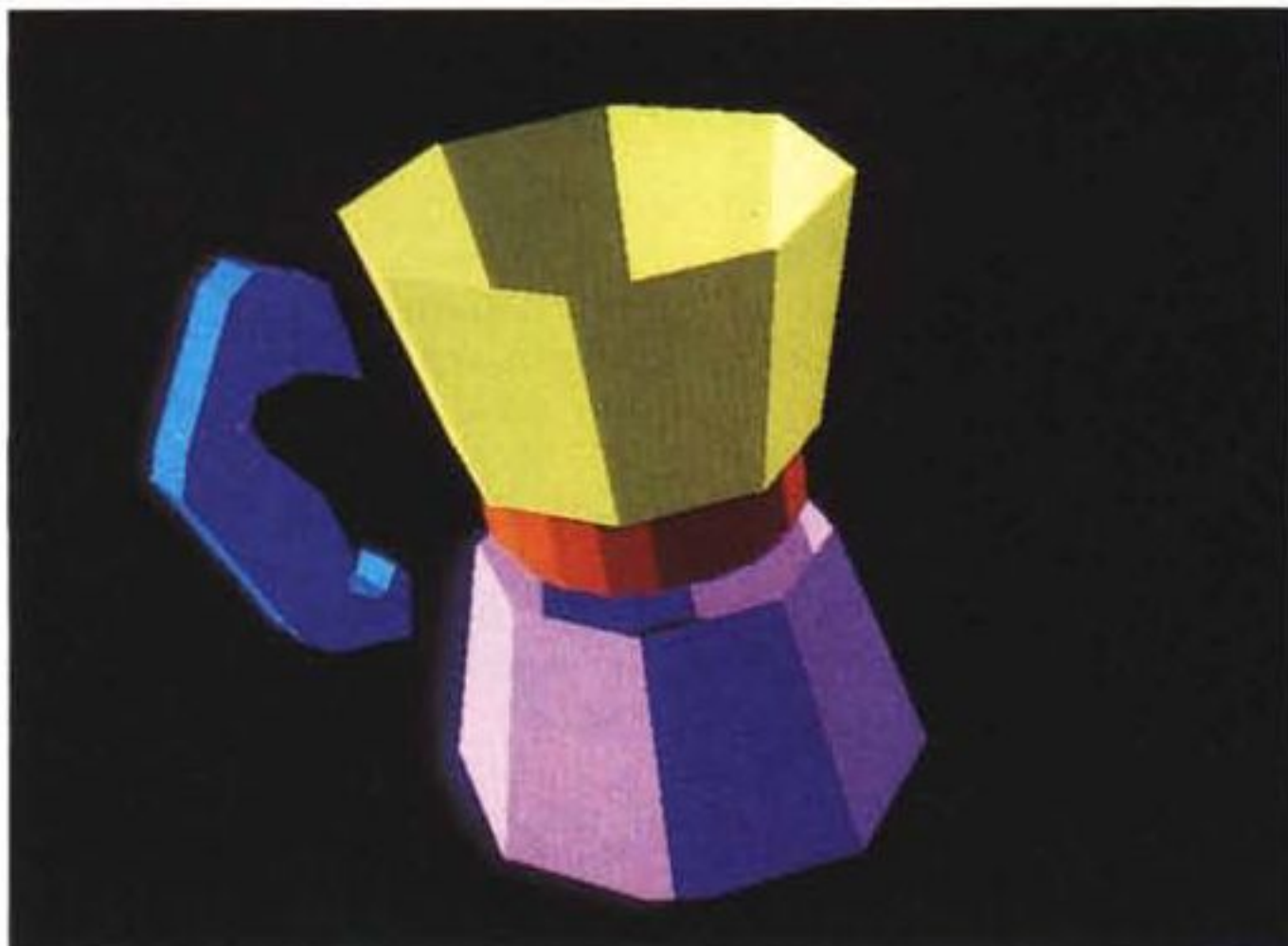
Figure 10-11 - La nostra Moka Express. Quando, quasi un anno fa, facemmo un corso di Autocad, utilizzammo, come esercitazione pratica, una caffettiera Moka Express, oggetto noto a tutti. Una volta disegnato con Autocad, viene... passato ad Autoshade (che ricordiamolo non è un prodotto che permette di disegnare) che provvede, opportunamente guidato, di fornirne delle viste realistiche.
