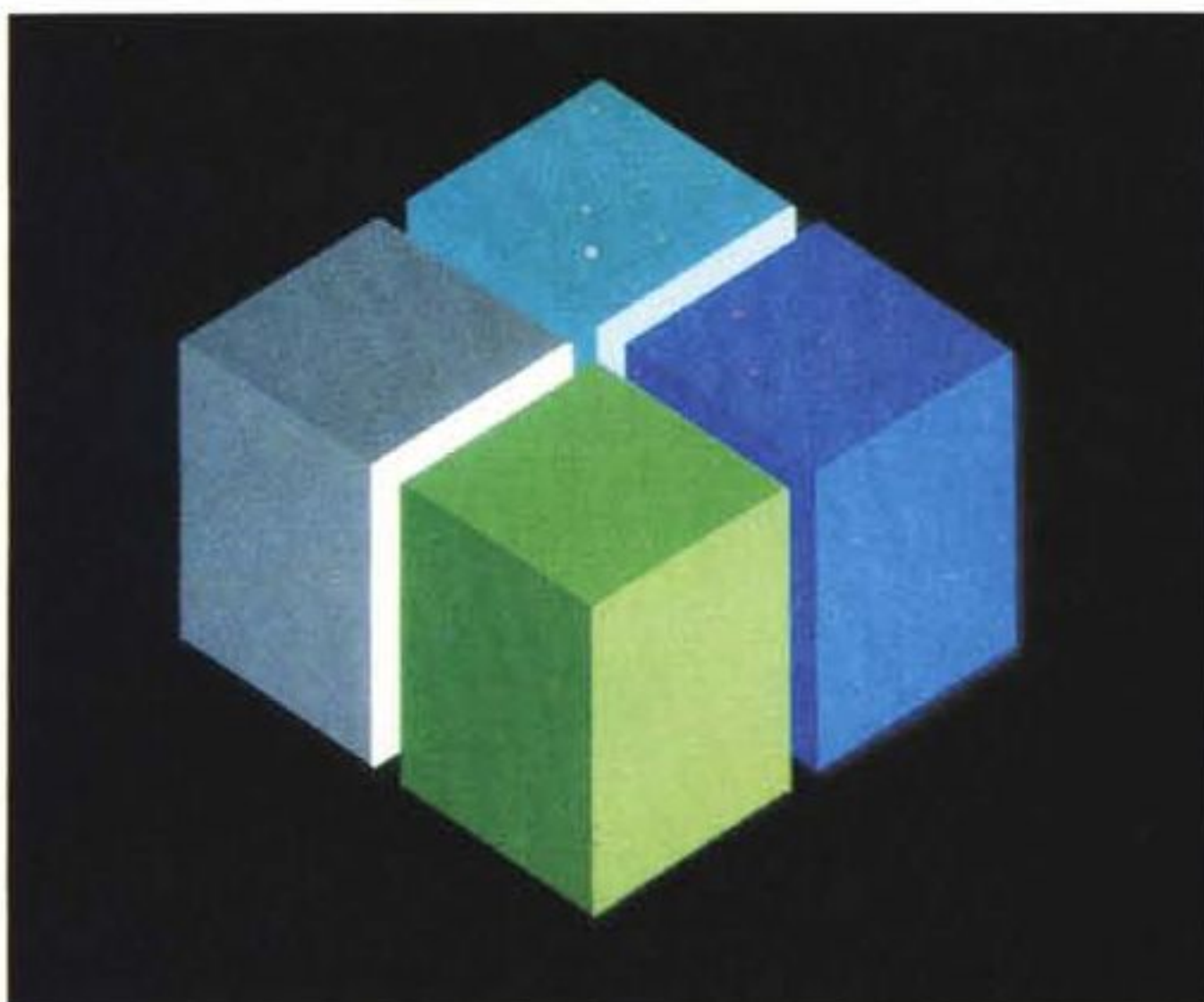
Figure 5, 6 - Proiezione Assonometrica Proiezione Prospettica. Per proiettare su un piano (su un foglio) bidimensionale un oggetto a tre dimensioni esistono due metodi, quello assonometrico (le linee parallele rimangono tali), usato da Autocad e quello prospettico (le linee parallele convergono verso uno o più punti di fuga) usato da Autoshade. Nelle due figure è possibile, anche visivamente, cogliere la differenza.
