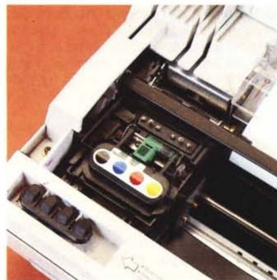
▶ La testa di stampa a 20 ugelli ed i 4 serbatoi colore.
