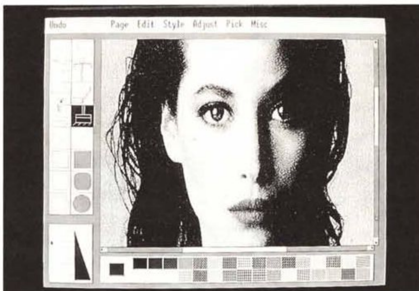
Figura 5 Operazione di Scanning. Altro anello indispensabile nella catena del DTP, è quello costituito dallo Scanner con il quale si «catturano» immagini dal mondo esterno per riverarle nei vari formati grafici dai vari prodotti. L'operazione lanciabile facilmente (è equivalente a caricare un file dal disco) va comunque accuratamente eseguita per dosare i contrast, per valutare le dimensioni e l'accuratezza della lettura.
