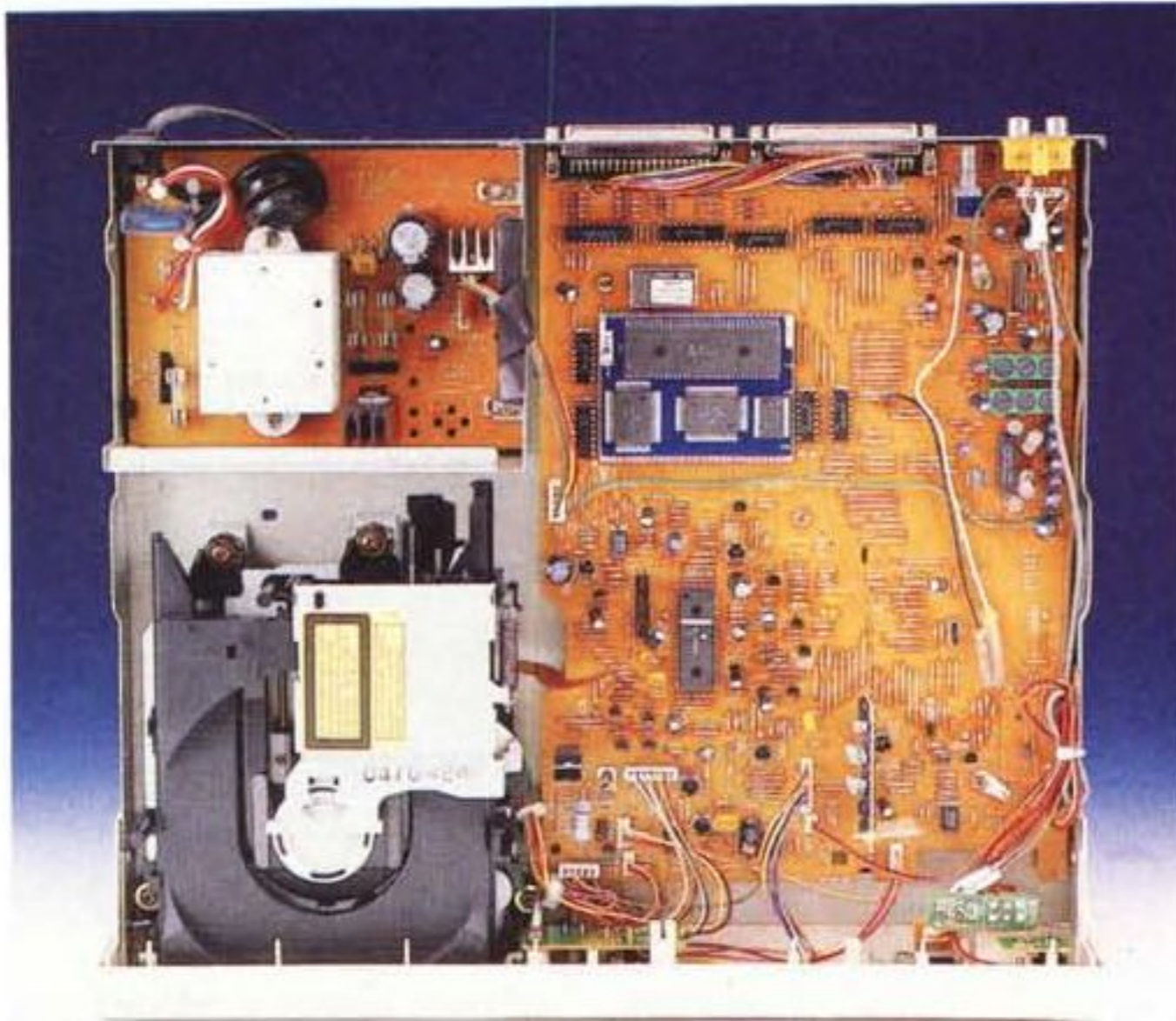
Questo è l'interno di un lettore CD-ROM mentre a destra è visibile il relativo controller, spesso fonte di incompatibilità.
