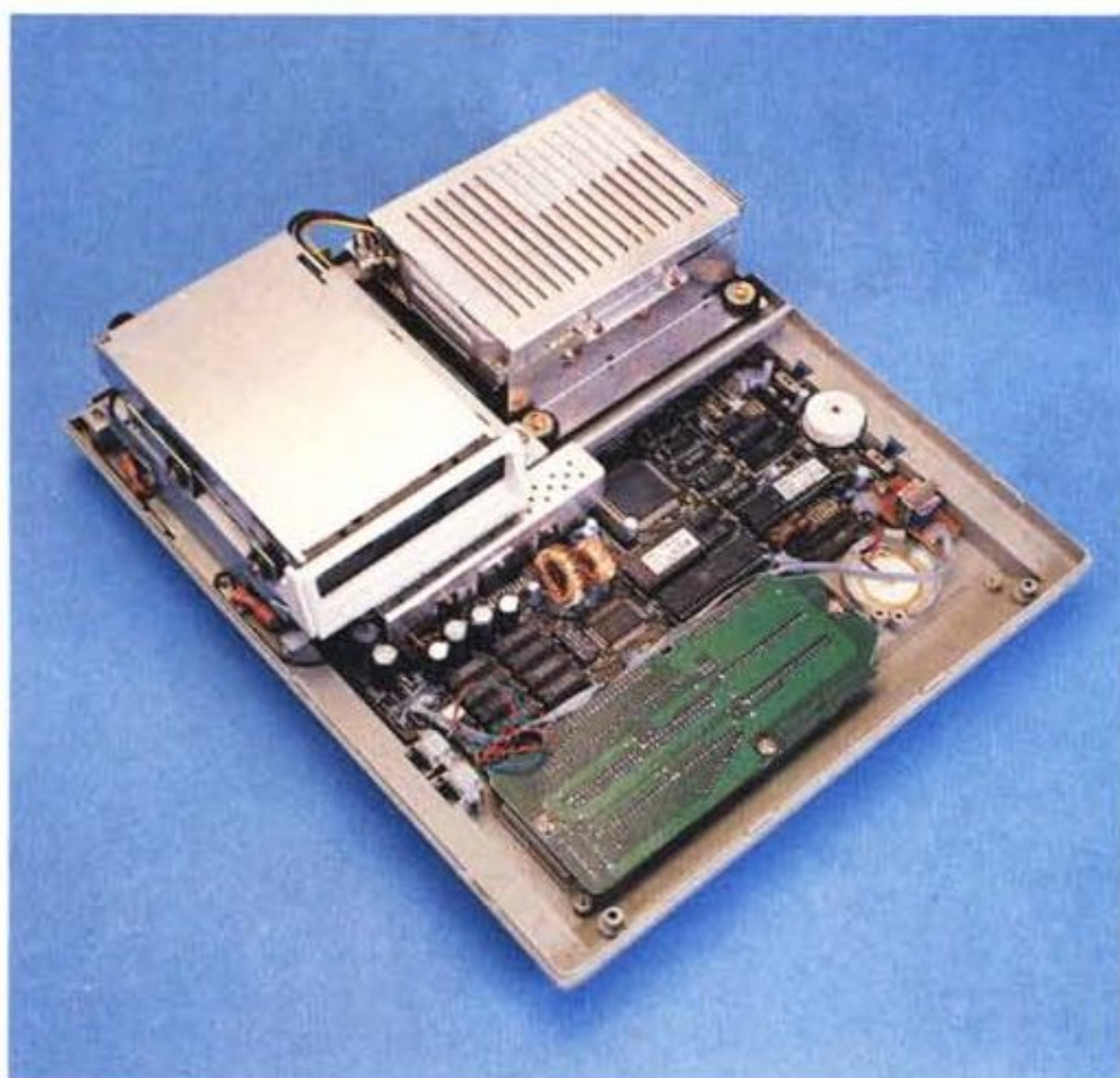
Una veduta della macchina appena aperta e, qui a destra, la piastra contenente tutta l'elettronica di base, i controller per i floppy disk, il modem e l'alimentatore.
