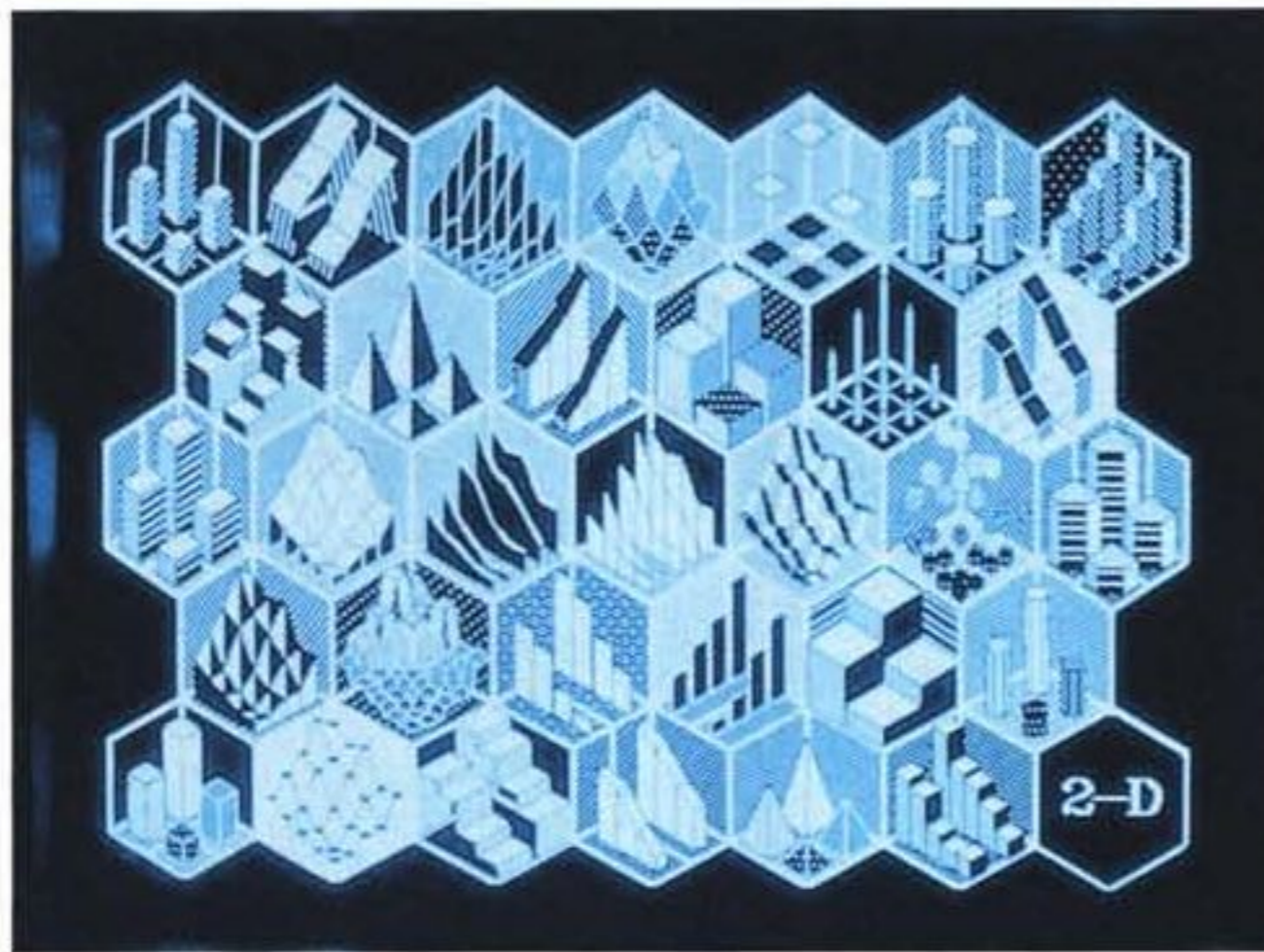
Figura 11 Enable Perspective 3D Tabella. Costruita con la funzione Spreadsheet una tabella di valori numerici ed impostate le zone dei dati da graficare si richiama dal menu di servizio il 3D. Enable passa i dati al 3D, che carica la propria tabella e elabora secondo la tipologia prescelta il disegno finale.
