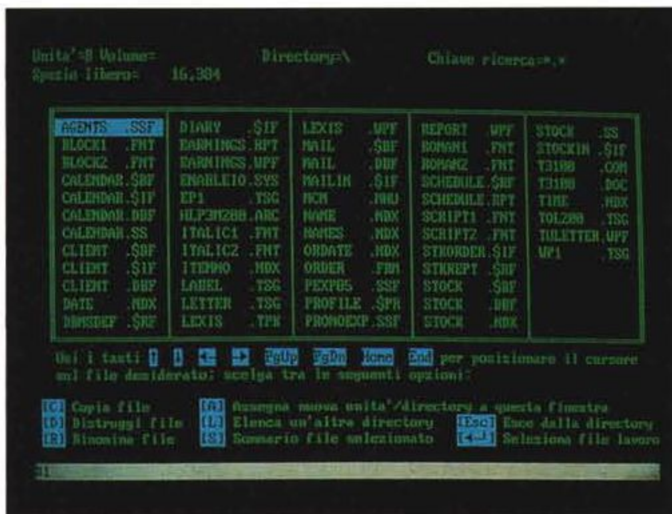
Figura 4 Enable File Manager Il file Manager, richiamabile da tutti gli ambienti, dispone di una sua maschera operativa che permette, oltre alle normali operazioni di caricamento e salvataggio, anche l'esecuzione, rimanendo in Enable, dei principali comandi DOS.
