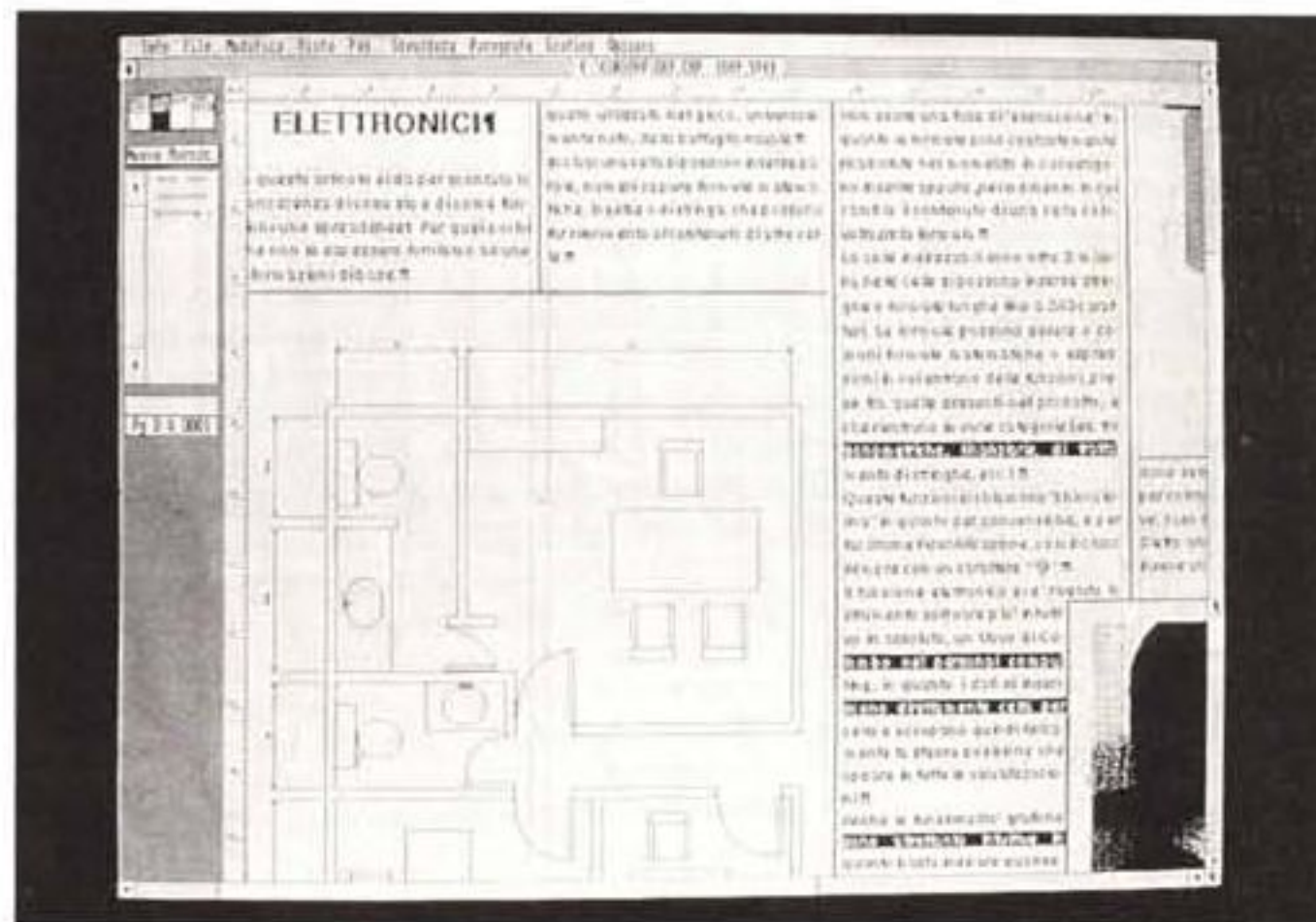
Figura 8 Disegno Autocad in Ventura. Un altro compagno grafico ideale di Ventura è l'Autocad. Questo dispone di tre modalità di uscita su file differenti, la DWG, che è il formato standard Autocad, il DXF che è un formato codificato testuale, quindi rielaborabile facilmente con altri prodotti e infine il SLD, slide, che è la memorizzazione di una immagine completa.
