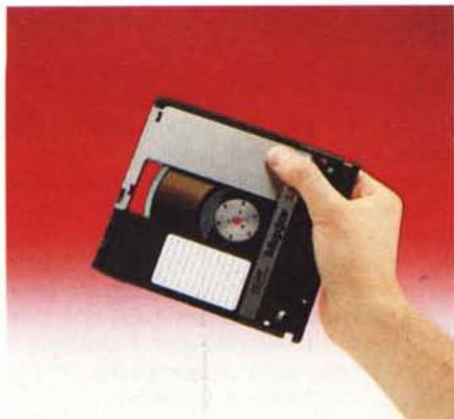
Ecco le due cartucce ottiche: la Maxtor usa una resina sintetica per ricoprire il film che viene inciso, ottenendo una cartuccia più sottile della Optotech.
