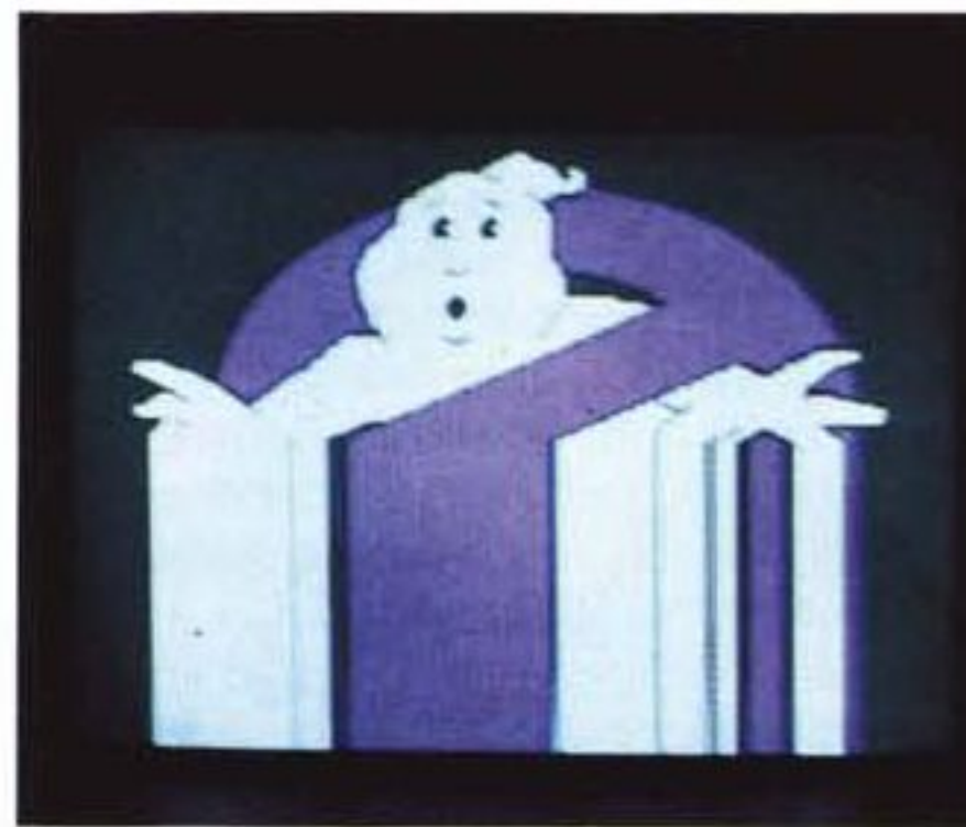
Figura 9 - Modulo Script Editor - Tecnica di Passaggio DRIM. Altro effetto che non si può valutare in una figura statica è quello del passaggio da una immagine all'altra. In questo caso cogliamo al volo un momento della tecnica DRIM, con la quale l'immagine che entra viene fatta scivolare per linee orizzontali sul video. È un effetto molto spettacolare.
