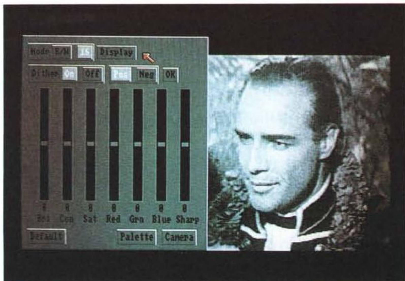
Marlon Brando digitalizzato in media risoluzione (640x200) e 16 livelli di grigio. Sulla sinistra i controlli per l'elaborazione di tipo fotografico.
