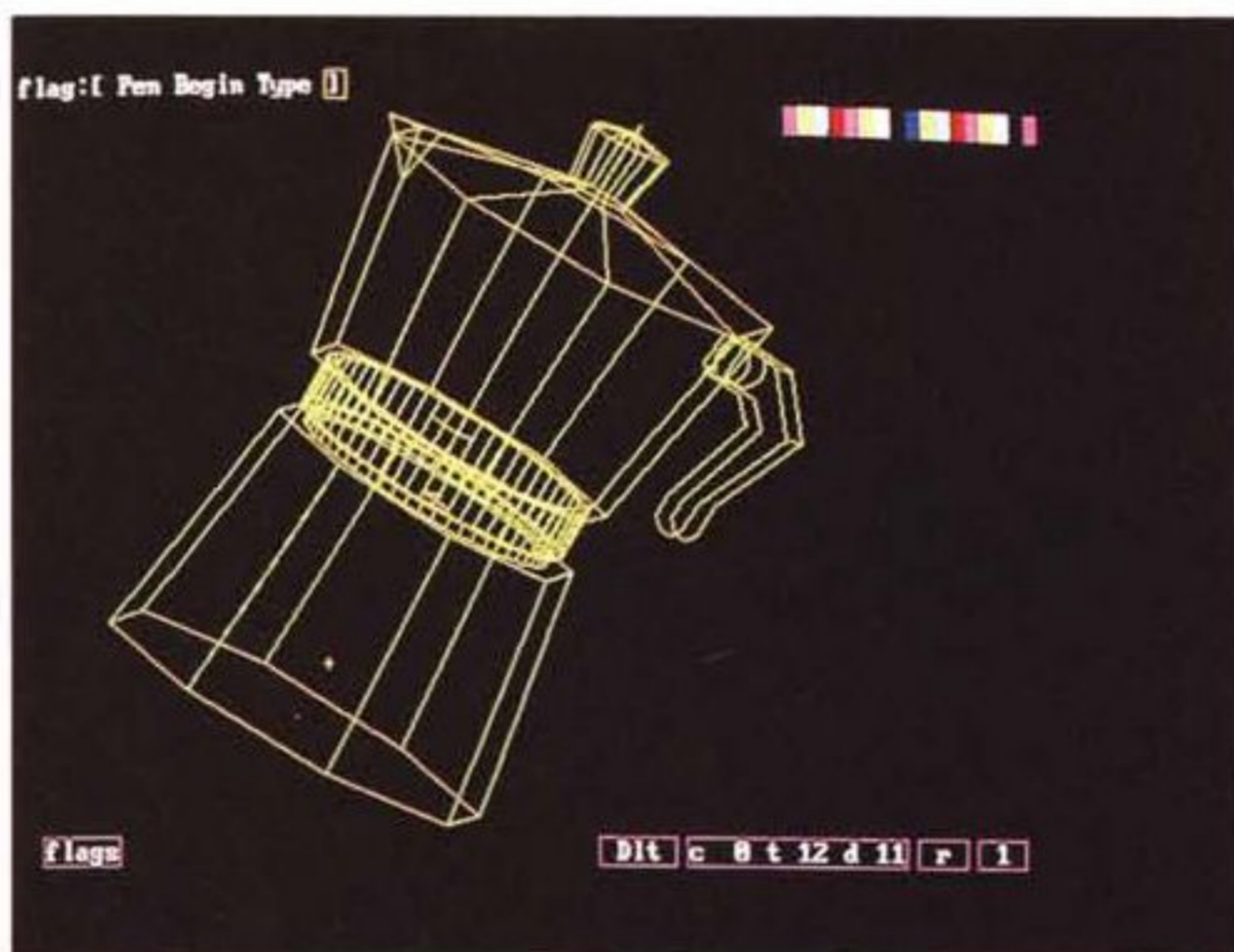
Figura 3 Vista assonometrica della Moka. Una doppia rotazione assonometrica, esponendo tutti i vertici, rende praticabile l'introduzione di elementi di completamento del progetto (per esempio: il manico o il coperchio) che possono essere elaborati a parte e rimanere agganciati al resto della figura di base tridimensionale.
