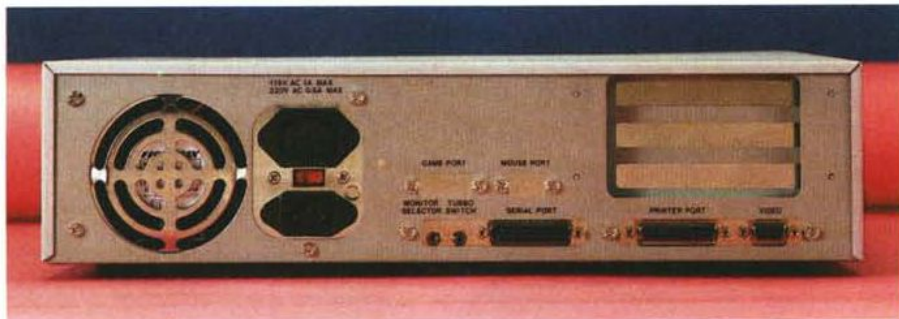
Il pannello posteriore comprende le varie interfacce e i tre slot di espansione.
