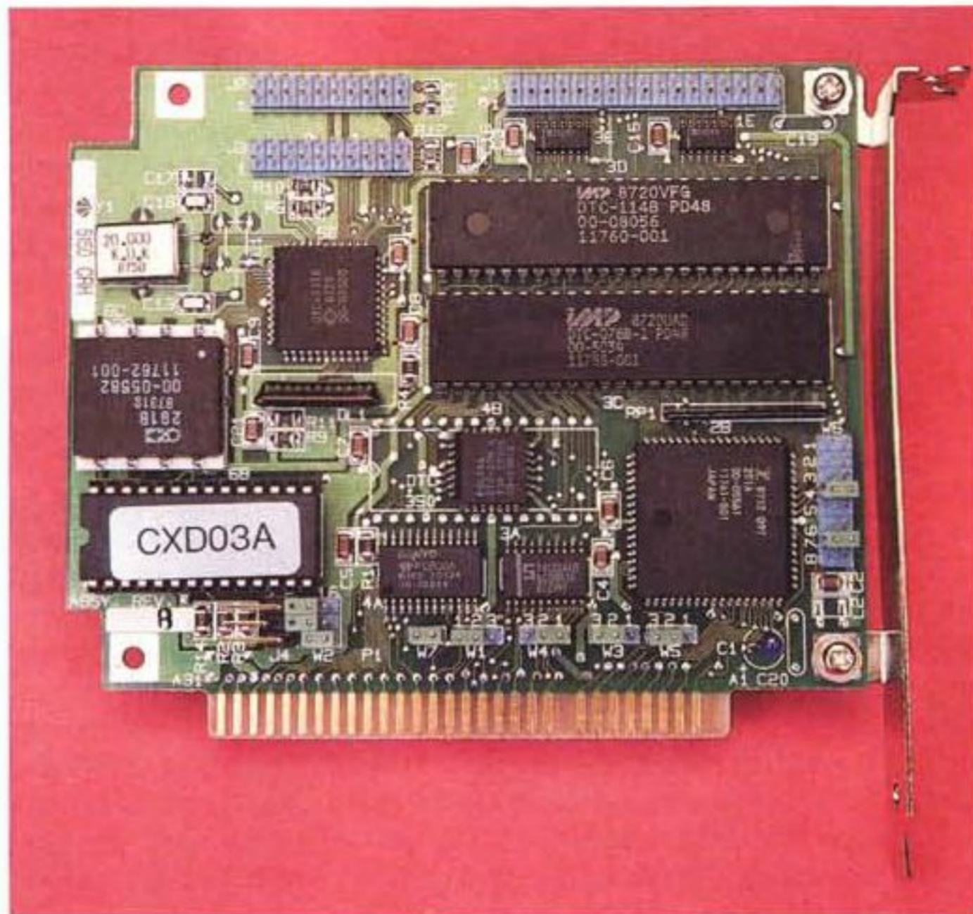
Il controller del disco rigido è realizzato su scheda «corta» grazie all'uso di tecnologie elettroniche ad alta densità.
