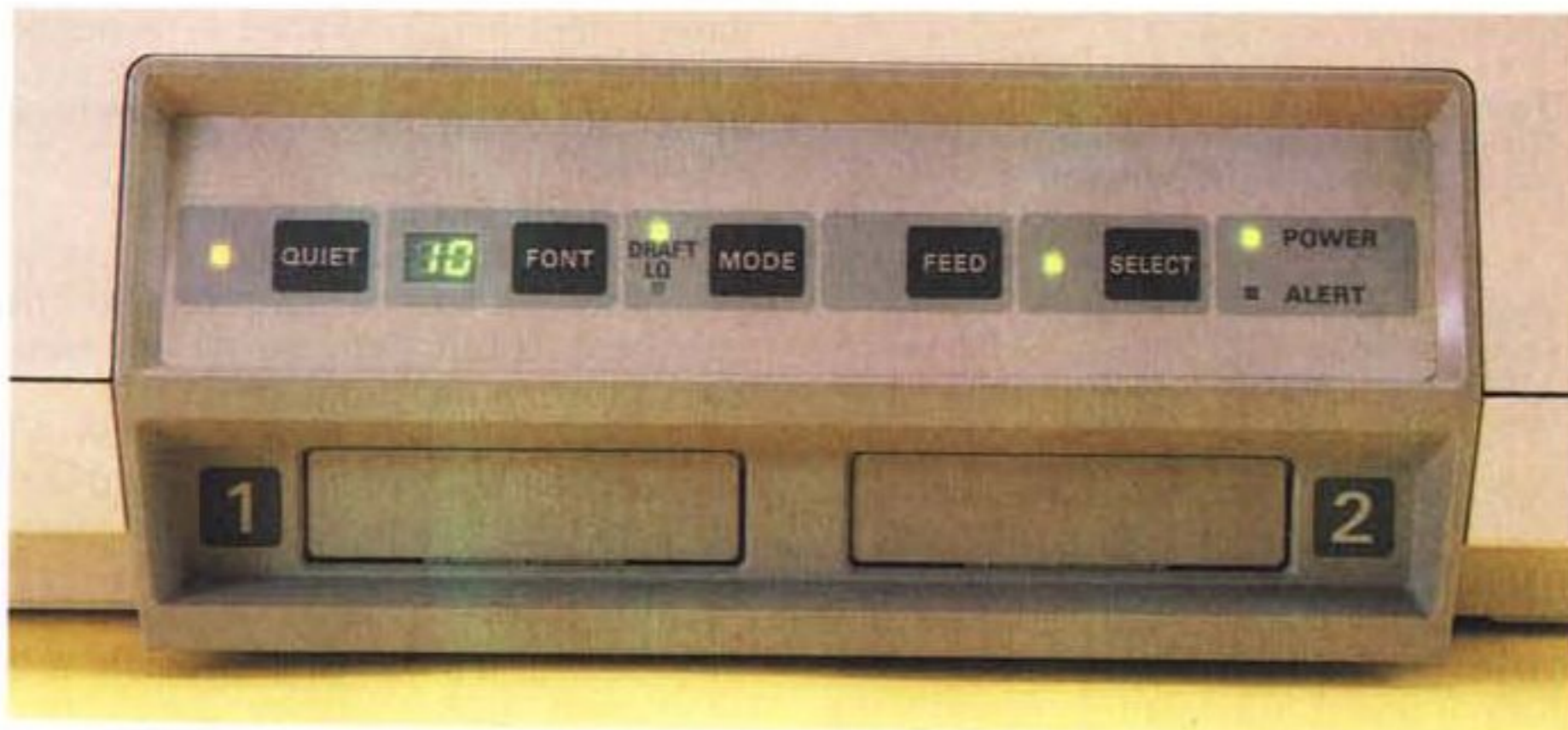
Il pannello frontale offre la selezione degli stili di stampa e la possibilità di inserimento delle cartucce di font opzionali; l'astina premi-carta può essere rimossa in funzione del tipo di nastro impiegato.
