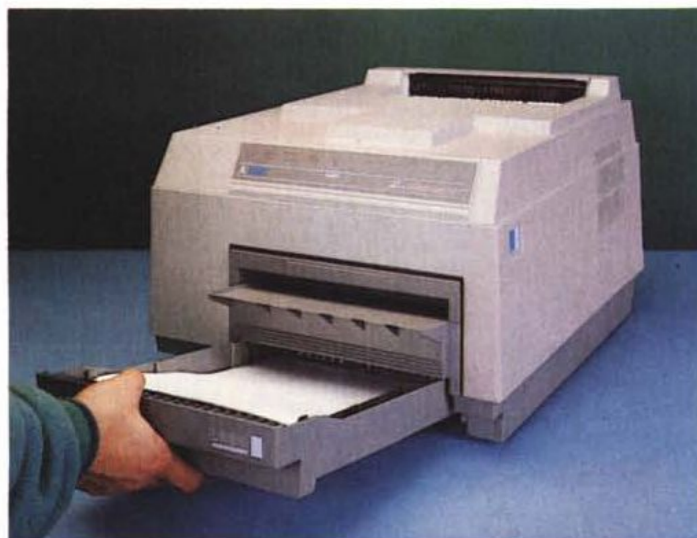
La stampante Laser Atari accetta fogli A4 dal cassetto di alimentazione o manualmente.
