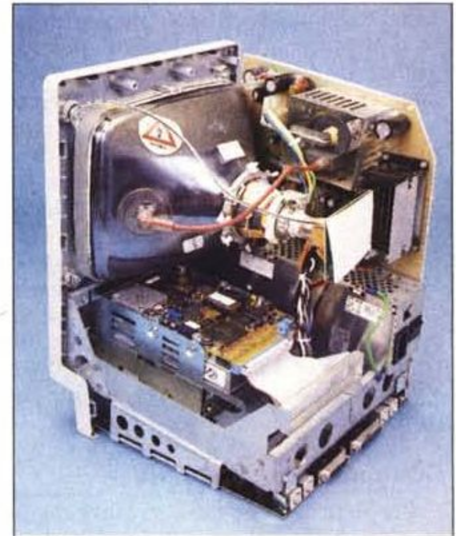
Il retro: in basso da destra a sinistra: due porte ADB, connettore drive esterno, connettore SCSI, due porte seriali per stampante e modem, jack mono per altoparlante. L'interruttore di accensione è ora diverso, più grosso. Da notare lo sportellino aperto, il quale permette la fuoriuscita di cavi all'esterno per le eventuali espansioni.
