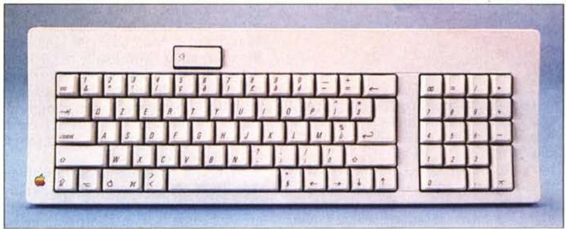
Tastiera: la tastiera italiana, tipo "Eastwood", è dotata di tasti cursore e tastierino numerico. Il grosso tasto in alto, che dovrebbe servire al reset, è inattivo.
