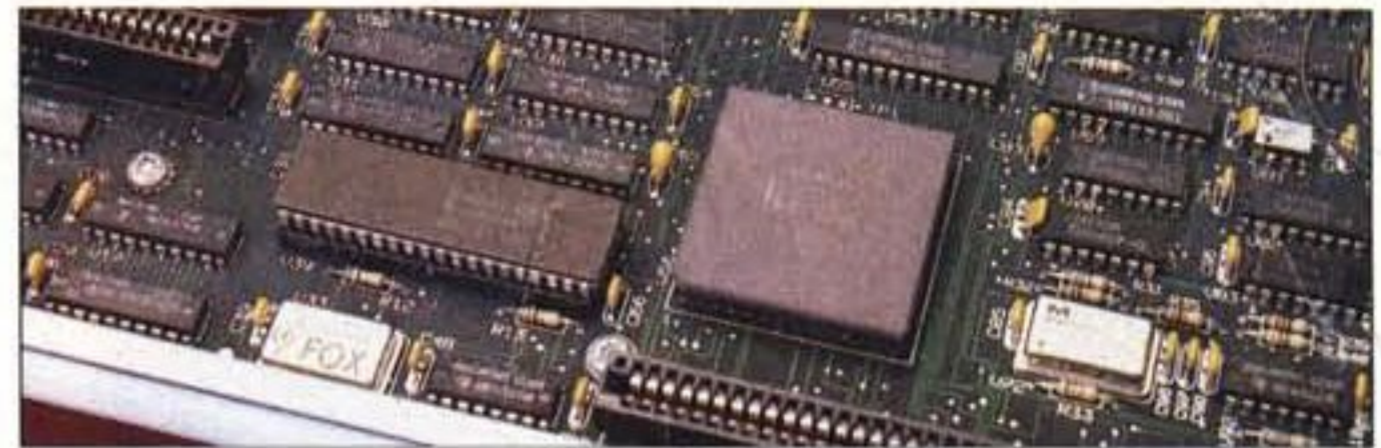
A sinistra, la scheda di memoria col relativo connettore a 32 bit. In alto, la EGA. Sotto, l'accoppiata 80386 - 80287.
