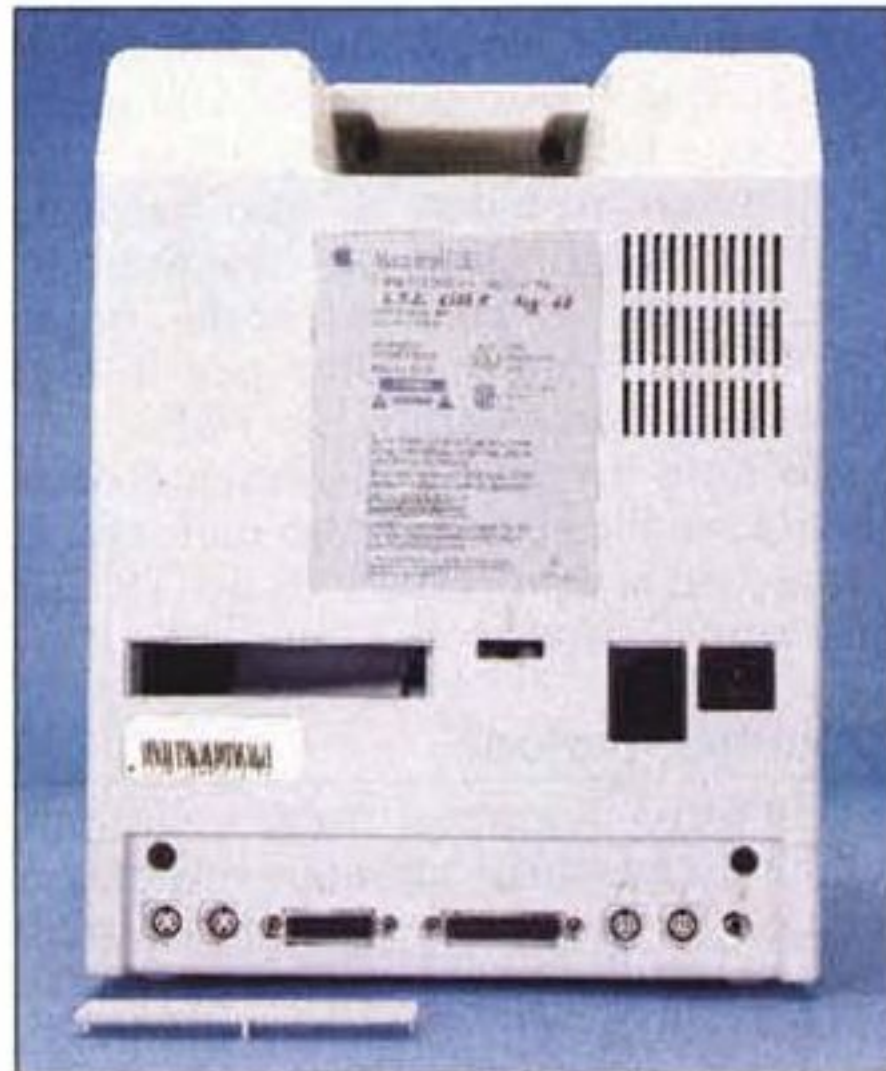
Il retro: in basso da destra a sinistra: due porte ADB, connettore drive esterno, connettore SCSI, due porte seriali per stampante e modem, jack mono per altoparlante. L'interruttore di accensione è ora diverso, più grosso. Da notare lo sportellino aperto, il quale permette la fuoriuscita di cavi all'esterno per le eventuali espansioni.
