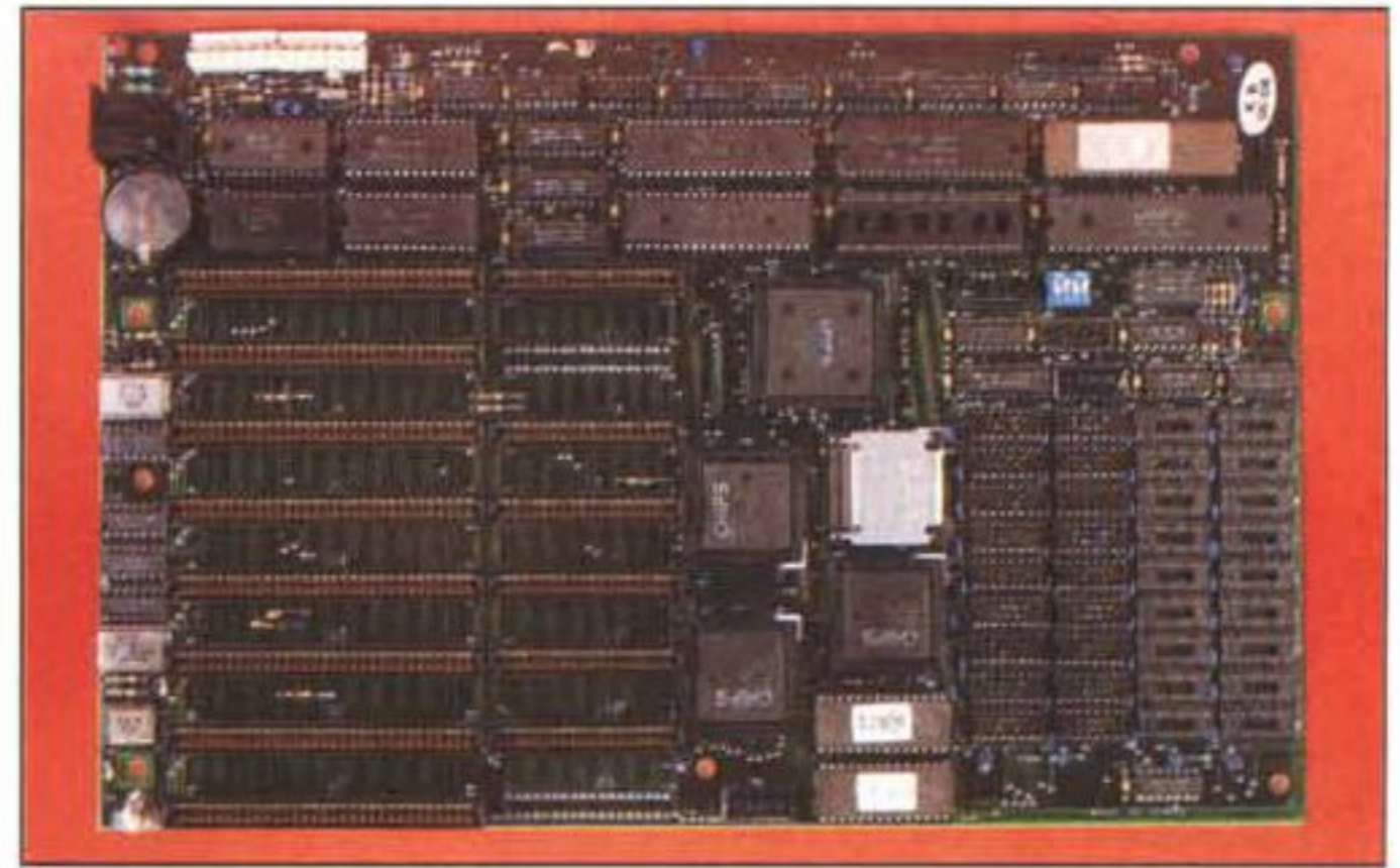
A sinistra una vista generale del computer aperto. Sopra, la scheda madre. Su quest'ultima sono evidenti il microprocessore 80286, i circuiti integrati VLSI e il banco della RAM, 1024 Kbyte di cui solo 512 installati.
