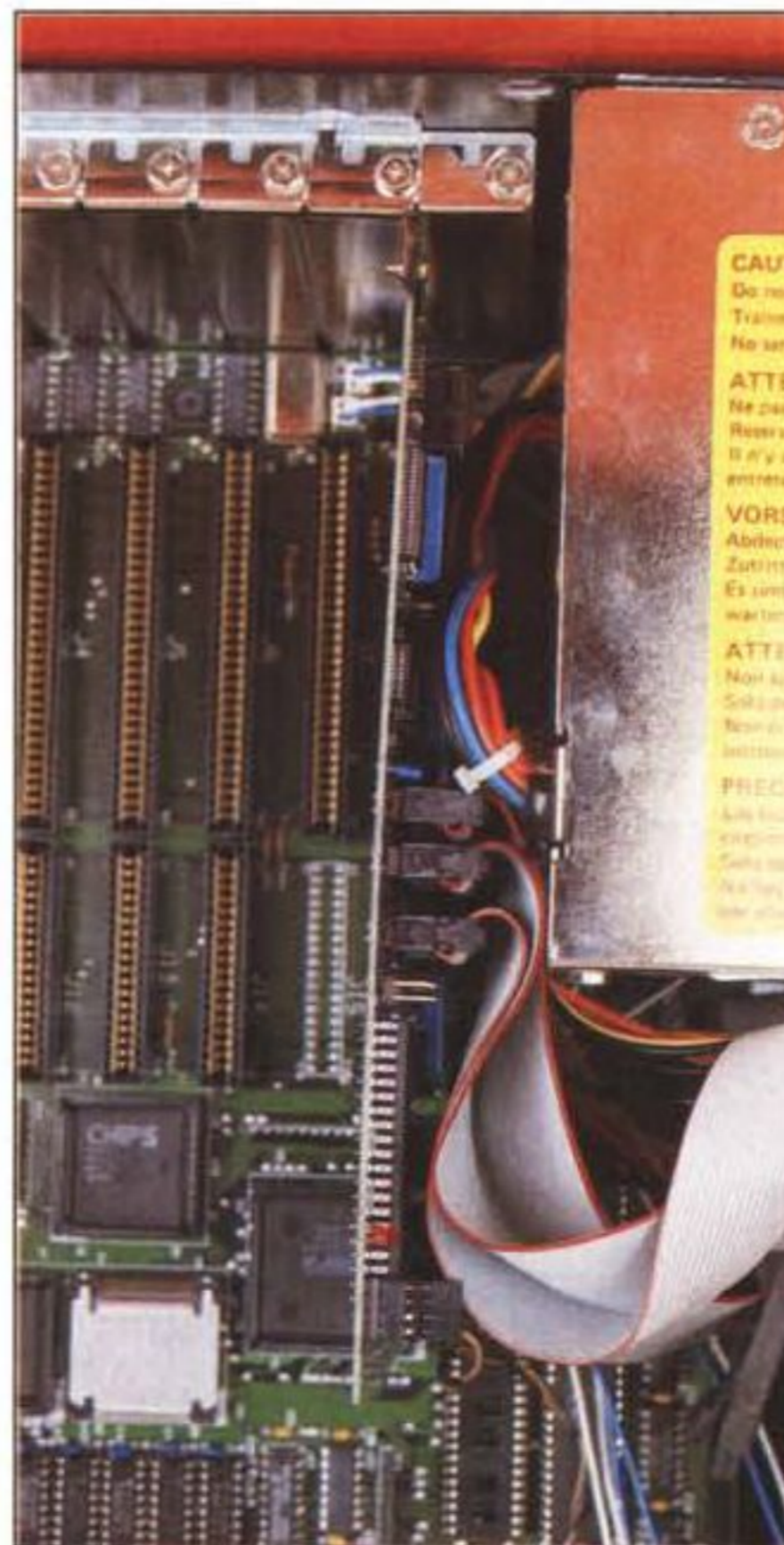
La scheda controller dei dischi purtroppo urta contro i cavi uscenti dall'alimentatore. Il tutto funziona perfettamente, ma la scheda rimane un po' flessa.
