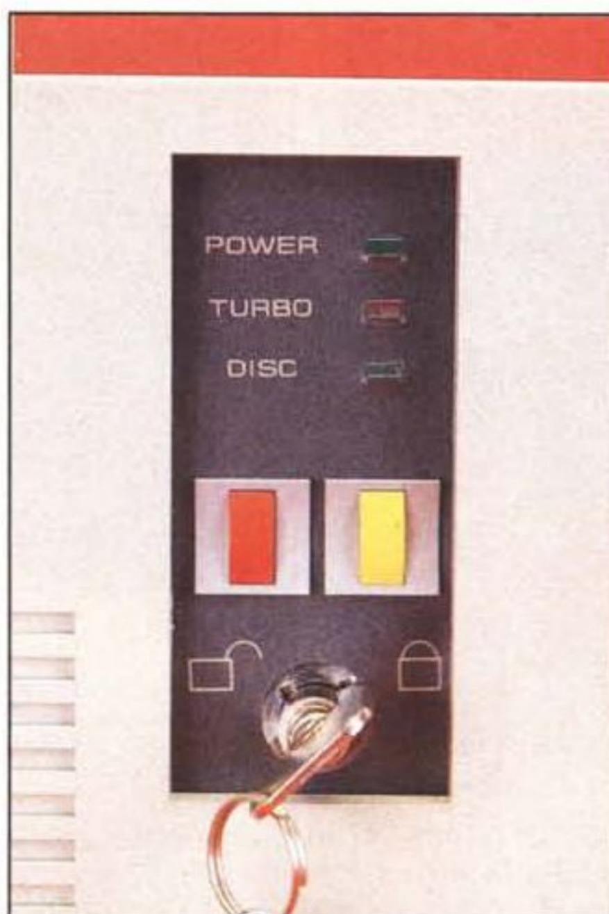
A sinistra, il pannello frontale del computer, con il pulsante di reset ed il commutatore della velocità del clock. Sopra, il bollino di controllo di produzione.
