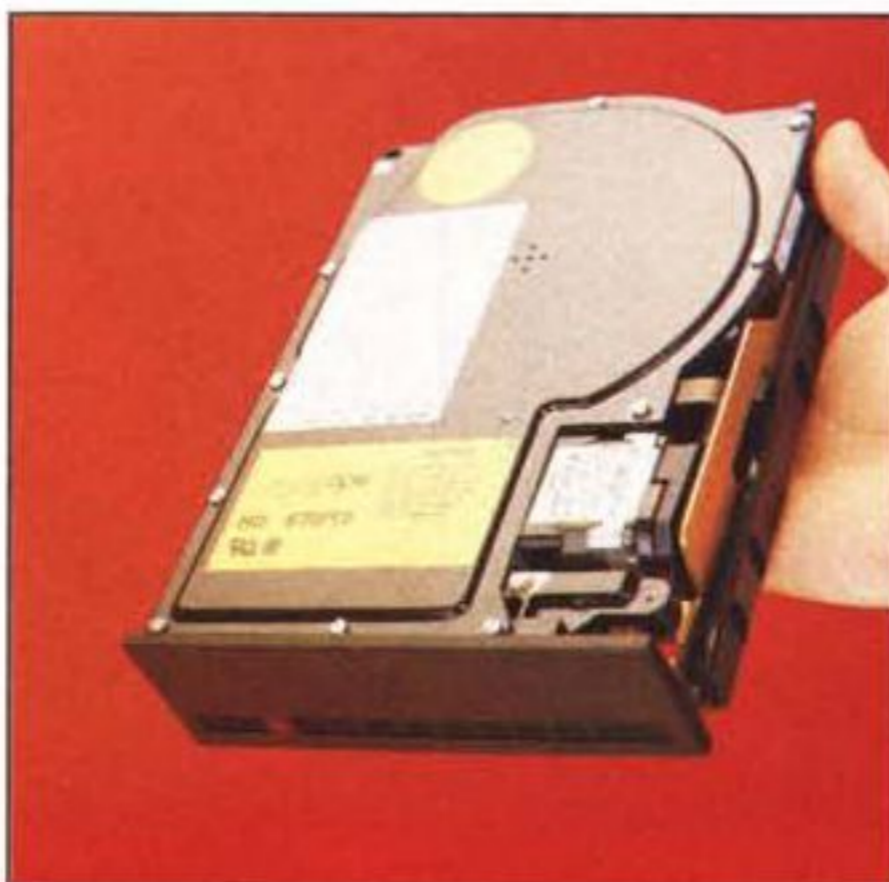
Il bel drive da 20 Mbyte veloce di produzione Olivetti OPE.
