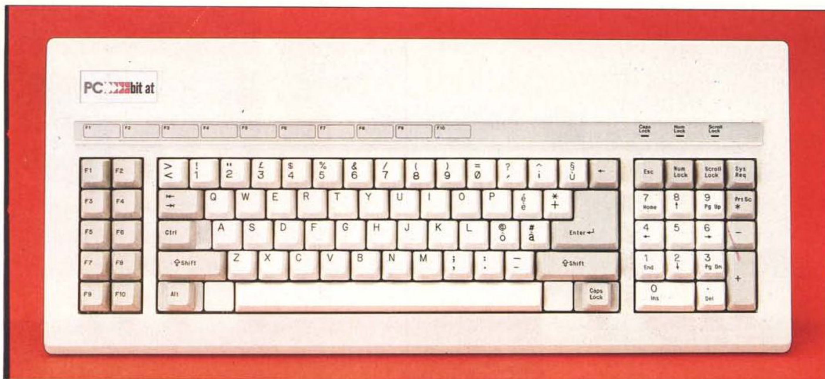
Primo piano sulla tastiera del PC bit at. La qualità è buona, la disposizione dei tasti uguale a quella originale IBM.
