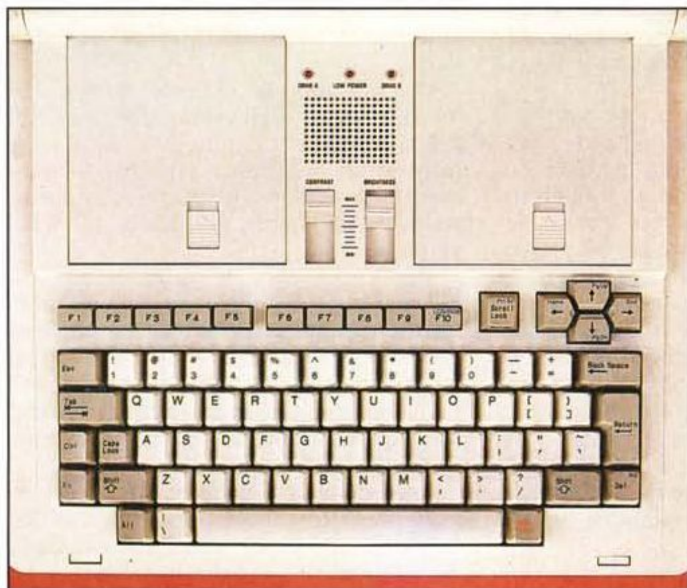
La tastiera dello Zenith con i due microfloppy drive in posizione operativa: la configurazione prevede una comoda borsa, alimentatore per le batterie ricaricabili e manuale operativo.
