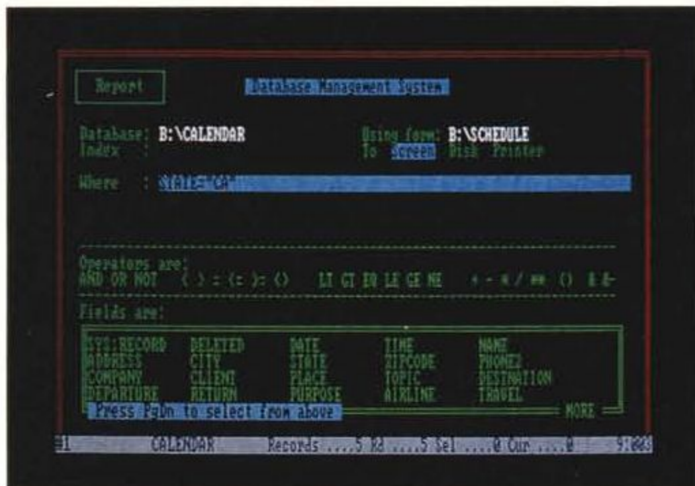
Figura 16 - Interact Form. Tutte le funzionalità di inquiry, che comportano cioè manipolazioni dell'archivio, avvengono tramite una struttura che permette di selezionare Archivio Dati, Archivio Indice (ovvero la sua organizzazione logica), Condizioni (Where), e campi visualizzati in out. Figura 17 - Report Form. Se il risultato di un'elaborazione è un tabulato si può usare la struttura REPORT, all'interno della quale è possibile inserire calcoli, formattati, ecc. In pratica non occorre scrivere un programma in quanto è la struttura REPORT che esegue l'elaborazione.
