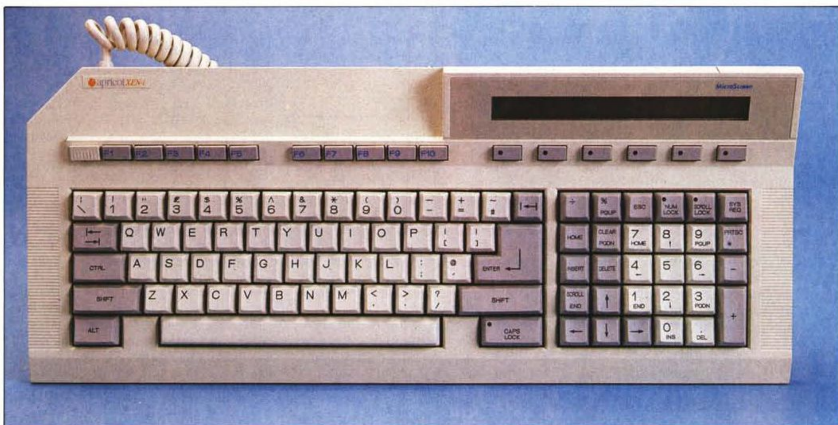
Primo piano della bellissima tastiera dello XEN-i; in pratica è la medesima dello XEN nella quale la disposizione di alcuni tasti è stata variata per avvicinarsi maggiormente a quella IBM. Notare che la tastiera in foto segue il layout per i simboli speciali.
