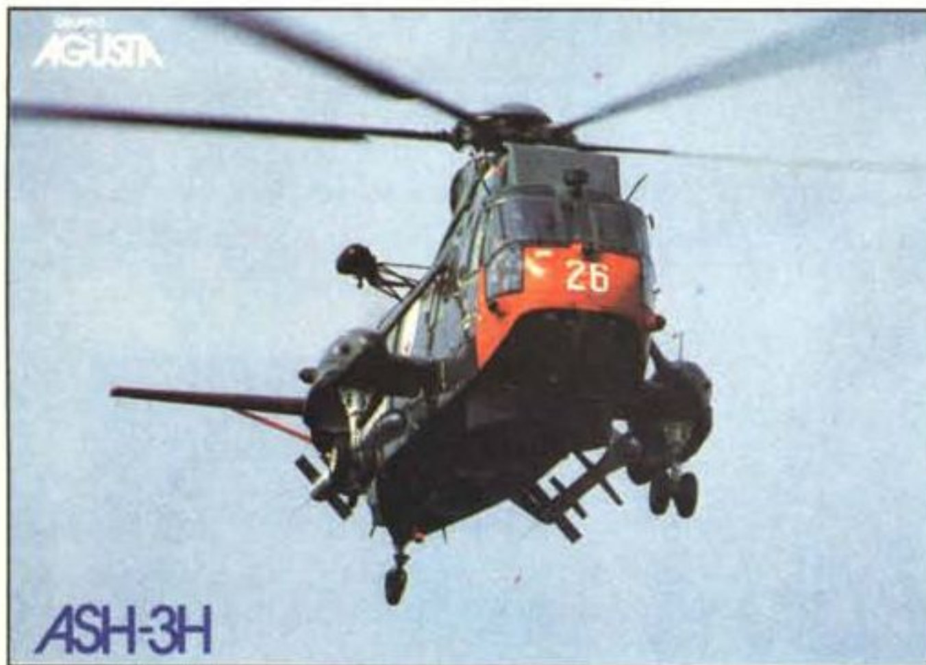
L'ASH-3H, la cui produzione era iniziata nei primi anni '60, verrà sostituito dall'EH 101. Nella foto si notano: il radar di scoperta (il cilindro nella pancia dell'elicottero); l'organo per il recupero di naufraghi (sul fianco destro); la protezione anti-ingestione di spruzzi ed uccelli marini (sopra la cabina di pilotaggio, davanti all'ingresso della turbina). Anche l'AS 61-R, versione SAR (Sea Air Rescue, soccorso aereo) dell'HH-3F, verrà sostituito dal corrispondente allestimento dell'EH 101.
