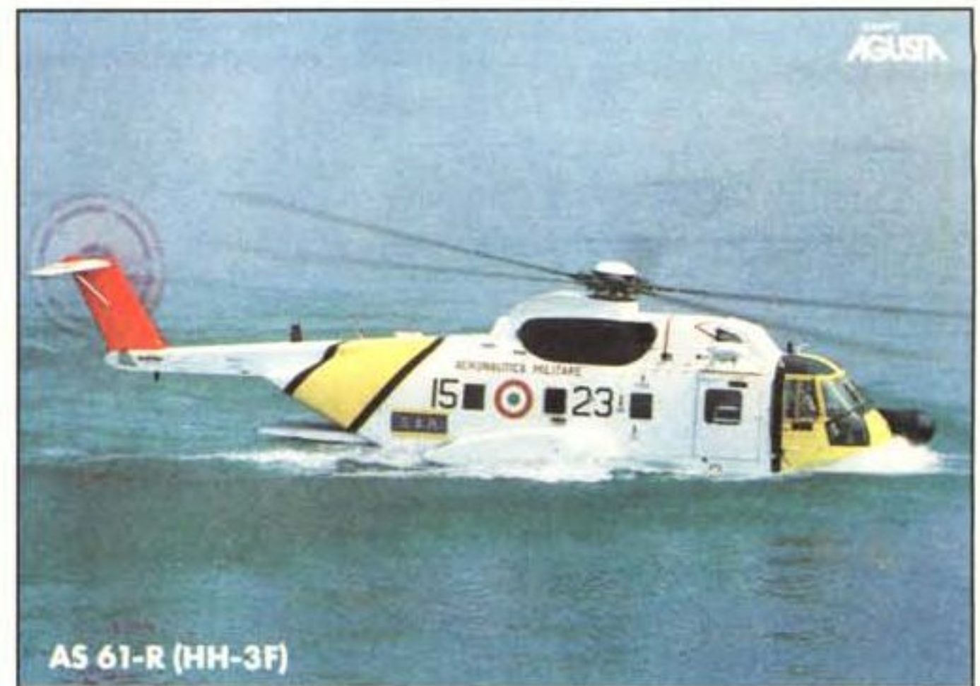
L'ASH-3H, la cui produzione era iniziata nei primi anni '60, verrà sostituito dall'EH 101. Nella foto si notano: il radar di scoperta (il cilindro nella pancia dell'elicottero); l'organo per il recupero di naufraghi (sul fianco destro); la protezione anti-ingestione di spruzzi ed uccelli marini (sopra la cabina di pilotaggio, davanti all'ingresso della turbina). Anche l'AS 61-R, versione SAR (Sea Air Rescue, soccorso aereo) dell'HH-3F, verrà sostituito dal corrispondente allestimento dell'EH 101.
