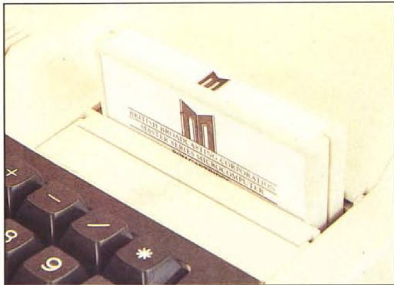
Altri due particolari della macchina. A sinistra la parte della motherboard su cui si trova il processore primario. A destra, il modo in cui si inseriscono le ROM esterne negli appositi alloggiamenti.
