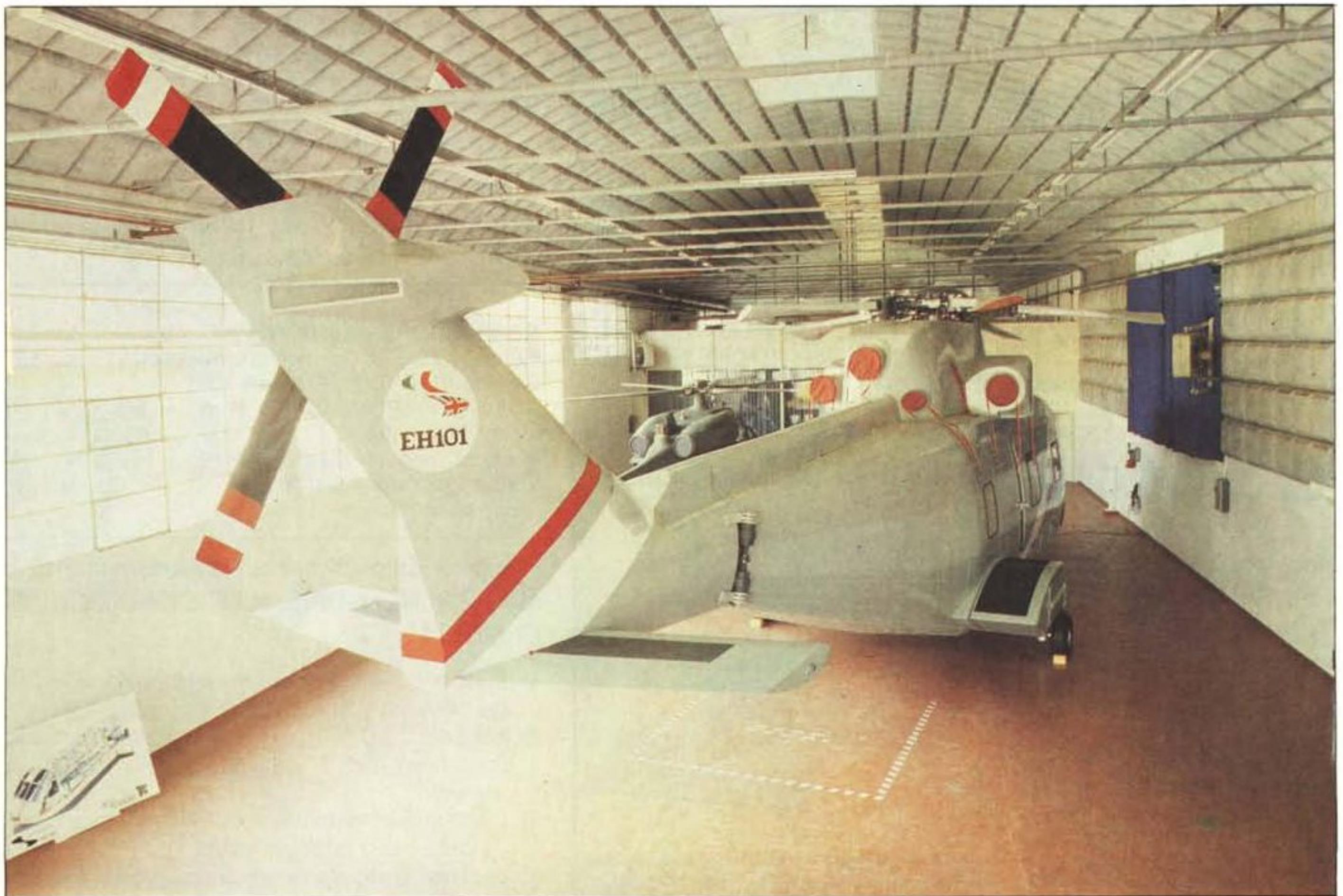
Il mock up dell'EH 101 in un hangar dello stabilimento dell'Agusta a Cascina Costa. Si possono valutare le dimensioni, veramente mastodontiche, dell'elicottero: 6,5 metri di altezza, 22,85 di lunghezza. Sullo sfondo si vede il mock up dell'A 129, l'elicottero d'attacco fabbricato sempre dall'Agusta. Nella foto si notano: lo snodo del troncone di coda che consente di ripiegare il velivolo per lo stivaggio a bordo delle navi; gli scarichi (coperti dalle protezioni rosse) dei tre motori GE T700 dell'EH 101 e quello della APU, turbinetta ausiliaria che fornisce l'energia elettrica quando, a terra, i motori principali sono fermi.
