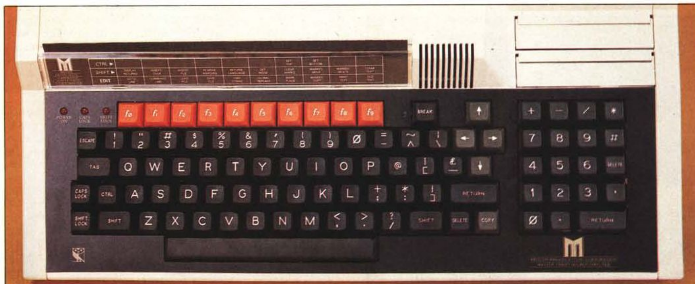
La tastiera del Master è piuttosto completa. In alto a destra si notano la griglia dell'altoparlante e i due slot per le ROM esterne.
