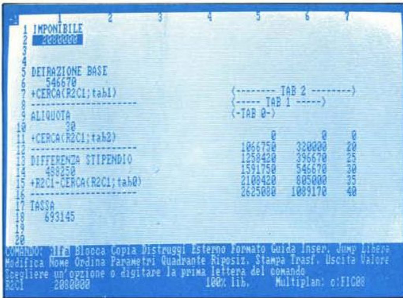
Figura 8 - Esempio della Funzione Cerca. L'esempio riportato dal manuale, è quello del calcolo delle detrazioni IRPEF di uno stipendio. Dato un valore «imponibile», questo viene confrontato con la prima colonna della tabella, sino a trovare un valore uguale o minore a quello dato. In questo modo si identifica la riga.
