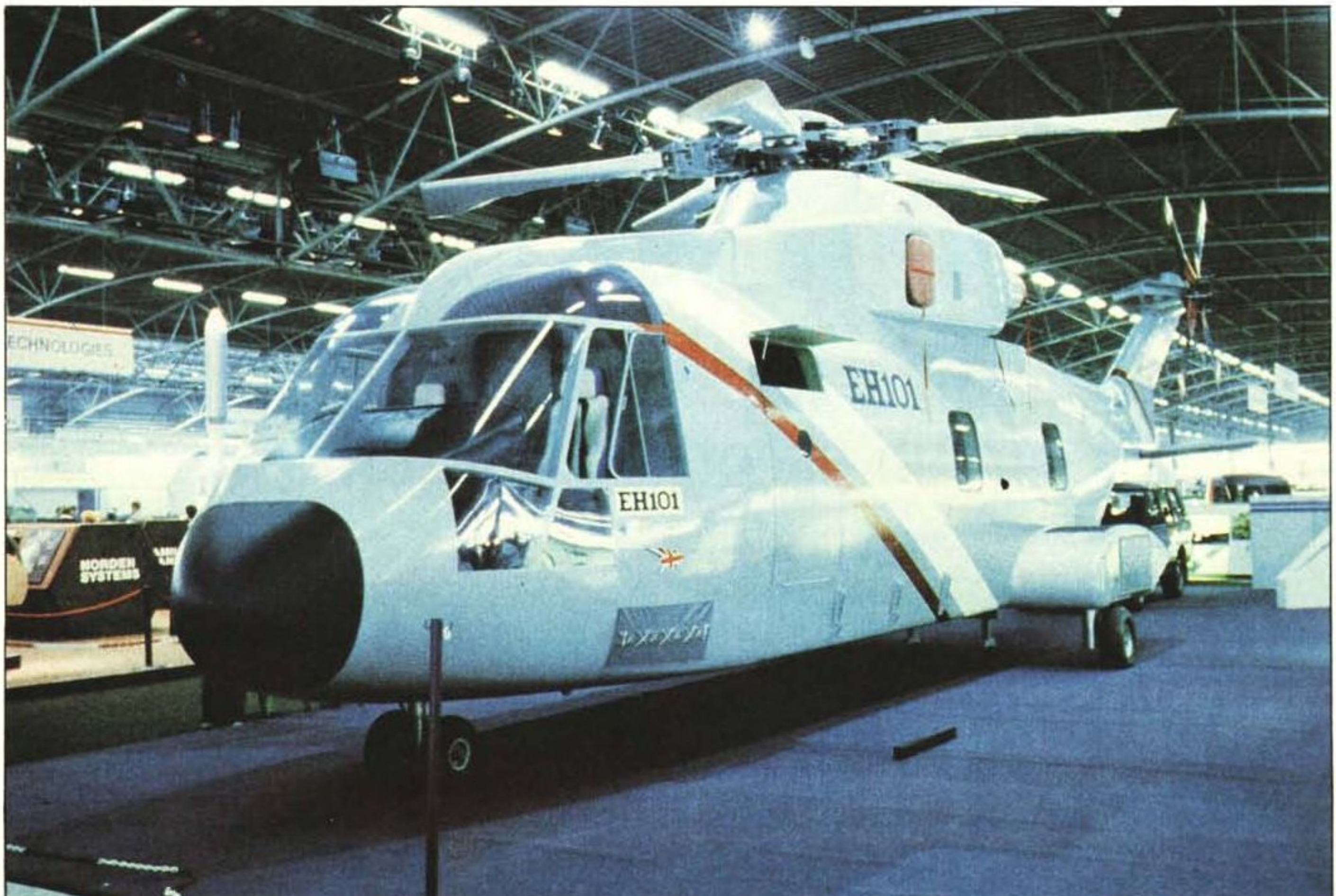
Il mock up (modello a grandezza naturale) dell'EH 101 al Salone Aeronautico di Le Bourget, con i colori della European Helicopter Industries. Si vedono, nel cockpit (cabina di pilotaggio), i sedili del pilota e del TACCO con davanti (nero) il cruscotto che contiene i display grafici sui quali vengono presentati i dati di volo e di missione.
