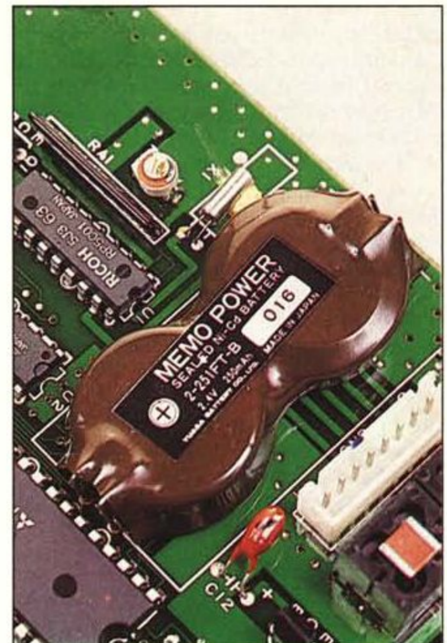
La batteria in tampone per l'orologio interno. È visibile il circuito integrato RP5CO1.
