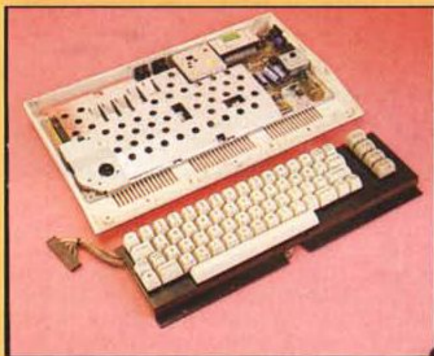
Il nuovo Commodore 64 C: estetica rinnovata ed interno sostanzialmente identico alle versioni precedenti. Si nota il lamierino metallico di schermatura e la notevole somiglianza con il C 128.
