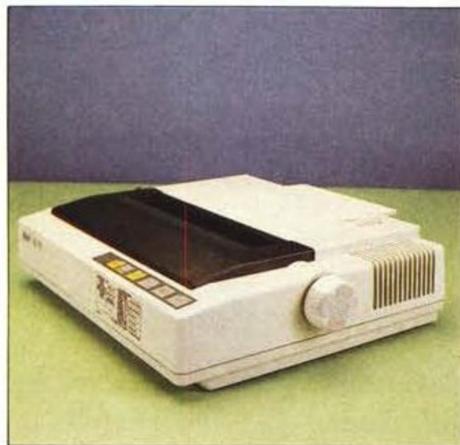
La NL-10 in posizione Tractor Feed, col piano di plastica che funge da separatore della carta. Il ripiano, in posizione verticale, serve da supporto per il foglio singolo quando si sfrutta la possibilità dell'inserimento automatico.
