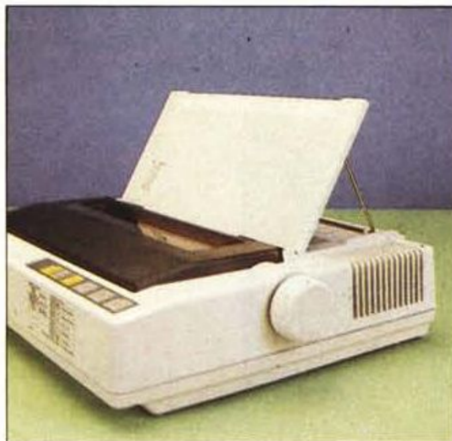
La NL-10 in posizione Tractor Feed, col piano di plastica che funge da separatore della carta. Il ripiano, in posizione verticale, serve da supporto per il foglio singolo quando si sfrutta la possibilità dell'inserimento automatico.
