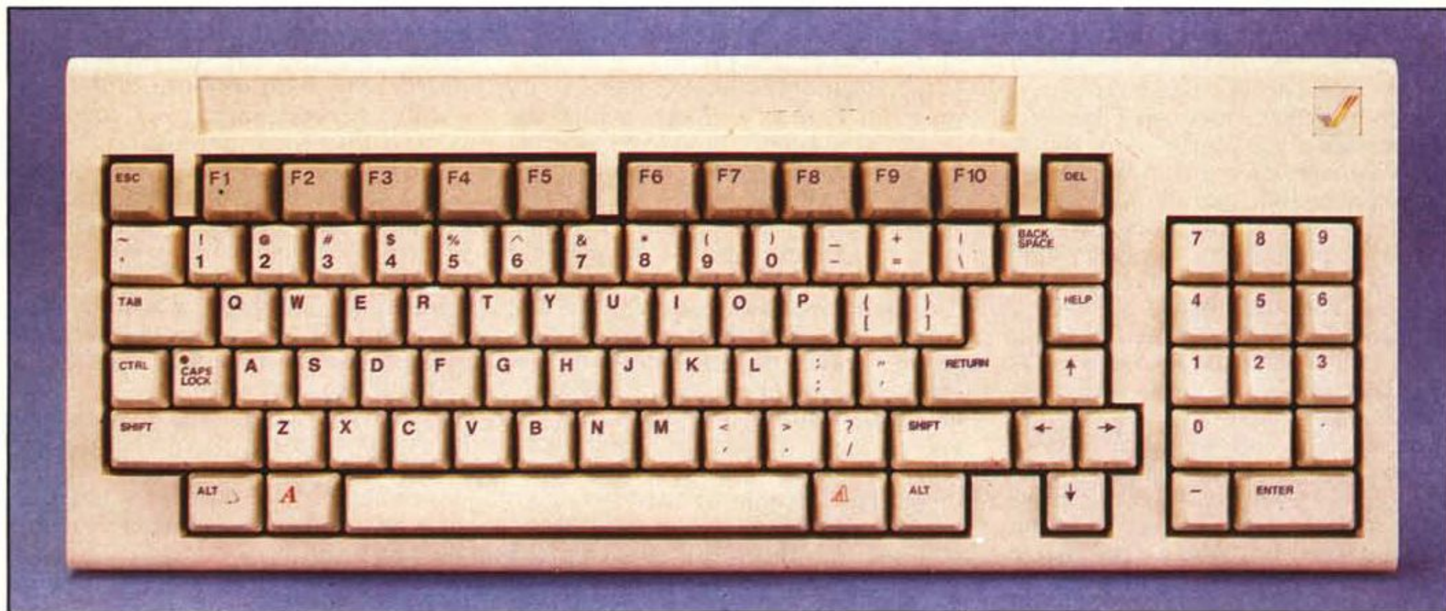
La tastiera ha un aspetto professionale, con 89 tasti e 10 tasti funzione e il tastierino numerico. Vi sono i tasti cursore ed il caps-lock è dotato di led.
