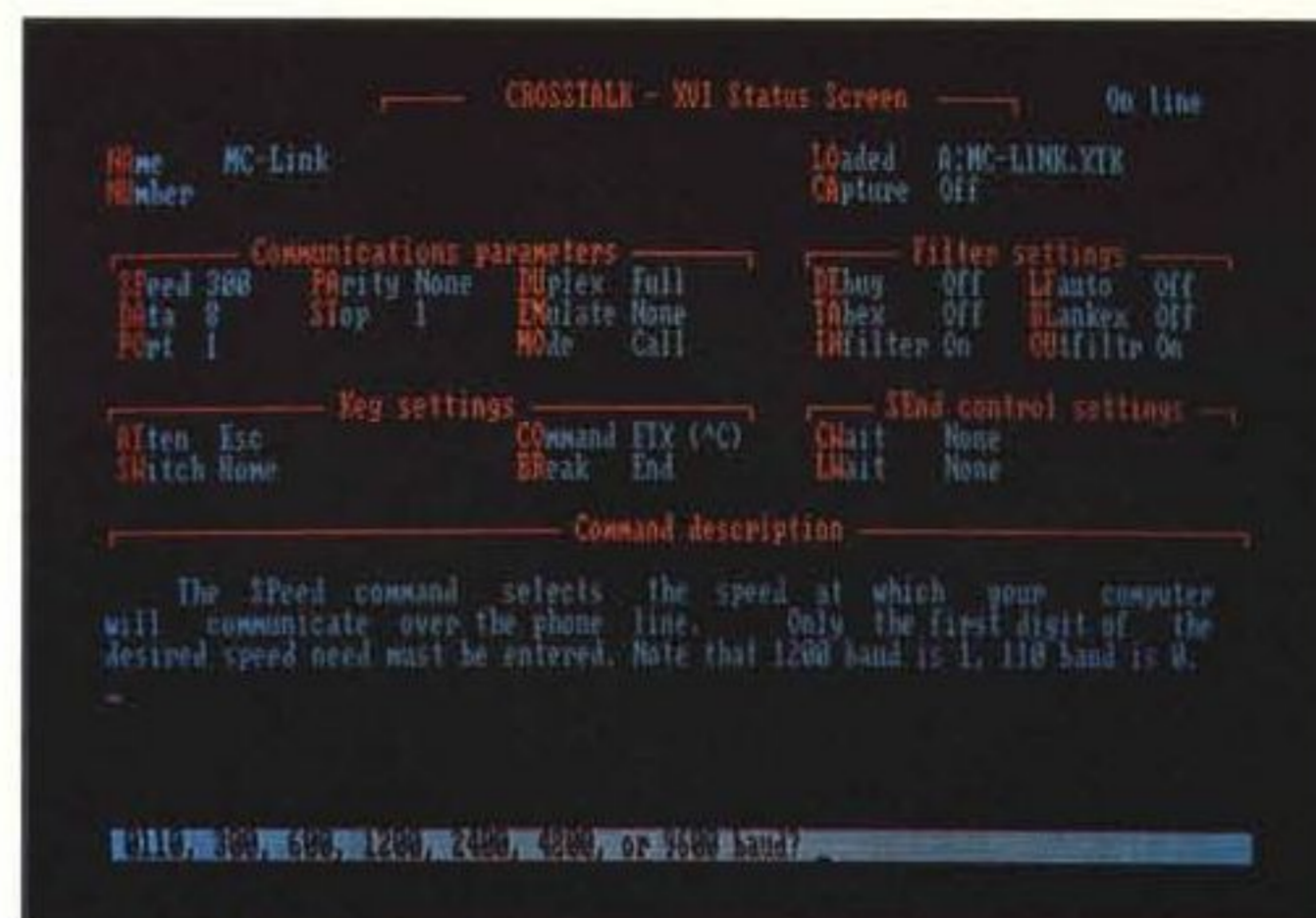
Vediamo come si impostano i parametri principali in Mite ed in CrossTalk. A sinistra il menu P di Mite, a destra lo schermo di stato del CrossTalk in seguito ad una richiesta di variazione della velocità (comando SPEED).
