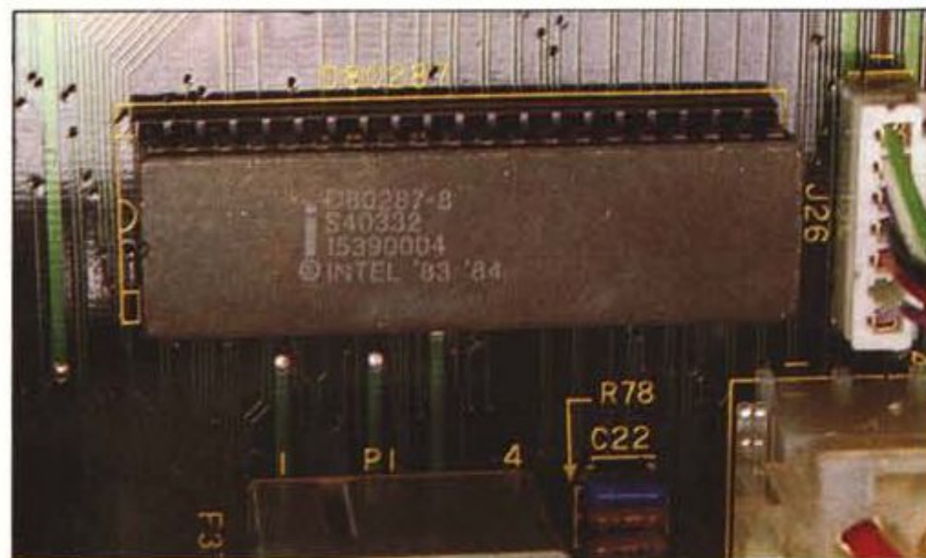
Sopra una vista d'insieme dello Sperry aperto. La disposizione delle parti è tradizionale, l'assemblaggio di buona qualità. In alto a destra un particolare della serratura di sicurezza. A destra, il coprocessore matematico 80287 nel suo alloggiamento.
