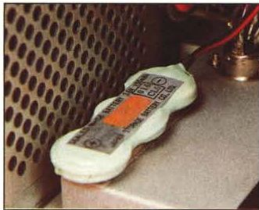
Due particolari dell'interno. A sinistra l'accumulatore che alimenta l'orologio interno. A destra il banco delle RAM. 1 Mbyte on board.
