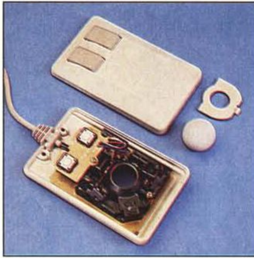
Il mouse aperto, con la sfera gommata e lo sportellino per la pulizia di quest'ultima.
