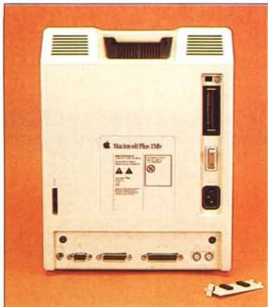
Il retro del computer. In alto a destra si nota il vano per la pila di back-up.
