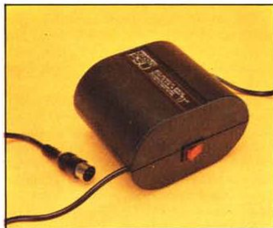
Il trasformatore di alimentazione è dotato di un utilissimo interruttore luminoso di accensione.
