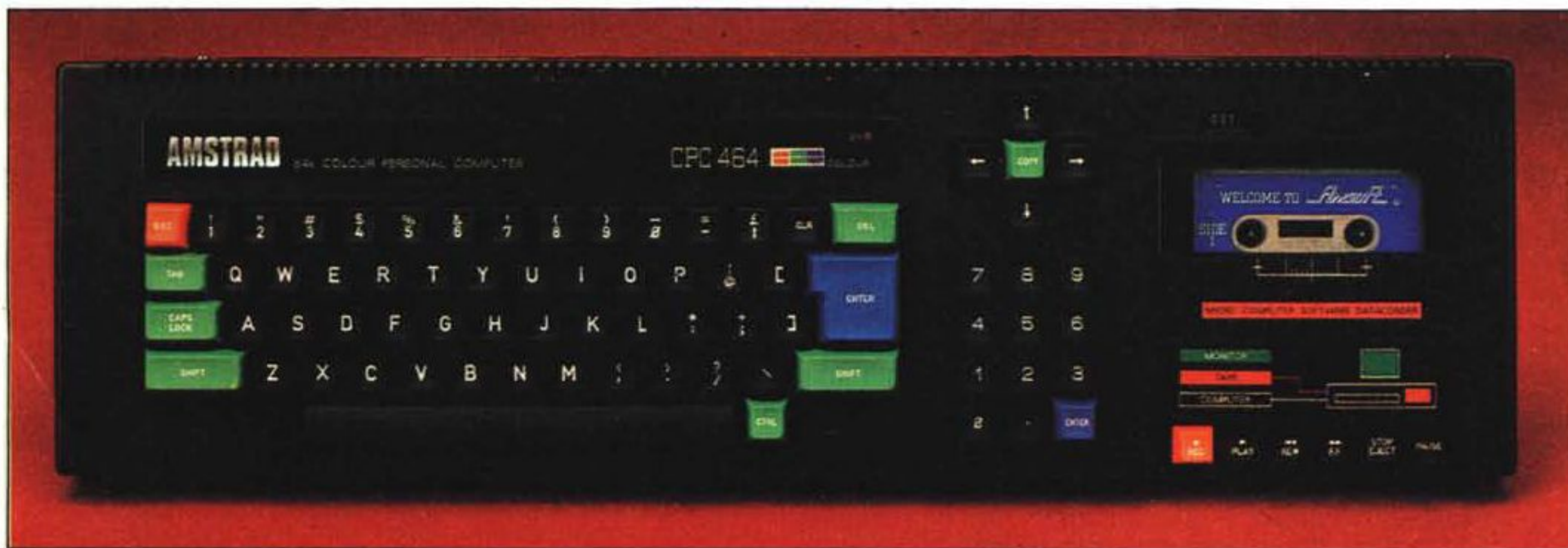
La tastiera è completa di paddle numerico e controllo separato del cursore. Finalmente il registratore è incorporato.
