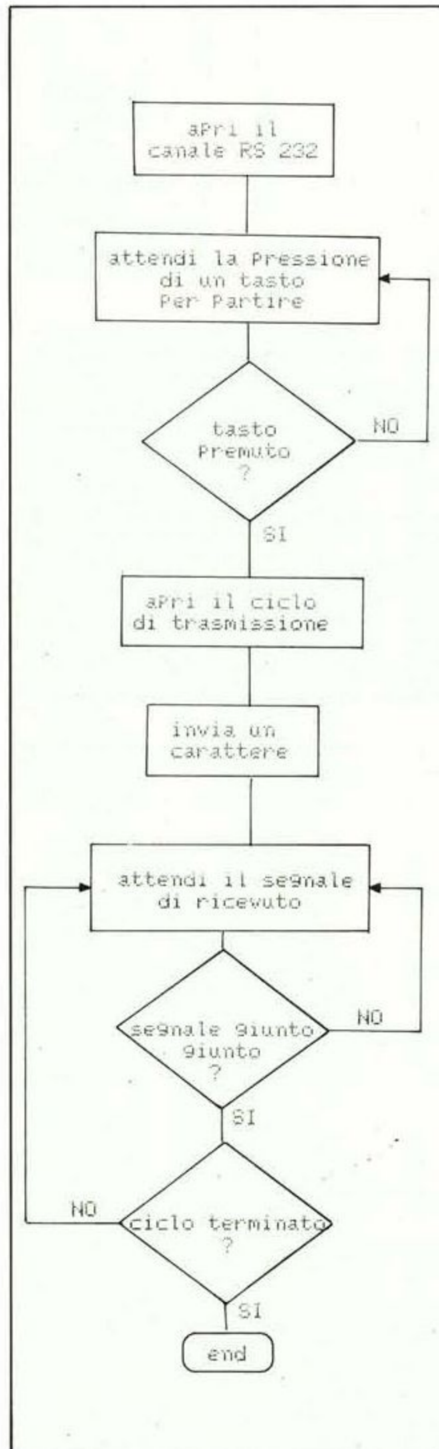
Figura 4 - Diagramma di flusso di una ricezione sincronizzata da un carattere di controllo.
