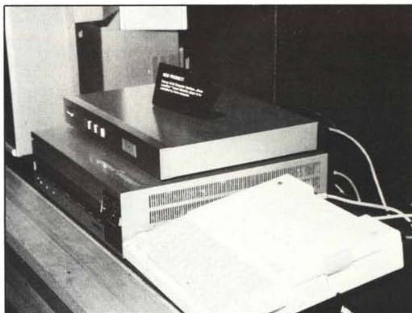
Figura 10 - Giugno 1984; interfaccia RS-232 per Laser Disc Pioneer LD-V700.
