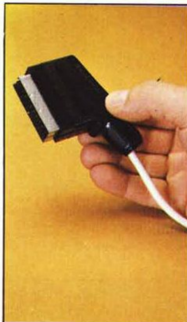
Retro del televisore Philips modello Manet: sono visibili l'ingresso d'antenna, l'uscita per la cuffia e il connettore SCART; il pulsantino rosso serve per selezionare l'ingresso SCART. La foto di destra mostra l'originale connettore, fatto in modo da impedire inserimenti errati.
