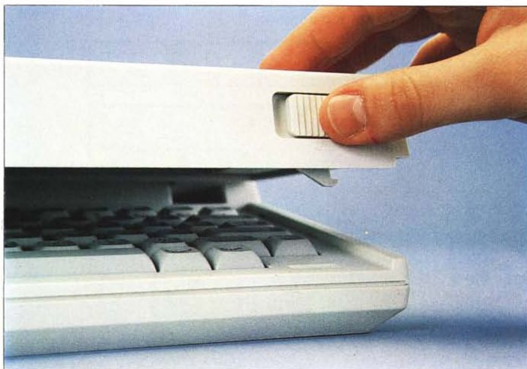
L'apertura della macchina. I ganci delle cerniere a molla vanno ad incastrarsi in appositi alloggiamenti della tastiera.
