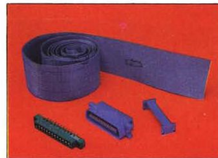
Foto 1 - Il cavo da 36 conduttori e i due connettori, uno per la stampante e l'altro per il 64, sono gli elementi-base del cavo. Per chi ha un minimo di esperienza il lavoro può essere completato da un cappello plastico a coprire il connettore del 64, oppure da guaine termorestringenti intorno alle saldature.
