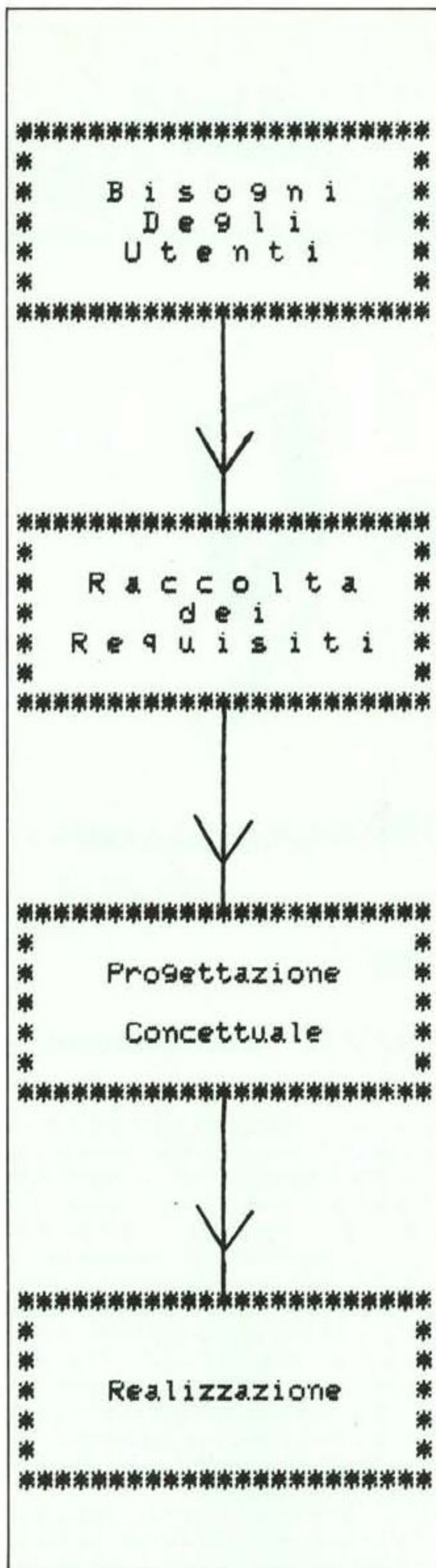
Figura 3 - L'installazione di una Base di Dati, per qualsiasi applicazione, coinvolge più fasi. Si parte dai Bisogni degli Utenti: ciò che i committenti della Base vogliono automatizzare. Il primo vero e proprio passo è la raccolta dei Requisiti: in questa fase si analizzeranno le procedure (manuali) già esistenti, estraendo da queste il comportamento che dovrà avere il sistema da realizzare. La Progettazione Concettuale serve per dare una definizione precisa della Base di Dati: è in questa fase che si partoriscono i vari schemi (fig. 1). A questo punto si è pronti per la realizzazione vera e propria: a partire dal linguaggio di programmazione specifico per Basi di Dati di cui si dispone, si traducono in programmi e procedure tutti gli schemi progettati al passo precedente.
