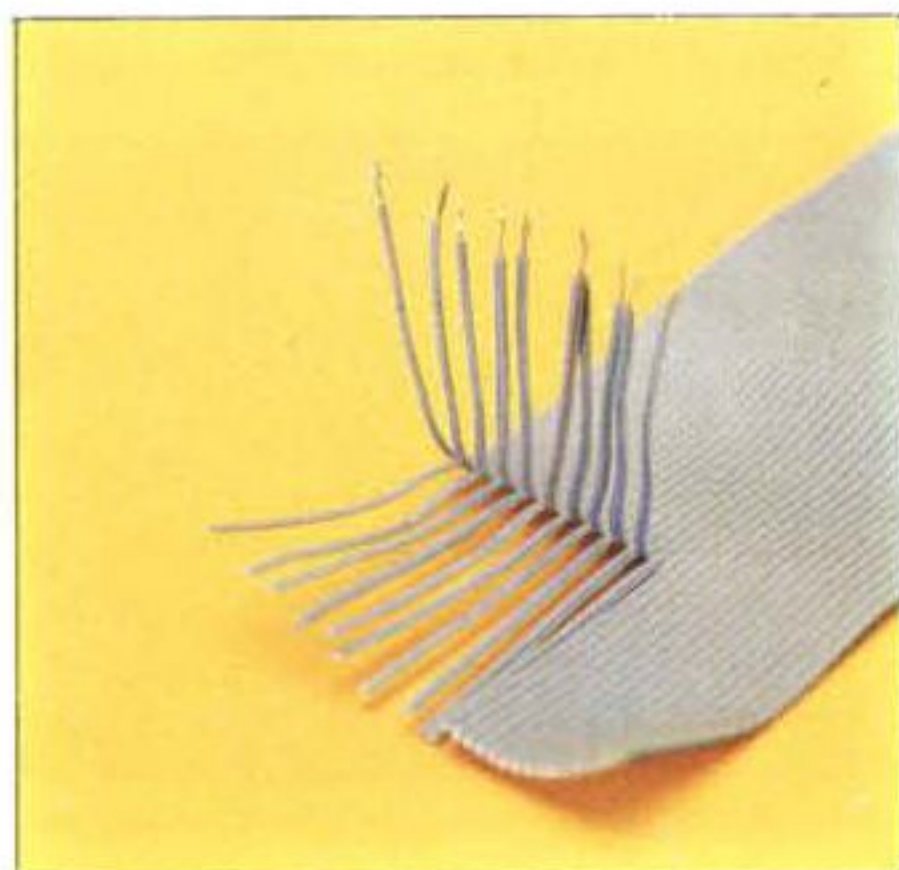
Foto 3 - Gli opportuni filetti vanno spellati per una lunghezza massima di 5 mm (possibilmente qualcosa meno) e attorcigliati in modo da far corpo unico.
