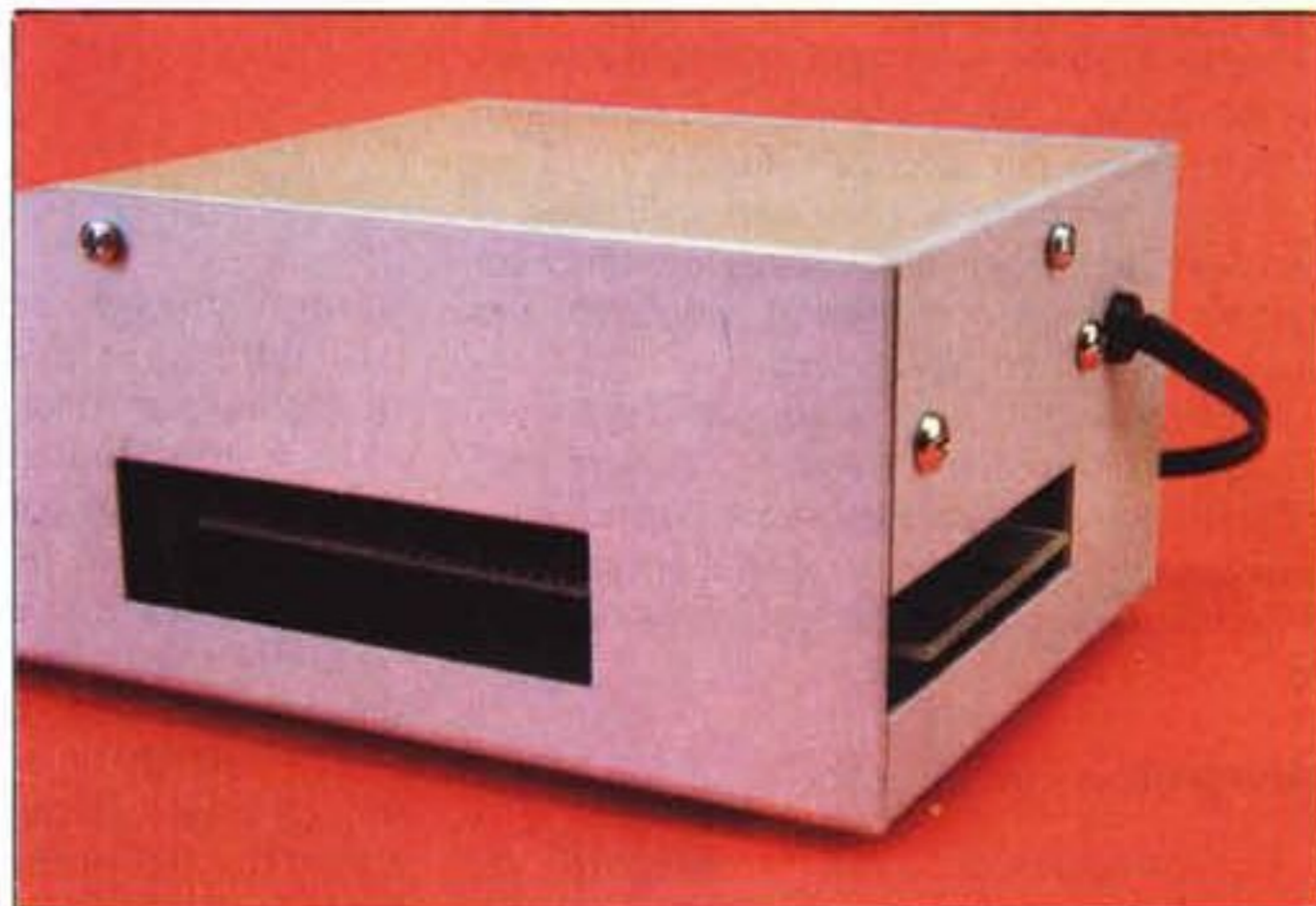
L'hardware dell'interfaccia. A destra, il connettore per il collegamento alla stampante e quello delle espansioni.
