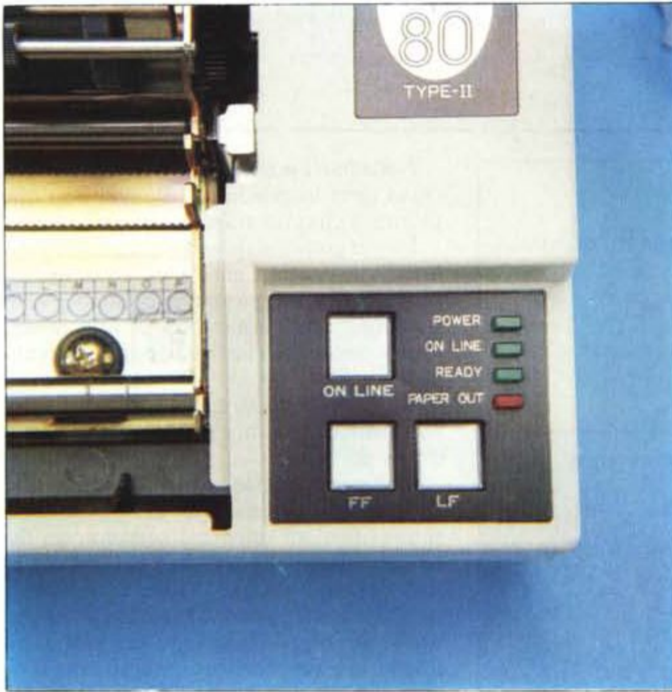
Il pannellino di controllo.
