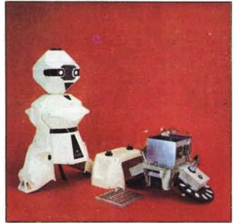
Alcuni particolari di Topo. Notare a sinistra l'headswitch: premendo su uno dei quattro lati si comprime lo strato di spugna posto fra la parte fissa e la basetta su cui sono installati i quattro pulsanti: viene quindi azionato uno di essi. A nostro parere si sarebbe potuta adottare una soluzione più semplice ed efficace; il funzionamento dell'headswitch ci è parso infatti un po' precario. Al centro, uno dei due motori; notare la rotellina forata del generatore tachimetrico.
