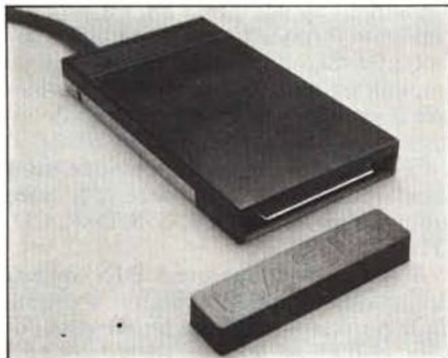
L'espansione per i floppy-disk da 5 pollici è composta dalle due unità controller (a sinistra) e drive (a destra).
