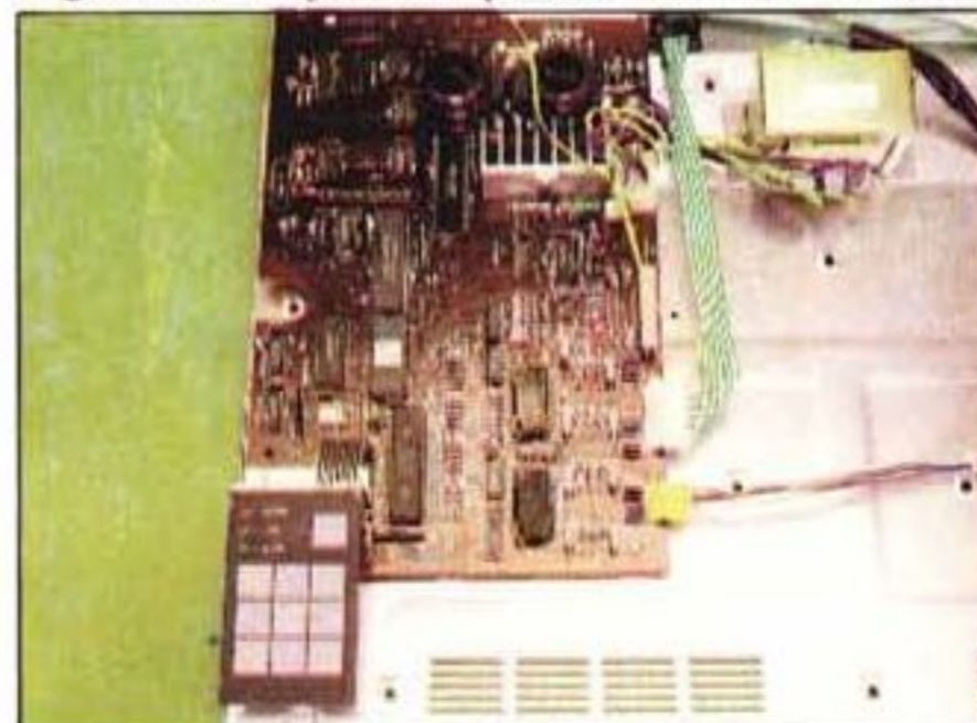
La scheda elettronica; tutta l'elettronica, compresa l'interfaccia, è sistemata su un'unica scheda. Si notano il microprocessore Z80, prodotto dalla Sharp, e la grossa ROM.
