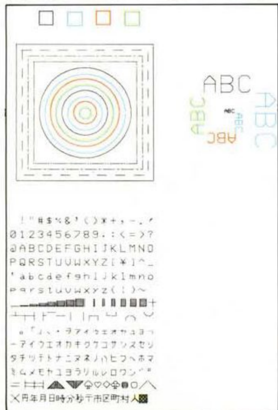
Fig. 5 - Output dell'auto-test eseguito dal miniplotter FP-1011
