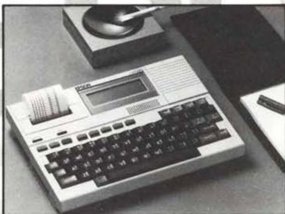
EPSON HX 20: computer portatile, stampante e display incorporati, 16 KBytes RAM min., microcassette, grafico....
