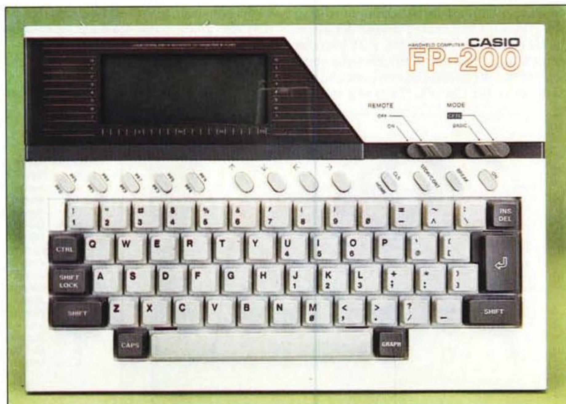
Vista d’insieme del Casio FP-200: una tastiera molto agevole, abbinata ad un display-grafico LCD dell’ultima generazione.
