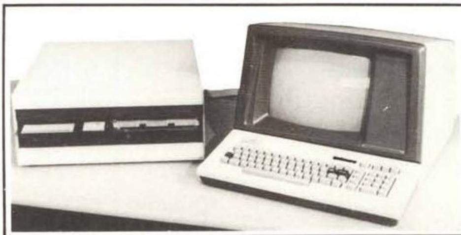
2 Megabytes su 2 drives 8 pollici - 64 K RAM - CPU Z80A - Display 2000 caratteri con linea di status - Tastiera 78 tasti con pad numerico e funzioni - Sistema operativo CP/M - IBM compatibile - Supporta tutti i linguaggi - Espandibile fino a 20 Megabytes
