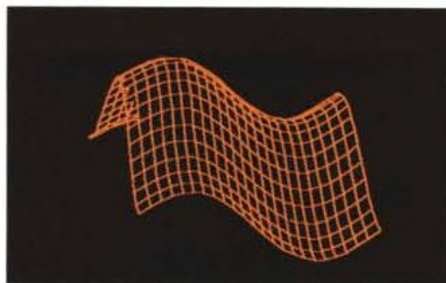
Figura 7 e 8 - Output del programma di lettura e visualizzazione - Sono evidenti le imperfezioni, citate nel testo, relativamente alle linee seminascoste. Queste si verificano nelle zone di margine e di flesso della curva spaziale.
