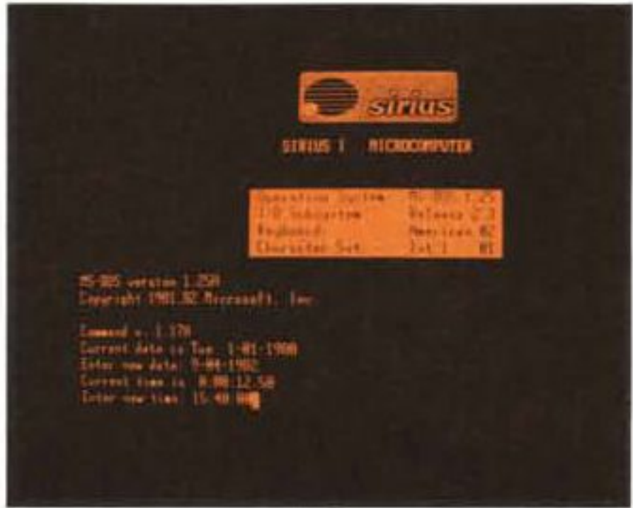
L'avvenuto caricamento del sistema operativo è segnalato da una bella immagine comprendente il "logo" Sirius I e alcune informazioni riguardanti la configurazione sia del software che dell'hardware (tastiera e set di caratteri). Qui si vede il "prompt" dell'MS-DOS, un sistema operativo che annovera la caratteristica di segnalare, nella directory, la data nella quale ciascun file è stato per l'ultima volta utilizzato. A tale scopo è necessario initialize l'orologio ad ogni accensione della macchina poiché manca un orologio con batterie in tampone.
