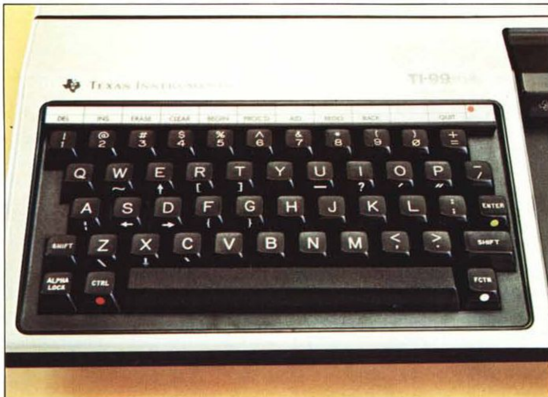
La tastiera QWERTY a 48 tasti. Notare i caratteri speciali realizzati come seconde funzioni e la prima riga di tasti definibili.
