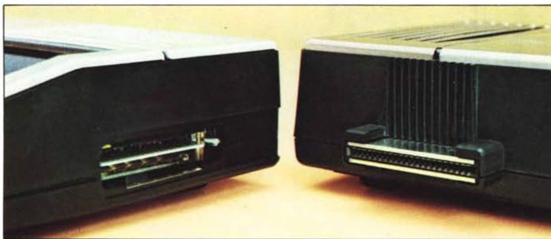
Il connettore a pettine con cui avviene il collegamento con le espansioni. A sinistra l'unità centrale, a destra il disk controller.
