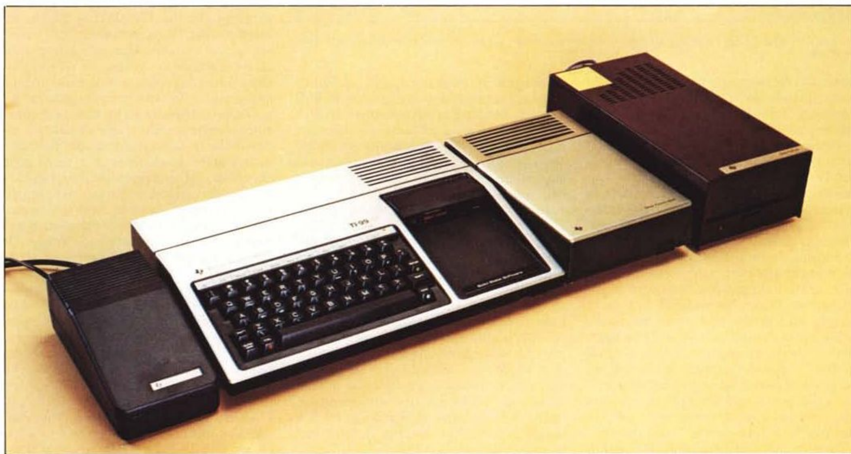
Da sinistra: trasformatore, unità centrale, disk controller, disk drive; altre espansioni allungherebbero la fila.
