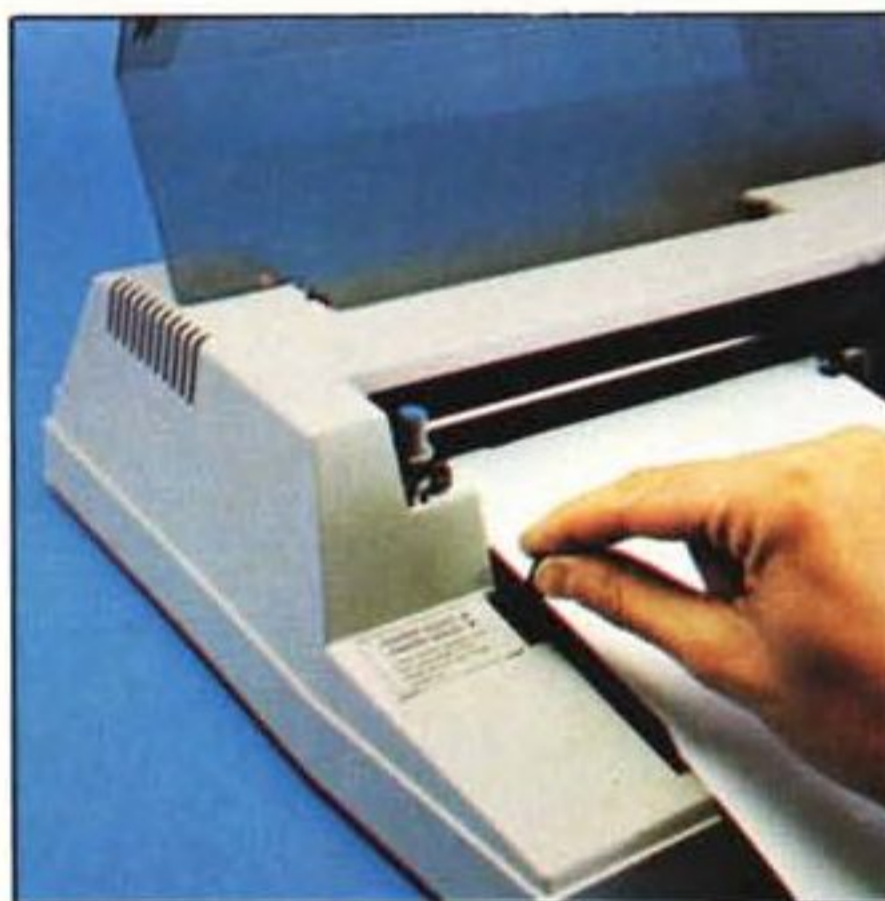
Una volta introdotta la carta tra il capstan ed il rullo pressore basta abbassare la levetta per fissarla saldamente al plotter.
