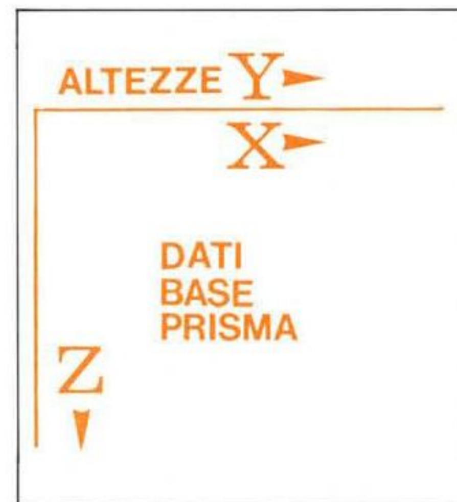
Figura 5 - Per l'input dei dati tridimensionali l'area del digitizer è divisa in due zone. La zona per l'input dei dati della base dove X = X_{dig.} , Z = Y_{dig.} e zona input dati altezze; se Y_{dig.} è minore di zero allora Y = X_{dig.}
