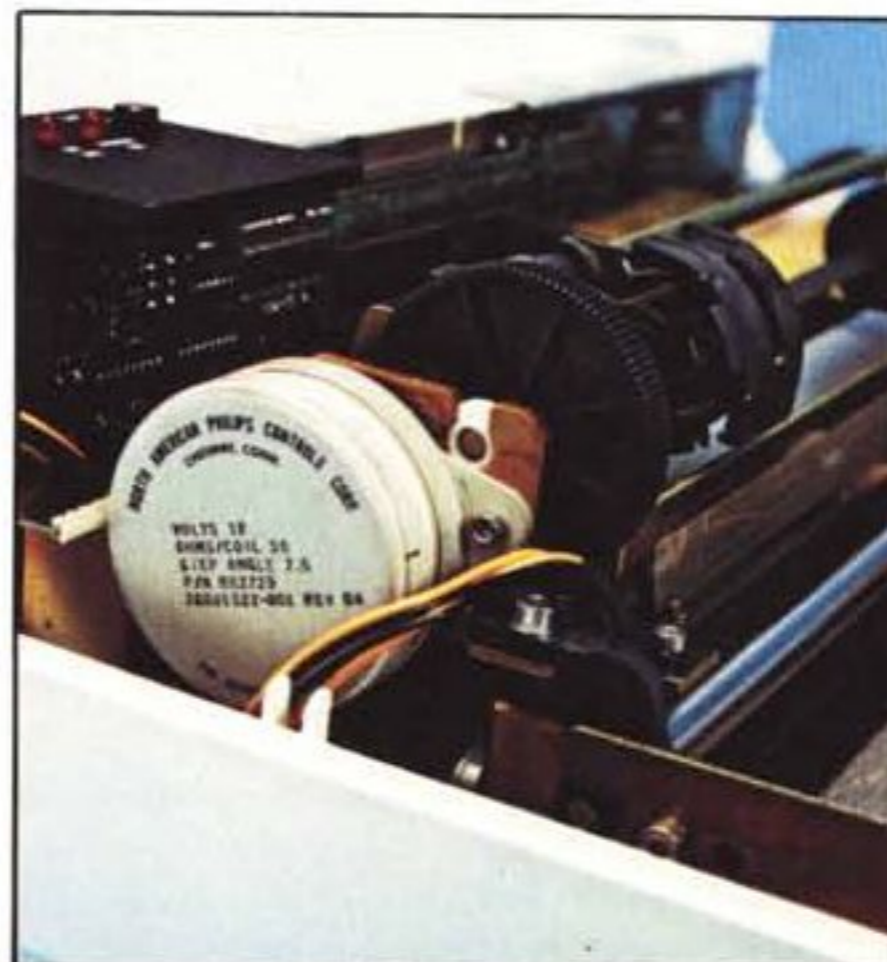
Il grosso motore a passo, costruito dalla Philips americana, il pannellino di controllo e un cingolo. Si vede anche la manopola per l'avanzamento manuale della carta.
