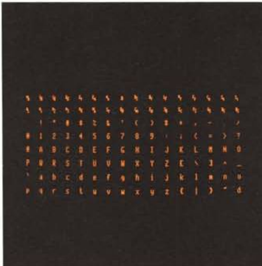
Ecco tutti i 128 caratteri inclusi nello Standard Character Set nella versione 40 caratteri e 80 caratteri per riga. In tutti e due i casi sono formati da una matrice di 5x7 o 5x8 nel caso delle discendenti delle minuscole.
