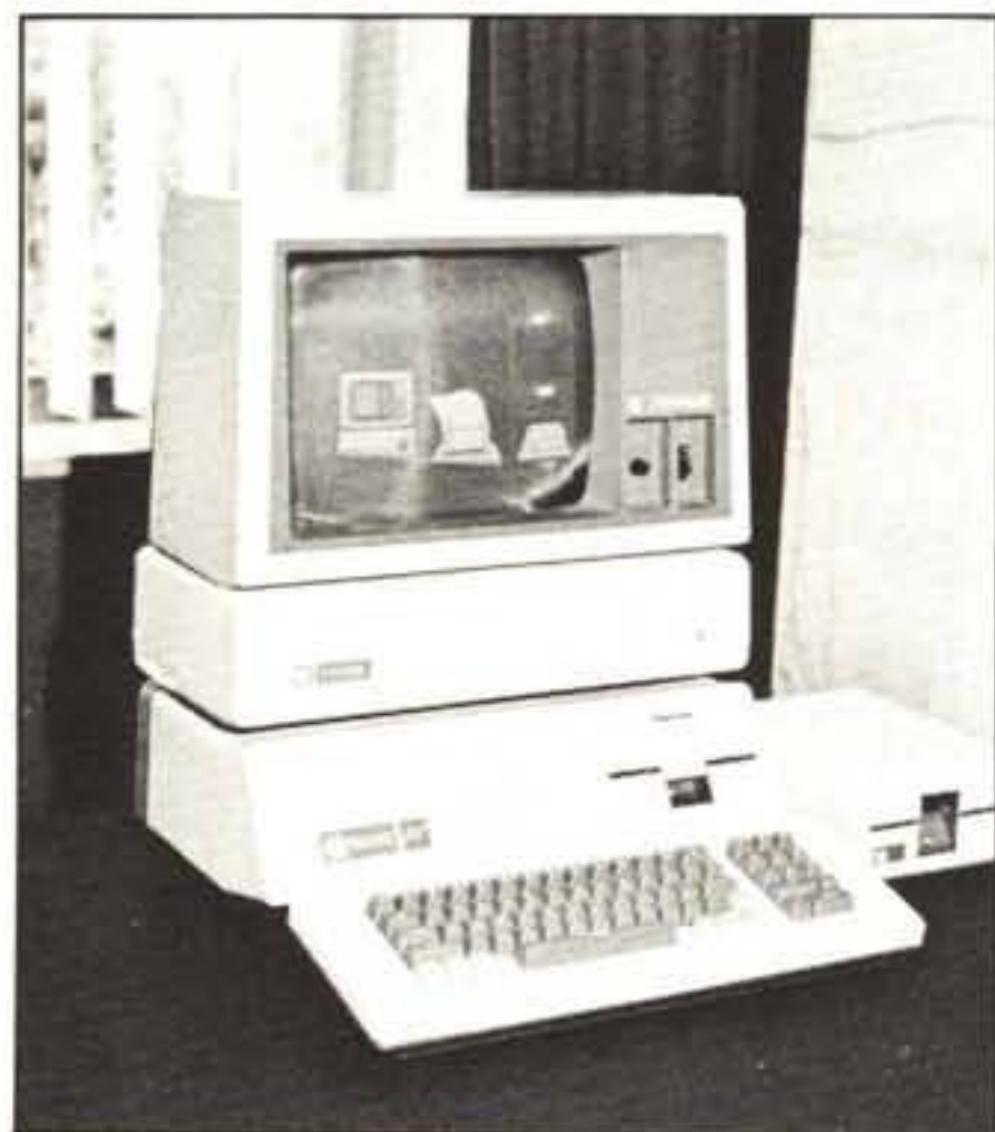
Il contenitore del ProFile, l'unità hard disk da 5 Megabyte, è realizzato in modo da collocarsi fra l'unità centrale e il monitor.
