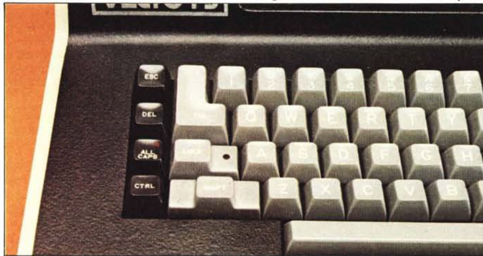
Il Vector è uno tra i computer più compatti e maneggevoli: tastiera dalla forma lievemente concava, video da 12" ed unità centrale si trovano all'interno dello stesso contenitore saldamente fissati ad un telaio in lamiera di alluminio.
