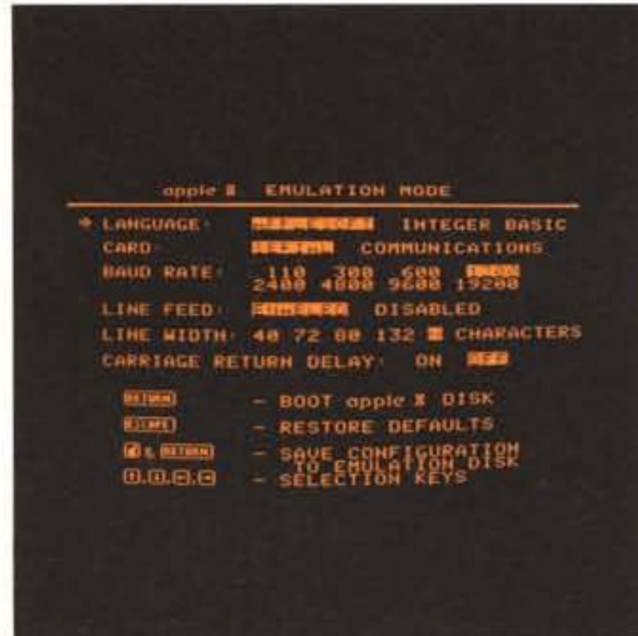
Il menu dell'Apple II Emulator permette la scelta tra Applesoft o Integer BASIC, scheda Seriale o Communication, BAUD rate e larghezza di stampa.
