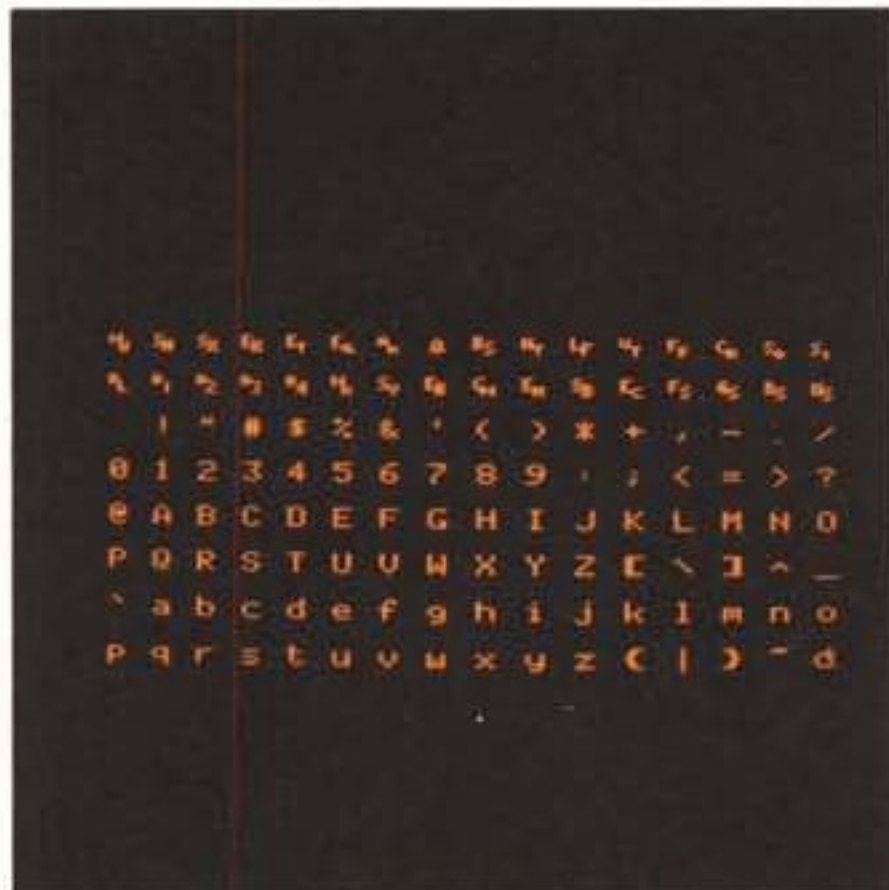
Ecco tutti i 128 caratteri inclusi nello Standard Character Set nella versione 40 caratteri e 80 caratteri per riga. In tutti e due i casi sono formati da una matrice di 5x7 o 5x8 nel caso delle discendenti delle minuscole.
