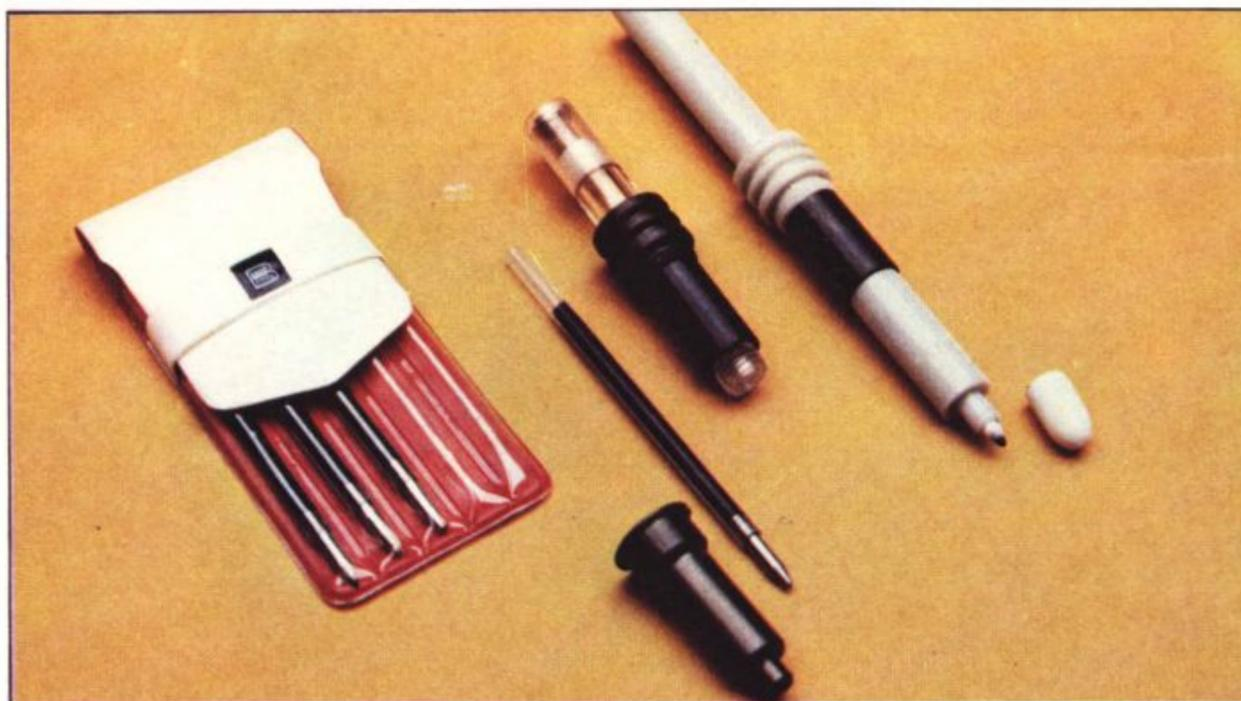
Come si può notare, oltre ai consueti pennarelli con punta in fibra, soggetti a deteriorarsi rapidamente, il Watanabe può usare anche delle penne a sfera: il "refill" si inserisce in un corpo appositamente previsto per questa utilizzazione. Il posizionamento delle penne negli alloggiamenti del magazzino, entro due lamine metalliche sagomate, è facilitato, almeno per le prime volte, da una chiara etichetta adesiva.
