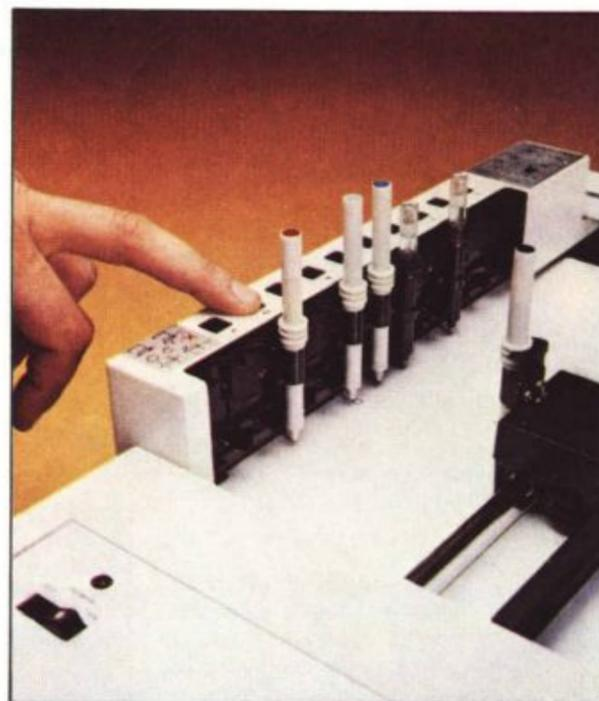
È possibile in ogni momento cambiare penna, non solo per via software, ma anche manualmente premendo il pulsante relativo alla "postazione" desiderata; il braccio depositerà docilmente la penna in uso nella locazione da dove era stata prelevata e un attimo dopo continuerà il disegno con la penna "nuova" esattamente dal punto ove era stato interrotto.
