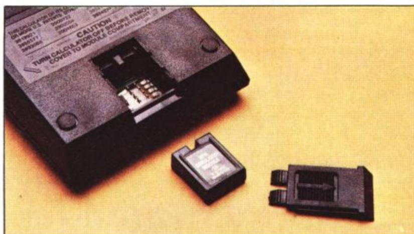
Foto 2 - L'interno del modulino è costituito da una "semplice" ROM.
