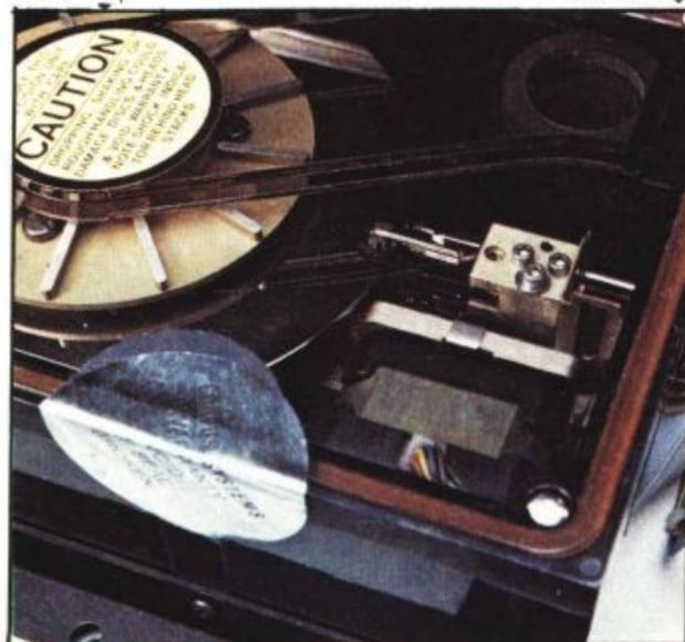
Foto 6. Particolare delle quattro testine Winchester.
