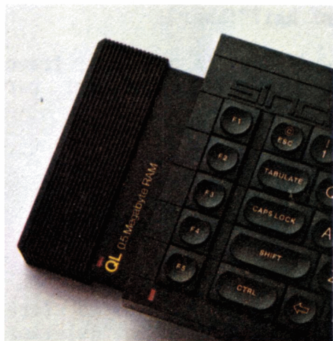
L'espansione di memoria viene effettuata tramite l'apposita cartuccia che eleva la capacità da 128 K a 640 K.
