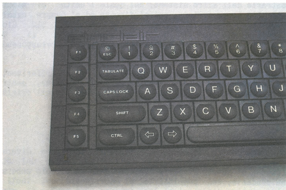
Particolare del lato sinistro della tastiera a membrana. Un lieve "click" denuncia la battitura del carattere evitando di consultare continuamente il video.
