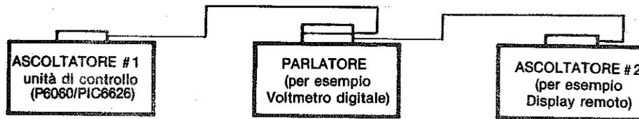
Figura 6-3 Sistema con una unità di controllo
