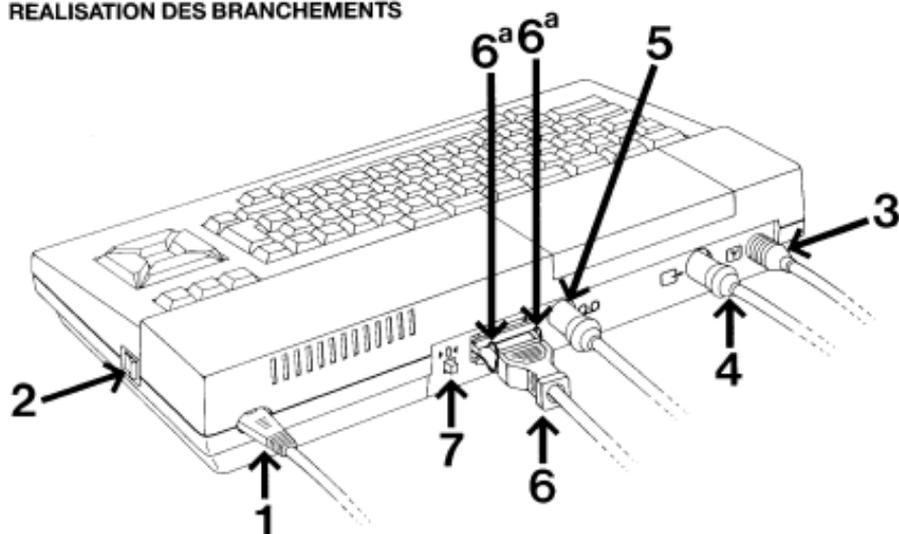
Les prises de connexion sont situées pour la plupart à l'arrière de votre appareil:
