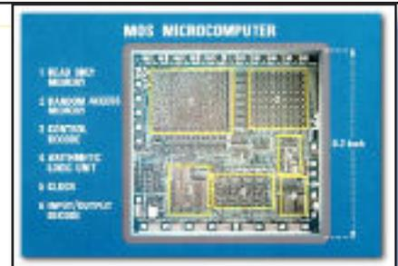
Il microprocessore TMS1000 che è considerato il primo microcomputer on-chip.
