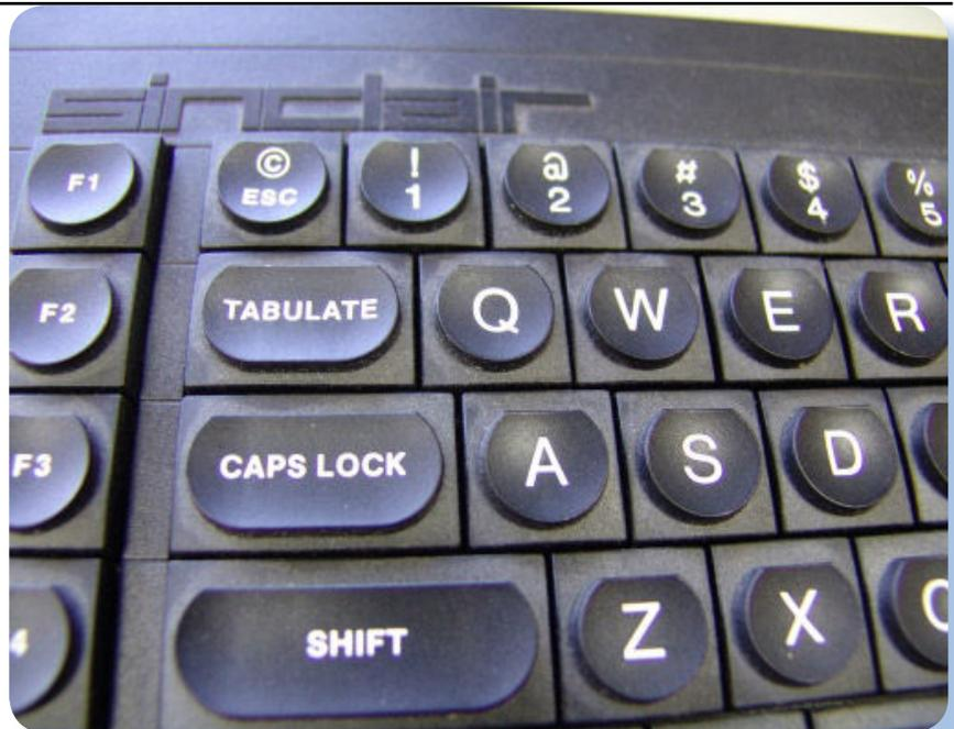
La tastiera, meccanicamente costituita da una membrana conduttiva, è organizzata come matrice 8x8 che viene scansionata dall'8049 periodicamente basandosi sul programma predisposto internamente. Il micro "ricorda" i tasti premuti e quindi il sistema è dotato di un buffer di tastiera.
