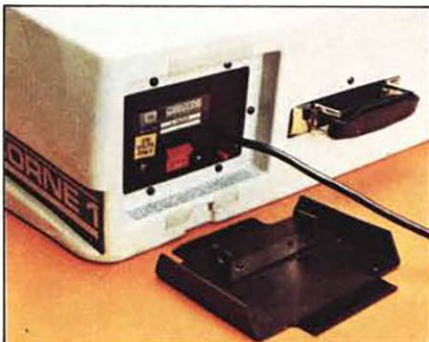
Nel piccolo vano sul retro trovano posto l'interruttore, il pulsante di ripristino dell'alimentazione e, durante il trasporto, il cordone arrotolato.
